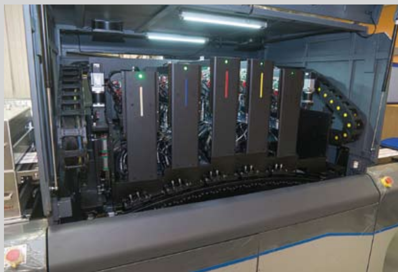
Новое приобретение «Альянс» — цифровая струйная печатная машина AroJet INEM-K-220. Слева: блок головок печатной машины и узлы подготовки полотна к печати (модуль выравнивания полотна, модуль обработки коронным разрядом и модуль двусторонней очистки полотна от пыли)
