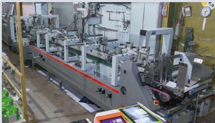
Комплекс оборудования для фальцесклейки недавно пополнился новой фальцевально-склеивающей линией МК1 000FB II компании Masterwork (фото справа)
