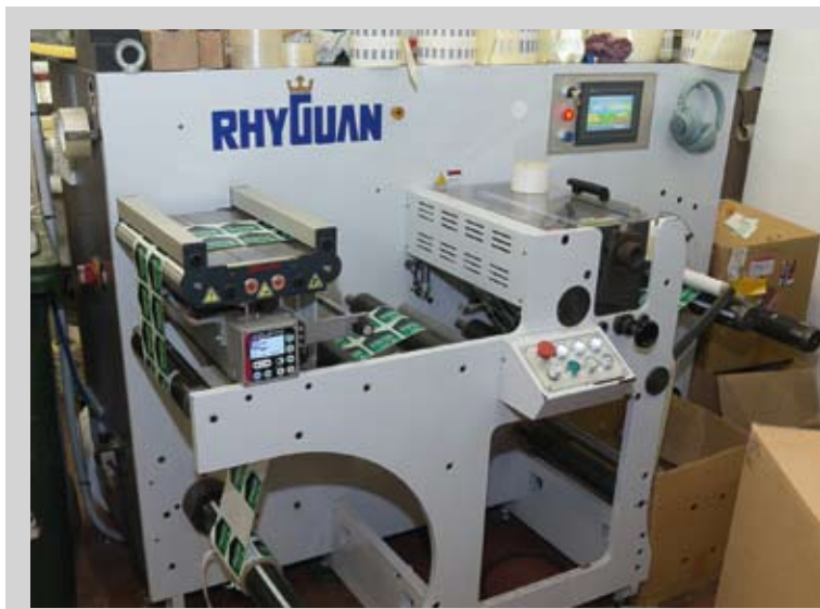
Слева устройство для перемотки и продольной резки полотна. Для высечки на флексографских машинах «Альянс» использует гибкие штампы отечественного производства
