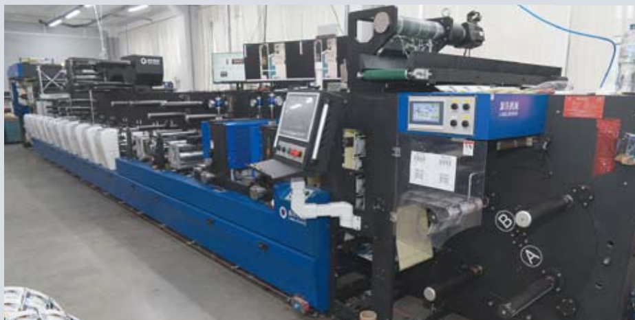
Приобретенная в прошлом году автоматизированная флексографская машина компании Label Source оснащена системой автоматической склейки полотна, что позволяет более эффективно печатать средние и длинные тиражи.
