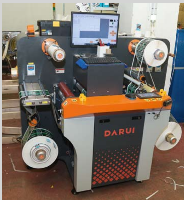
В дополнение к цифровой печатной машине было приобретено цифровое оборудование для механической высечки и удаления обоя Darui D-S7 с тремя флюгерными ножами
