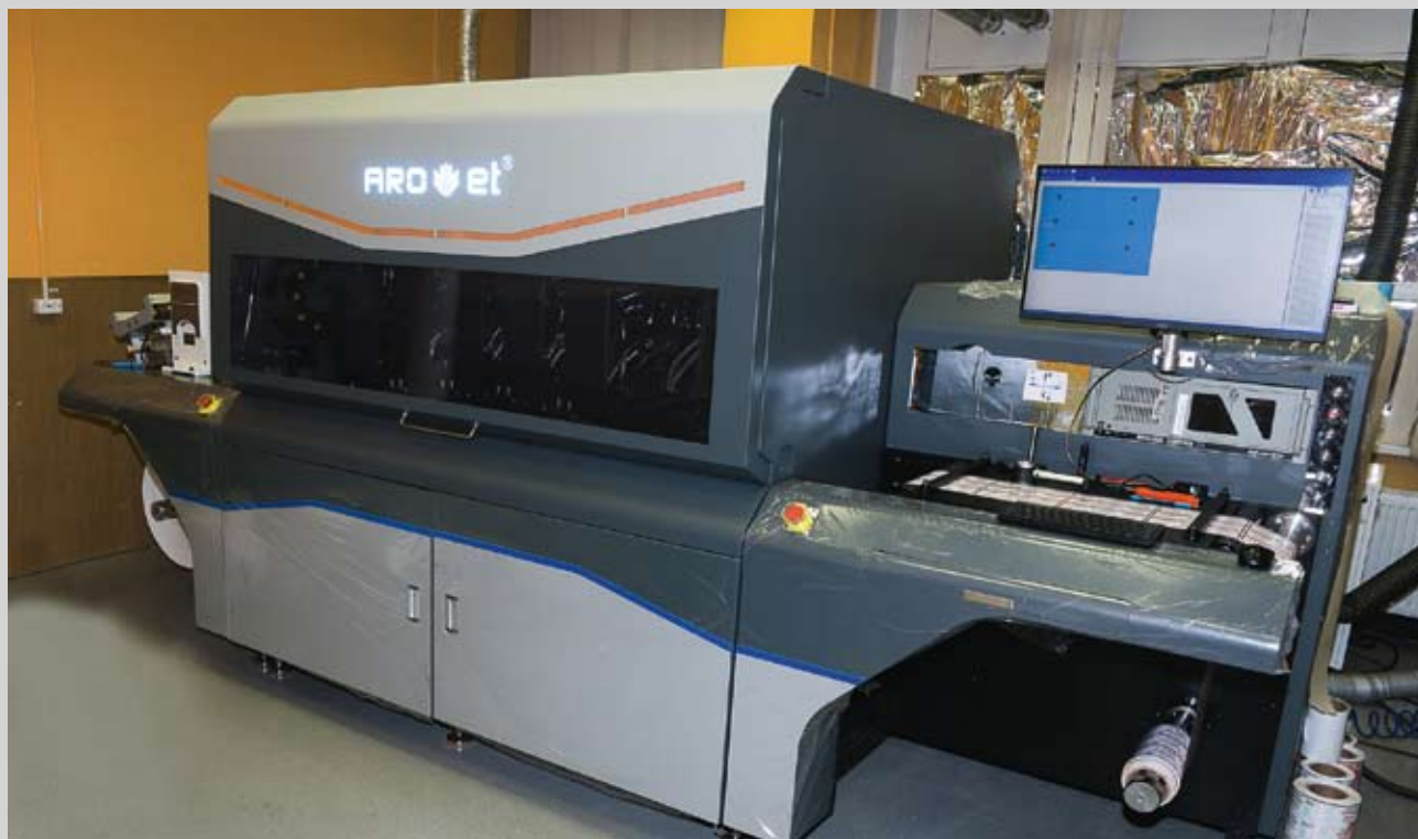
Новое приобретение «Альянс» — цифровая струйная печатная машина AroJet INEM-K-220. Слева: блок головок печатной машины и узлы подготовки полотна к печати (модуль выравнивания полотна, модуль обработки коронным разрядом и модуль двусторонней очистки полотна от пыли)
