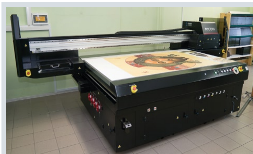
В фотолаборатории ХПП «Софрино» в этом году был установлен широкоформатный планшетный УФ-принтер Ricoh PRO TF6250 с возможностью печати как СМΥК, так и нанесения белил и прозрачного тонера. Оборудование позволяет печатать репродукции рукописных икон на различных материалах — холсте, фотобумаге, пластике, дереве или стекле — толщиной до 11 см и максимальной шириной полотна 2510x1308 мм
