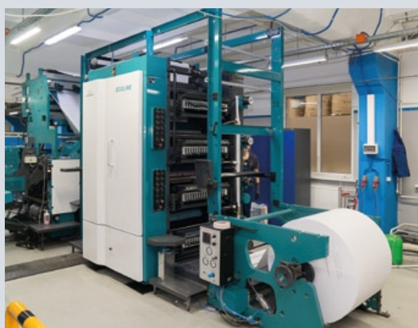
Для печати книжной продукции московская типография «Красная Звезда» приобрела новую рулонную машину Ecoline компании Manupgraph. Она оснащена книжной рубкой и дополнительным фальцевальным аппаратом
