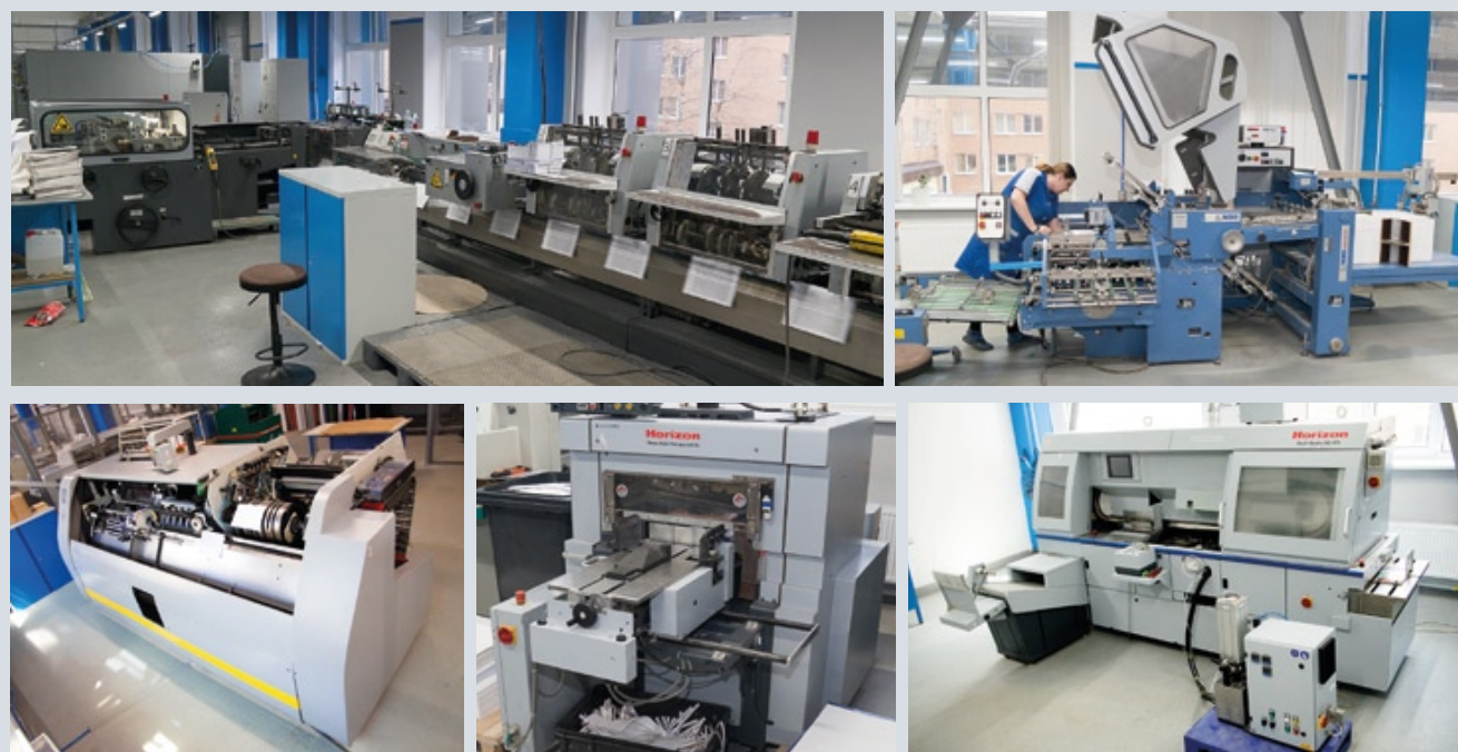
Часть комплекса послепечатного оборудования для производства многополосной продукции (ВШРА, фальцевальная машина, машина для шитья блоков нитками, устройство трехсторонней обрезки, машина КБС)
