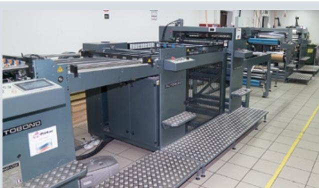
Оборудование для горячего ламинирования используется для ламинации обложек фотокниг, а также другой фотопродукции
