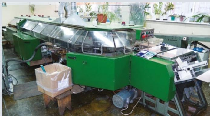
Для производства книг в твердом переплете смонтировано профессиональное оборудование Kolbus: линия для обработки и вставки книжных блоков, крышкоделательная машина, а также линия клеевого-бесшвейного скрепления
