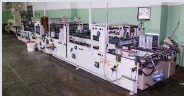
Для работы с картоном производственный парк типографии пополнился кашировальной машиной и фальцевально-склеивающей линией
