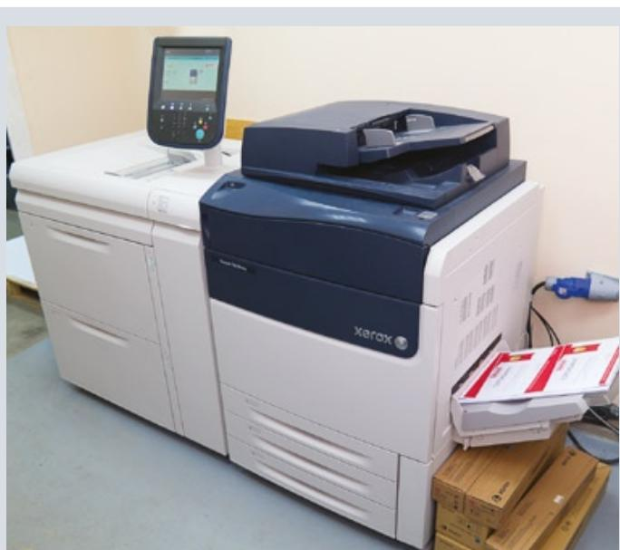
В этом году в типографии Helen полностью модернизировали цифровой печатный парк, установив две машины Xerox — Versant 80 Press и Versant 180 Press, который оснащен вместительным лотком для бумаги и более совершенной системой приводки лица и оборота отпечатка. Наличие двух однотипных машин снижает риск остановки печатного процесса
