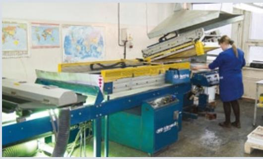
Для обработки и декоративной отделки переплетных крышек применяется восстановленная машина для тиснения Kolbus, ламинатор, трафаретная линия для нанесения изображений на покровный материал и другое оборудование
