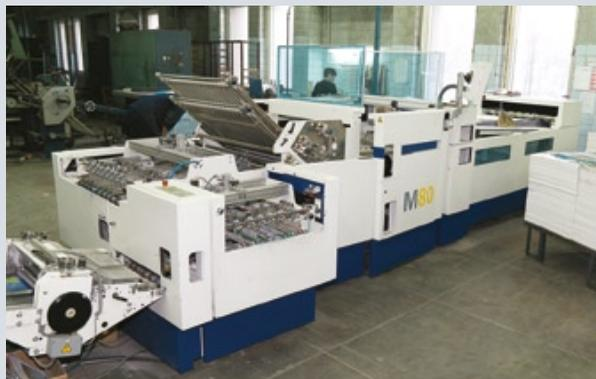
В «Доме Печати – Вятка» установлено оборудование для размотки рулонов (вверху), которое используется для нарезки листов под формат печати на машинах KBA Rapida 130. После запечатки листы разрезаются пополам для фальцовки на автоматизированной линии MBO M80
