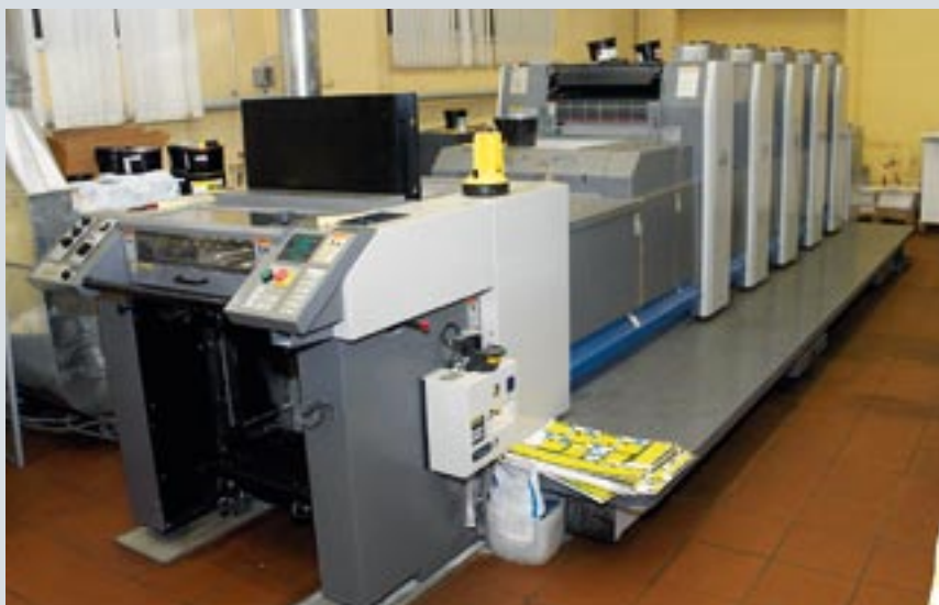
Новая печатная машина — RYOB GX525 — приобретена в Европе в очень хорошем состоянии и самой полной конфигурации. Уже в России она была доработана для печати высокореактивными УФ-красками
