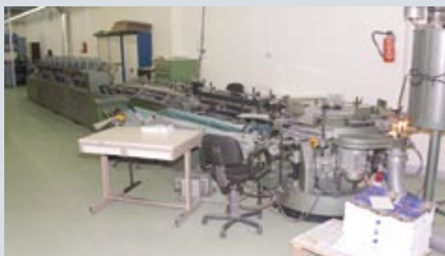
Вкладочно-швейно-резальный агрегат (слева) и линия бесшвейного скрепления (справа) производства компании Muller Martini установлены еще в момент создания типографии, но по-прежнему работают надежно и обеспечивают стабильное качество
