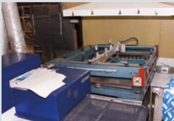
Для изготовления стикеров (например, двусторонних) в типографии применяется трафаретная печать
