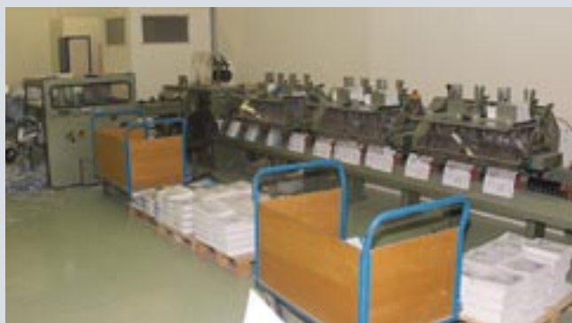
Вкладочно-швейно-резальный агрегат (слева) и линия бесшвейного скрепления (справа) производства компании Muller Martini установлены еще в момент создания типографии, но по-прежнему работают надежно и обеспечивают стабильное качество
