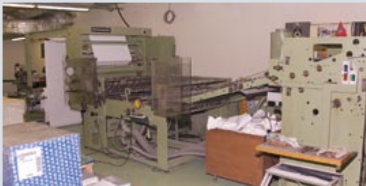
Наличие собственного комплекса оборудования для нарезки рулонной бумаги на листы нужного размера позволяет существенно экономить, нарезая для каждого тиража листы минимально необходимого размера, таким образом, в обрезки уходит минимум бумаги
