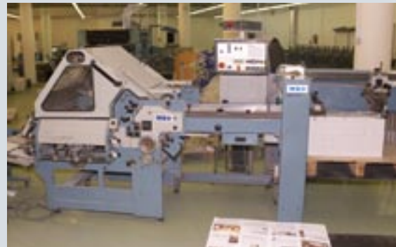
Вкладочно-швейно-резальный агрегат (слева) и линия бесшвейного скрепления (справа) производства компании Muller Martini установлены еще в момент создания типографии, но по-прежнему работают надежно и обеспечивают стабильное качество
