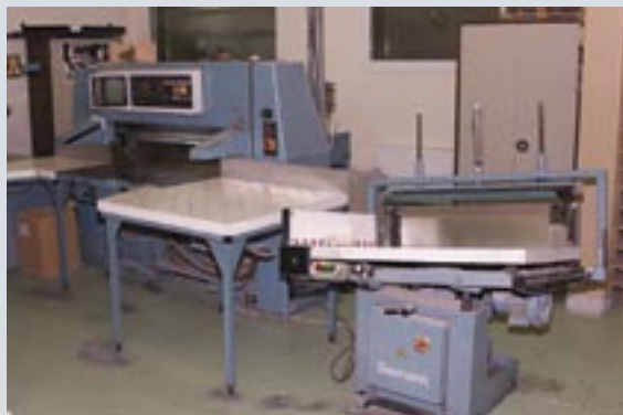
В момент создания типографии в ней было установлено множество единиц оборудования ведущих мировых производителей, например, фальцевальная машина в типографии производства компании MBO, а резальный комплекс с вибростолом — Wohlenberg-Baumann
