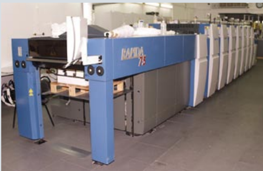
Основные заказы в компании АЛИОТ сейчас печатают на шестикрасочной KBA Rapida 75 с секцией лакирования
