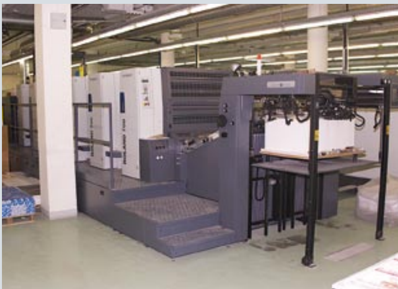
Появление в типографии «Офсет Принт» новой пятикрасочной печатной машины manroland 705 HiPrint позволило существенно увеличить и производительность работы, и качество продукции
