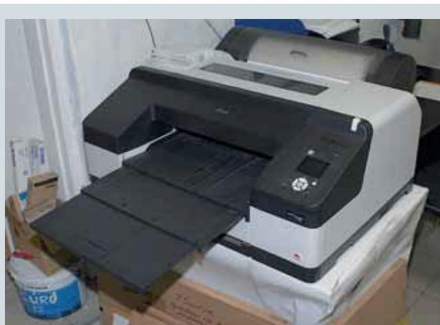
Для вывода цифровой цветопробы в репроцентре используют устройство Epson Stylus Pro 4900. Цветопробный комплекс объединен с участком вывода CtP-форм посредством одного и того же ПО — Agfa Apogee Prepress
