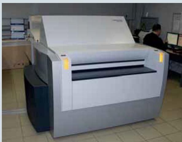
Для всех офсетных печатных машин формы изготавливаются цифровым способом на выводных устройствах Heidelberg Suprasetter
