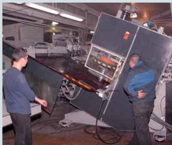
Специализированный вырубной пресс вырубает одним штампом заготовки конвертов из стопы отпечатанных листов, на которых размещаются сразу несколько изделий
