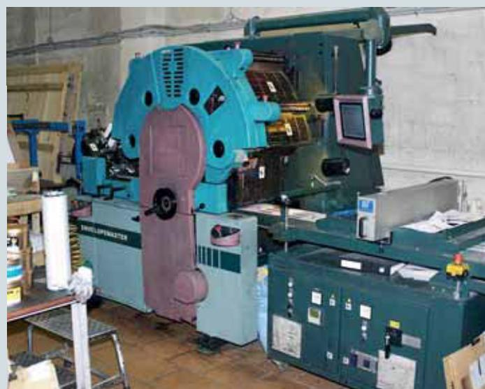
Машины для печати на готовых конвертах, в том числе для УФ-печати (внизу), что позволяет использовать для изготовления конвертов различные материалы (полимеры, металлизированные и дизайнерские бумаги)
