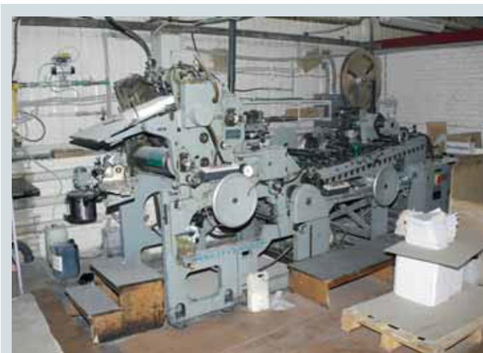
Машина для формирования и склейки конвертов из заранее высеченных заготовок. Позволяет собирать конверты и пакеты самых разных типов и размеров
