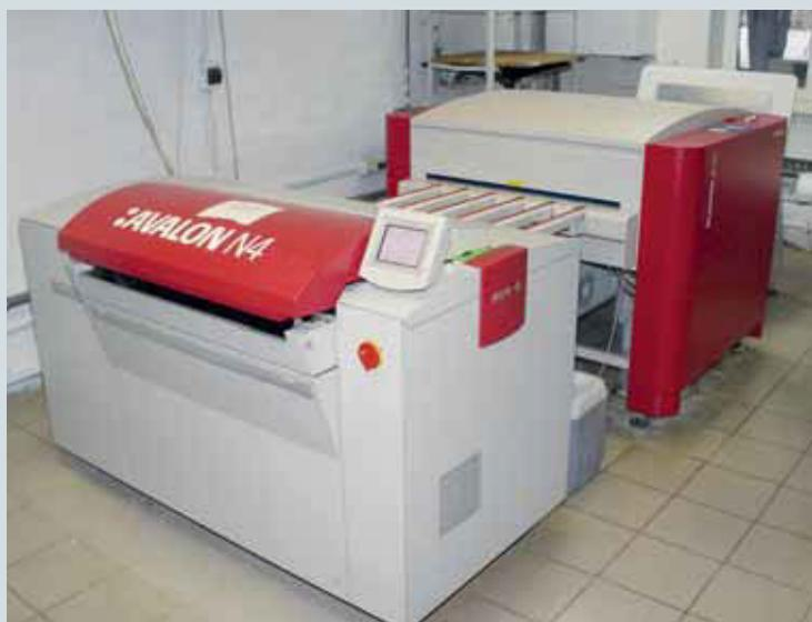
Линия для экспонирования цифровых пластин Agfa Avalon N4 стала первым устройством, поставленным компанией «МакЦентр» в репроцентр «24PrePress». Сегодня здесь работают три подобных устройства
