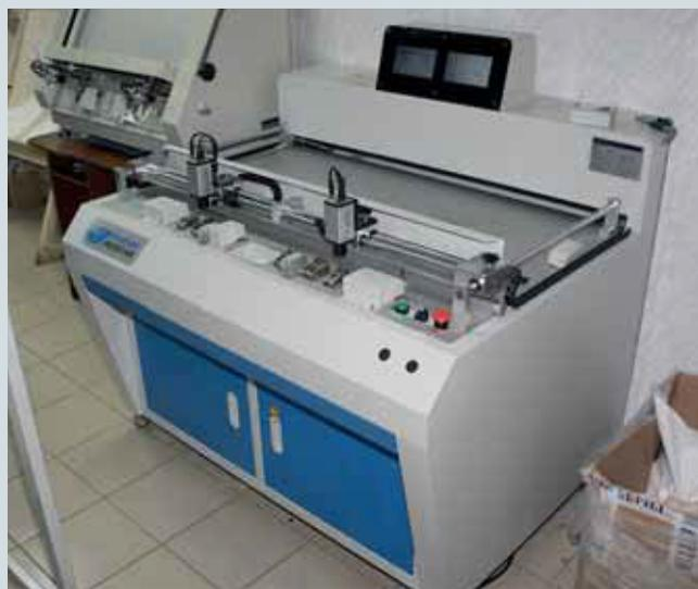
Автоматическая система пробивки приводочных отверстий позволяет получать пластины на CtP-устройстве Amsky, готовые к монтажу на цилиндры печатной машины
