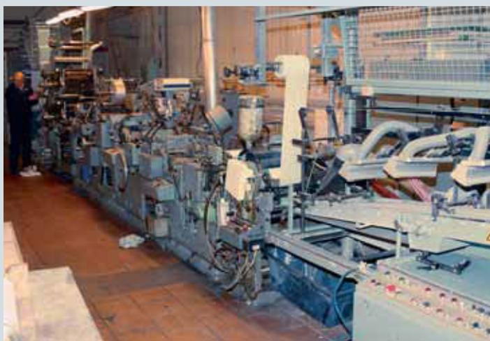
Специализированная конвертоделательная машина позволяет из рулона бумаги получить готовый конверт, включая печать изображений флексографским способом, высечку, склейку, нанесение клеевой (или силиконовой) полосы и т. д.
