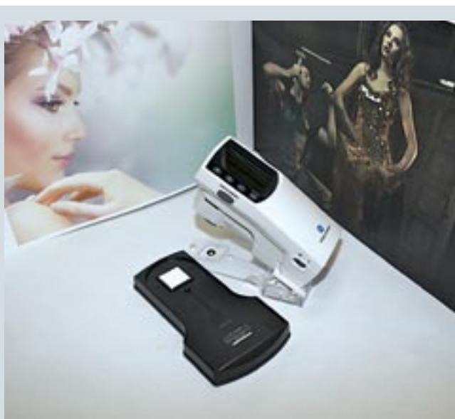
Новый измерительный прибор от Konica Minolta позволяет проводить целый комплекс работ по линейаризации и настройке цифровых печатных машин, построению профилей и проведению при необходимости различных разовых измерений, в том числе и для офсетных оттисков
