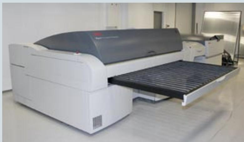
Новое широкоформатное устройство прямого экспонирования формных пластин Kodak Magnus VLF легко заменил два выводных устройства, используемых ранее, хотя одно из них по-прежнему в работе в резервных целях
