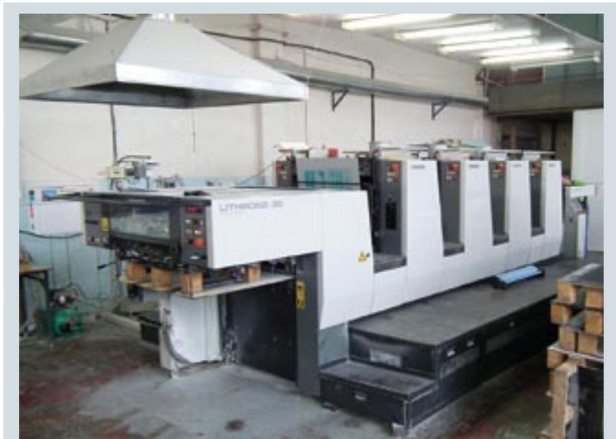
Печатная машина Komori Lithrone 428 в типографии «Зёбра» отпечатала уже более 120 млн отт. При этом ни одной серьезной поломки, мешающей выполнению заказов, в типографии не было
