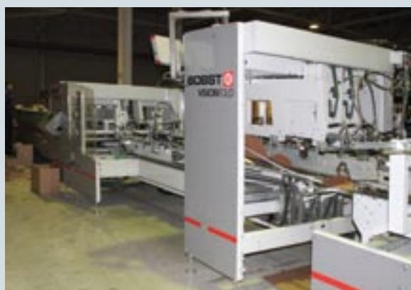
Фальцевально-склеивающее оборудование: Bobst ExpertFold для плотного картона (слева) и Bobst VisionFold для гофрокартона (справа)
