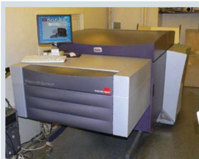
*Kodak Magnus 400 Quantum хорошо справляется с экспонированием беспроцессных пластин Kodak Thermal Direct*
