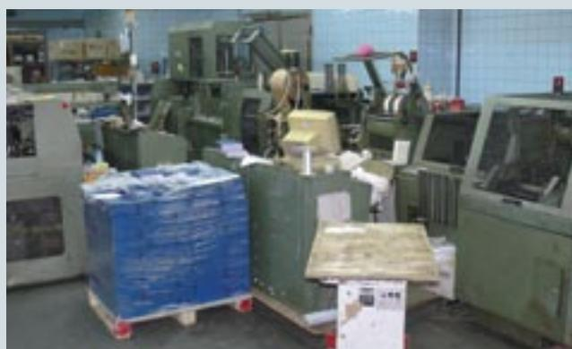
В «Типографии «Новости» успешно эксплуатируется и другое оборудование Kolbus, установленное ранее: линии бесшвейного скрепления и обработки книжных блоков
