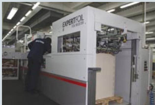
Пресс для вырубki Bobst ExpertCut с системой Power Register (слева) и пресс для тиснения фольгой Bobst ExpertFoil (справа)
