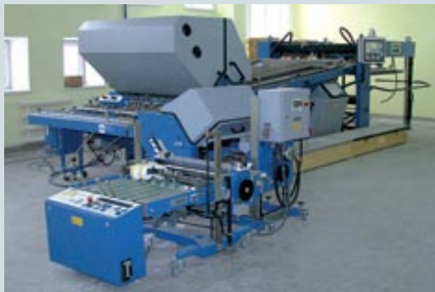
Уникальные фальцевальные машины от компаний MBO и Herzog+Neumann: слева — многокассетная машина с палетным самонакладом Mabeg с максимальным форматом листа 142x165 см, справа — многокассетная машина с дополнительным модулем ножевой фальцовки и круглостапельным самонакладом, максимальный формат листа 76x125 см
