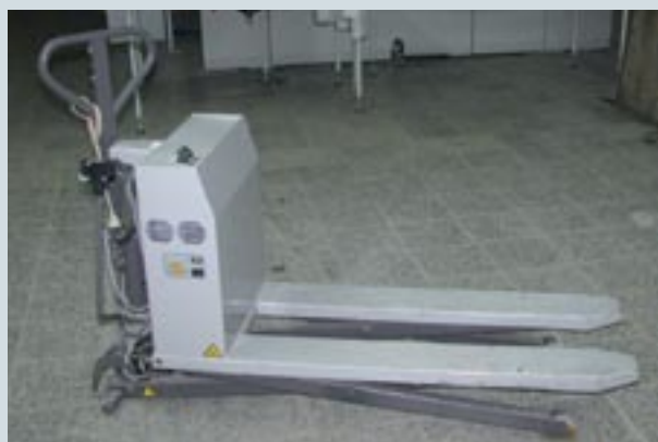
В комплекте оборудования «МТинвест» поставляет даже такие устройства: обычная с виду тележка для перевозки палет бумаги, но с электрическим приводом
