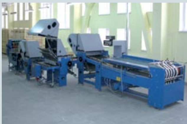
Уникальные фальцевальные машины от компаний MBO и Herzog+Neumann: слева — многокассетная машина с палетным самонакладом Mabeg с максимальным форматом листа 142x165 см, справа — многокассетная машина с дополнительным модулем ножевой фальцовки и круглостапельным самонакладом, максимальный формат листа 76x125 см
