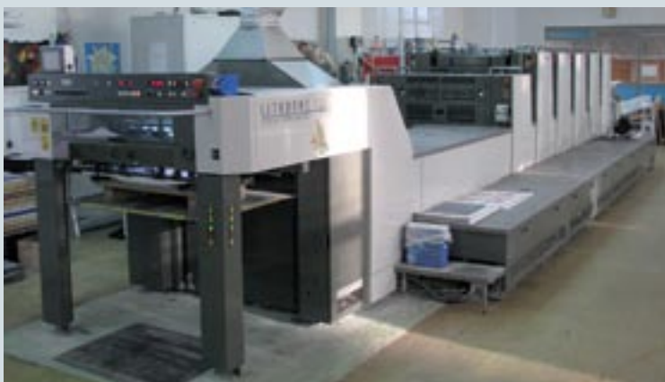
Komori Lithrone S29 в пятикрасочном исполнении с лаковой секцией приобретен сравнительно недавно
