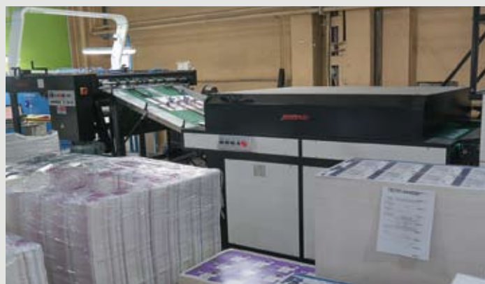
Новое приобретение типографии — уникальная сервоприводная автоматическая трафаретная линия JB-106C с возможностью выполнения нескольких видов отделки: трафарет и лакирование, холодное тиснение фольгой и создание голографического эффекта. Вверху: общий вид линии, далее модуль тиснения и финальная сушка
