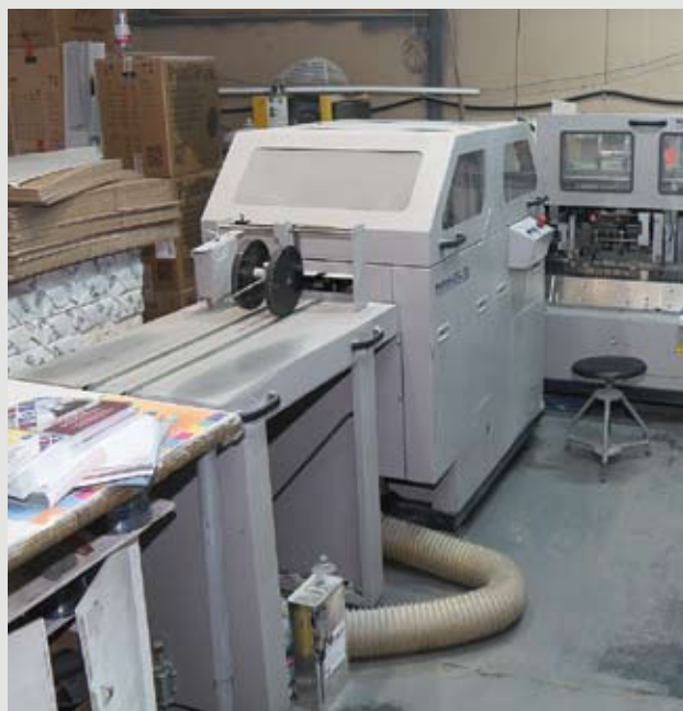
Современная линия для полистного подбора и шитья продукции проволоочными скобами
