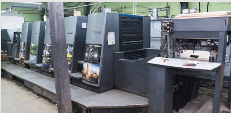
Основой производственного парка «К-Пресс» является пятикрасочная печатная машина Heidelberg Speedmaster CD74 с секцией лакирования
