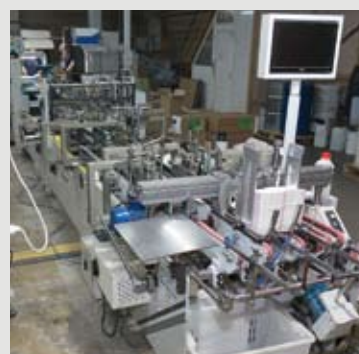
На производстве две фальцевально-склеивающие линии. Одна из них от Masterwork — Diana оснащена системой автоматической упаковки коробок в транспортные короба и доработана для печати кодов системы «Честный Знак» на упаковку
