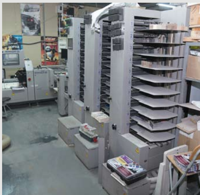
Современная линия для полистного подбора и шитья продукции проволоочными скобами
