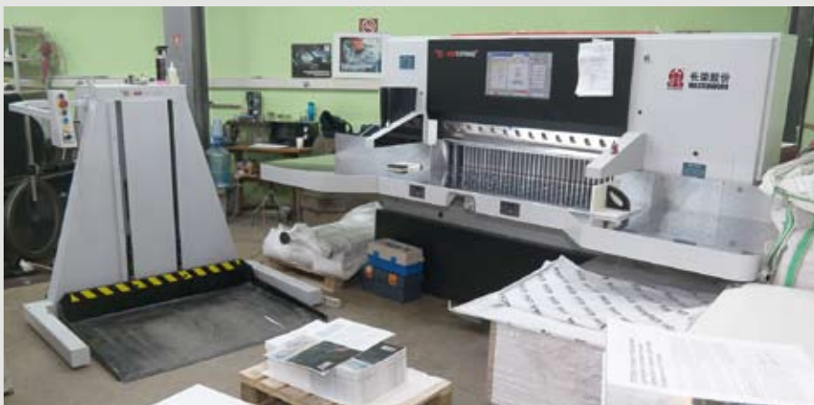
В типографии в дополнение к резальным машинам немецкого производства добавилась резальная машина китайской компании Masterwork со специализированной периферией
