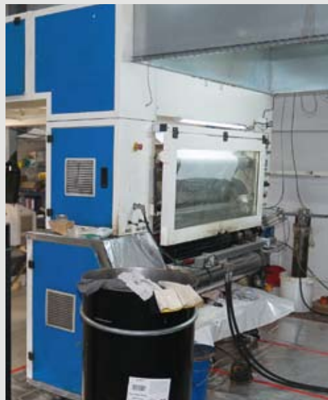
Промышленный клеевой ламинатор с возможностью работы с двухкомпонентными клеями
