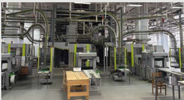
На комбинате есть рулонная печатная машина с системой автоматической транспортировки тетрадей
