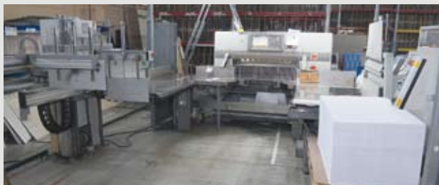
Собственный парк флаторезного оборудования позволяет готовить бумагу оптимального формата для каждого заказа
