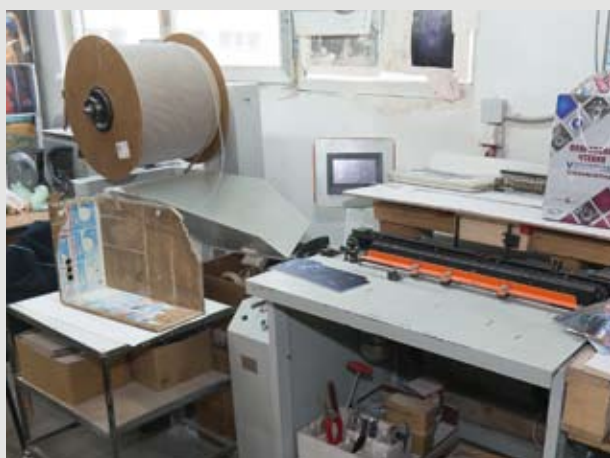
Оборудование для изготовления календарей и скрепления проволоочными спиралями, кашировальная техника — все это типография использует в производстве продукции
