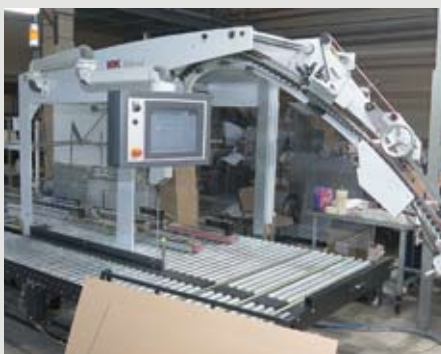
На производстве две фальцевально-склеивающие линии. Одна из них от Masterwork — Diana оснащена системой автоматической упаковки коробок в транспортные короба и доработана для печати кодов системы «Честный Знак» на упаковку
