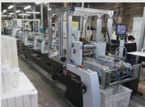
На производстве две фальцевально-склеивающие линии. Одна из них от Masterwork — Diana оснащена системой автоматической упаковки коробок в транспортные короба и доработана для печати кодов системы «Честный Знак» на упаковку
