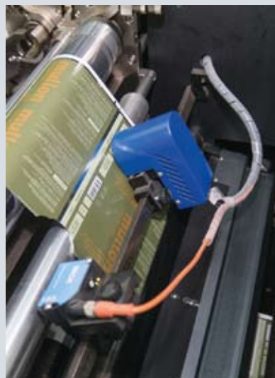
Интересные опции машины Label Source: секция ламинации и холодного тиснения фольгой, камера системы видеоконтроля отрисов, система двойного автоматического контроля приводки
