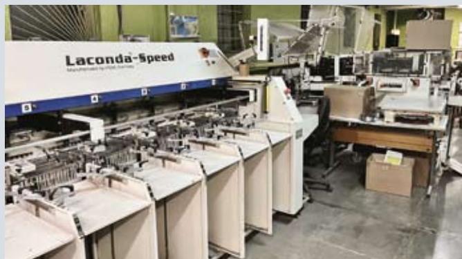
Листоподборочный комплекс из 16 секций с трехсторонней подрезкой
