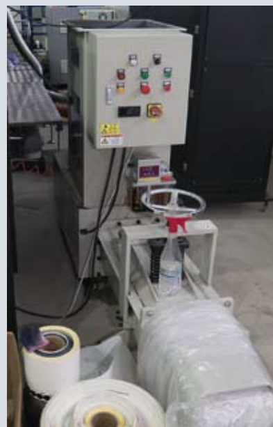
Уникальная опция машины LabelSource: устройство прессования обложки и результат его работы
