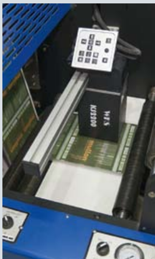
Интересные опции машины Label Source: секция ламинации и холодного тиснения фольгой, камера системы видеоконтроля отрисов, система двойного автоматического контроля приводки
