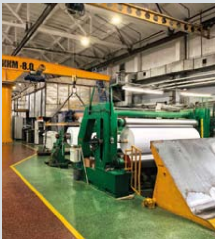
Производство бумаги, центральный пульт управления бумагоделательной машиной и намотка готового мастер-рулона
