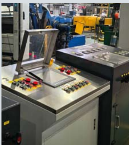
Производство бумаги, центральный пульт управления бумагоделательной машиной и намотка готового мастер-рулона
