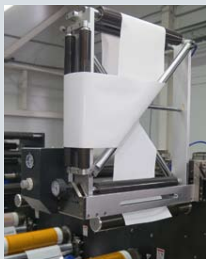
Опции LabelSource: система переворота полотна для печати по обороту или клеевому слою и система обработки полотна коронным разрядом
