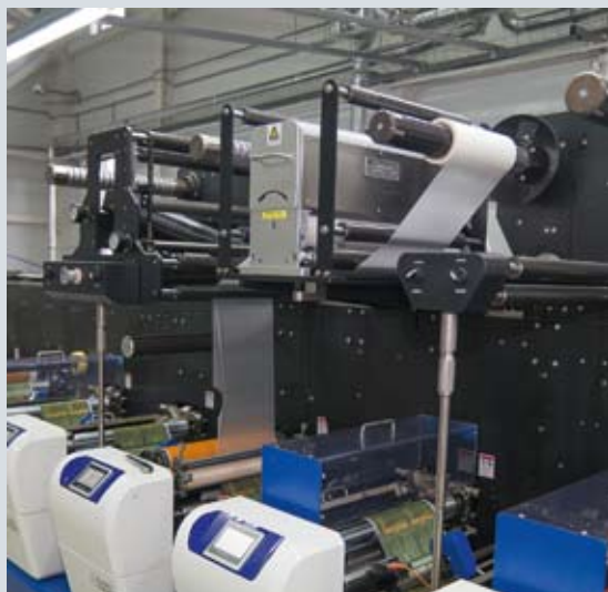
Интересные опции машины Label Source: секция ламинации и холодного тиснения фольгой, камера системы видеоконтроля отрисов, система двойного автоматического контроля приводки
