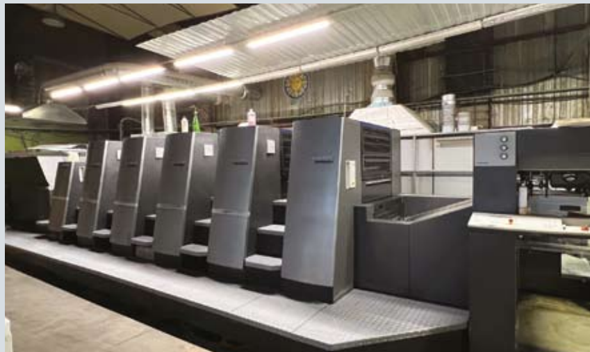
Основа печатного парка типографии — машина Heidelberg Speedmaster CD 74-5+L-C. Вверху: новое приобретение типографии — автоматический пресс для высечки, биговки и конгревного тиснения Ecoscut 106 CS.
