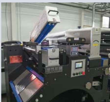
Опции LabelSource: система переворота полотна для печати по обороту или клеевому слою и система обработки полотна коронным разрядом
