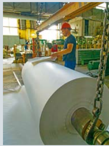
Производство бумаги, центральный пульт управления бумагоделательной машиной и намотка готового мастер-рулона
