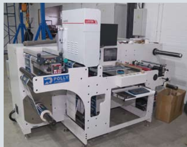
Слева: перемоточная машина, оснащенная видеотестированием Luster LabelERO, справа: перемоточная машина с резкой на ручьи и ротационной высечкой с удалением обложки
