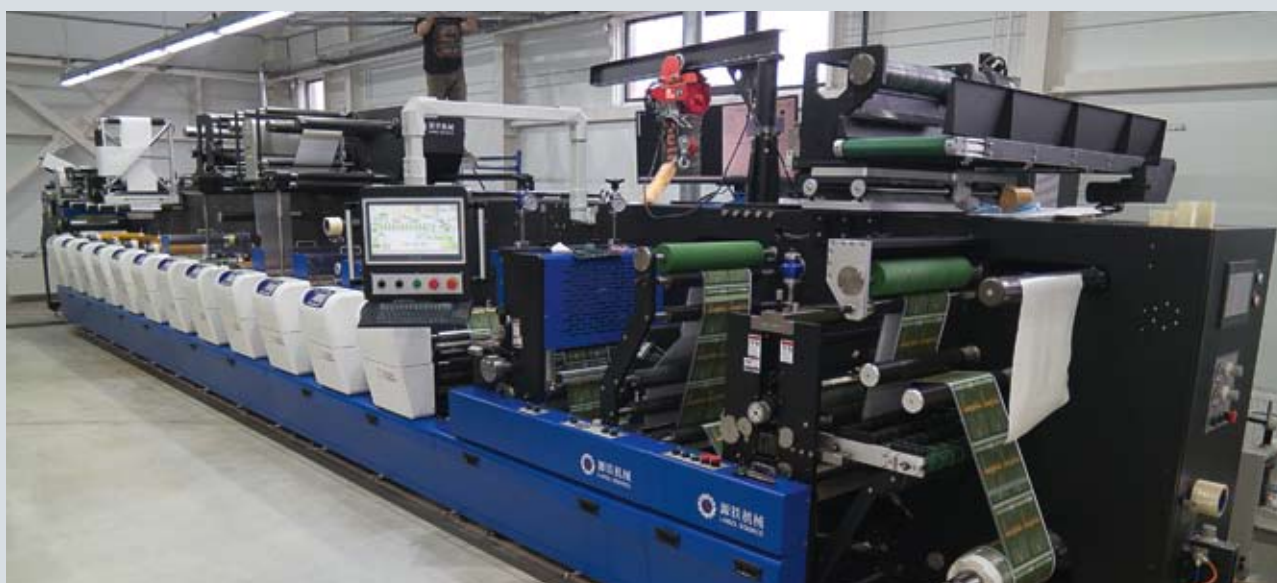
В октябре в типографии «Флексоград» была введена в эксплуатацию 12-красочная флексомашина YTP-F6-460-12C производства китайской компании Label Source с увеличенной шириной полотна — 460 мм
