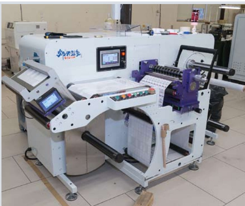
Слева — предыдущая, справа — новая бобинорезки для роспуска полотна на отдельные ручки
