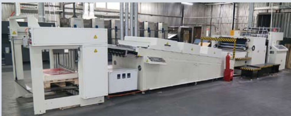
Промышленная лакировальная машина SimSun Alpha-104 может осуществлять сплошное и выборочное лакирование
