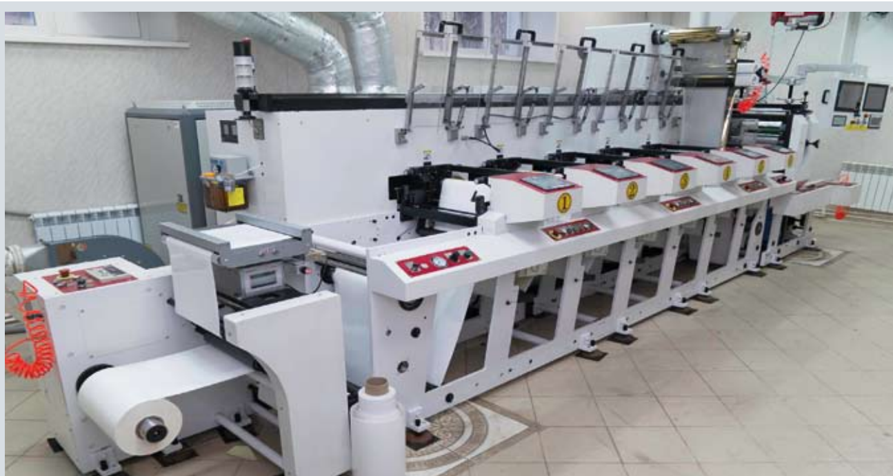
Новая 6-красочная ускоренная сервоприводная флексографская машина Donghang DHFP 350 установлена «Терра Принт»
