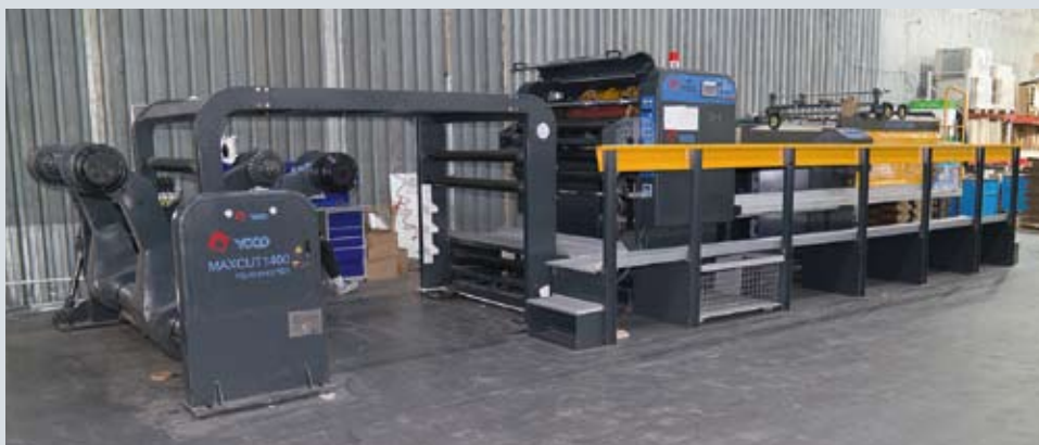
Флаторезная машина Yoco MaxCut 1400 используется для распуска рулонов бумаги и картона на форматы, нужные для конкретного заказа
