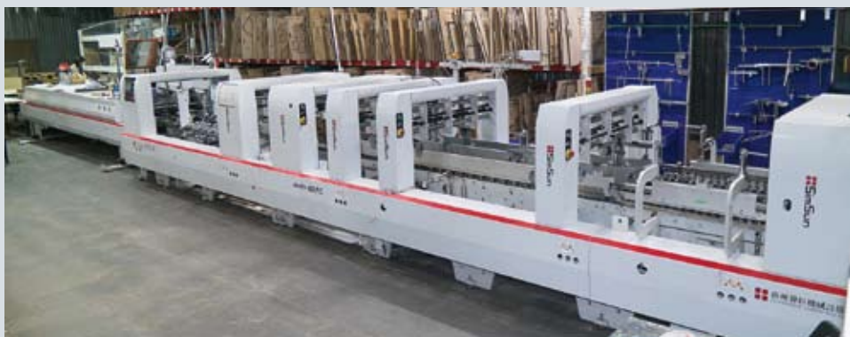
Фальцевально-склеивающая машина SimSun успешно работает и с плотным кратноном, и с гофрокартоном, но коробки должны быть относительно небольшого размера
