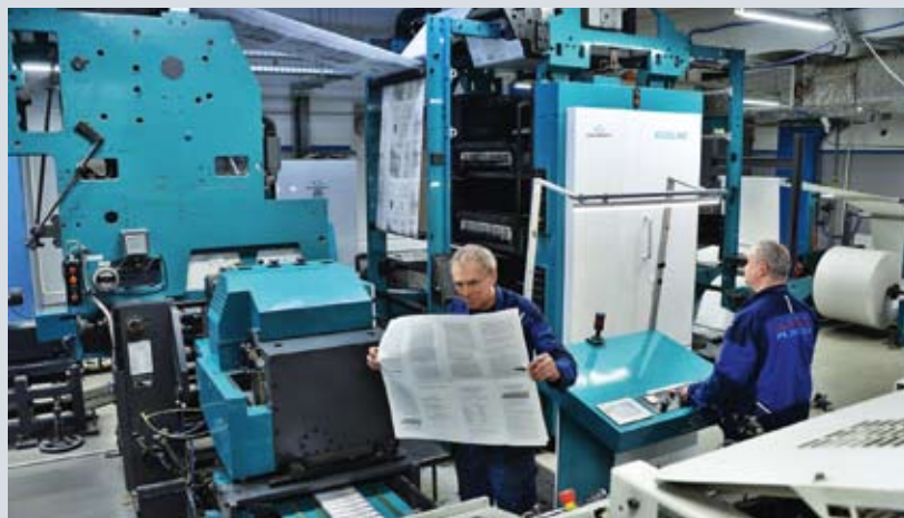
Для печати книжной продукции «Красная Звезда» приобрела новую рулонную машину Ecoline компании Manugraph. Она оснащена книжной рубкой и дополнительным фальцем. Недавно на эту машину установили УФ-сушку, что позволило печатать на легкомелованных бумагах
