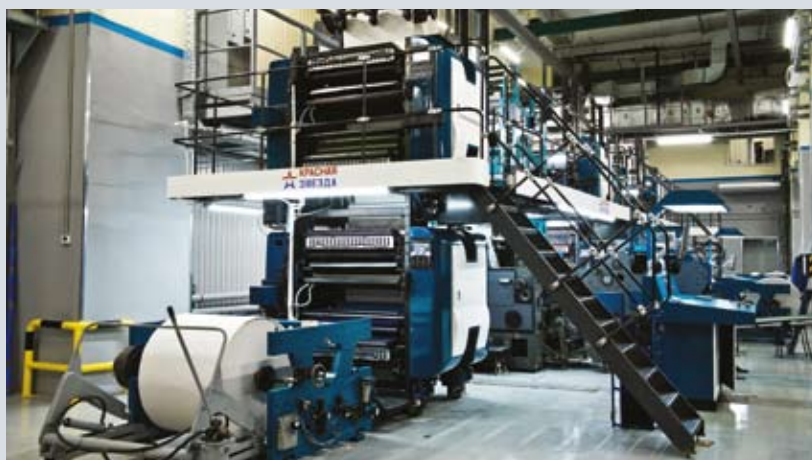
Для печати газеты «Красная Звезда» и других в типографии установлена печатная машина CityLine Express компании Manugraph
