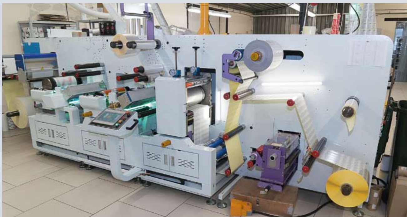
Финишно-отделочная линия Vision MDF 330 поставлена в уже ставшей стандартной конфигурации: корона, полуротационная флексо секция, холодное тиснение/ламинация, полуротационная высечка, намотка облож, резка в ручьи
