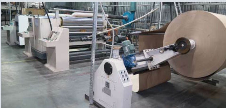
Собственный гофроагрегат позволяет типографии производить нужные объемы гофрокартона, в том числе тонкого микрогофрокартона с волной типа Е и F. Он используется для кашированной гофроупаковки
