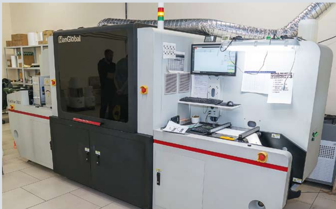
Новое приобретение типографии — этикеточная цифровая струйная печатная машина HanGlobal LabStar 330S. Имеет конфигурацию СМΥК WW, то есть с двойными цифровыми белилами
