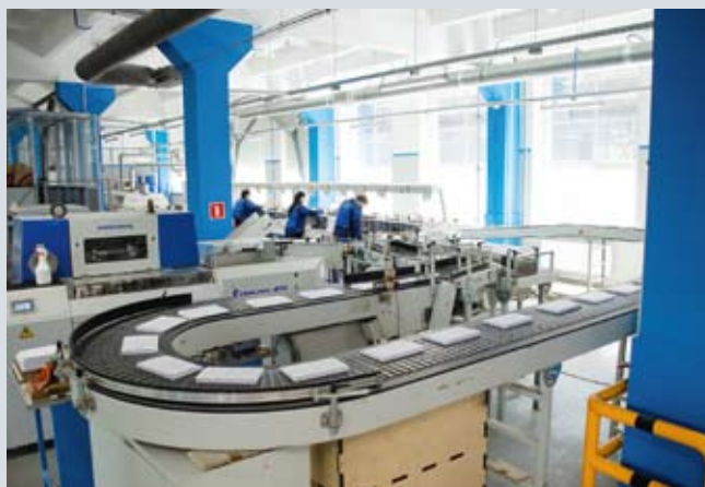
Недавнее приобретение типографии «Красная Звезда» — линия бесшвейного скрепления Wohlernderg City E
