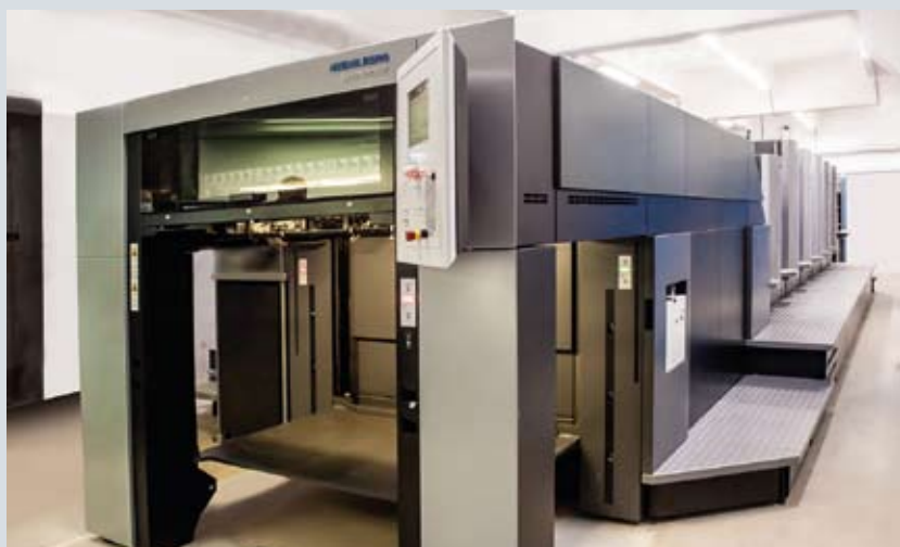
Печатная машина Speedmaster CD 102-5+L стала основой листового офсетного парка типографии «Красная Звезда»
