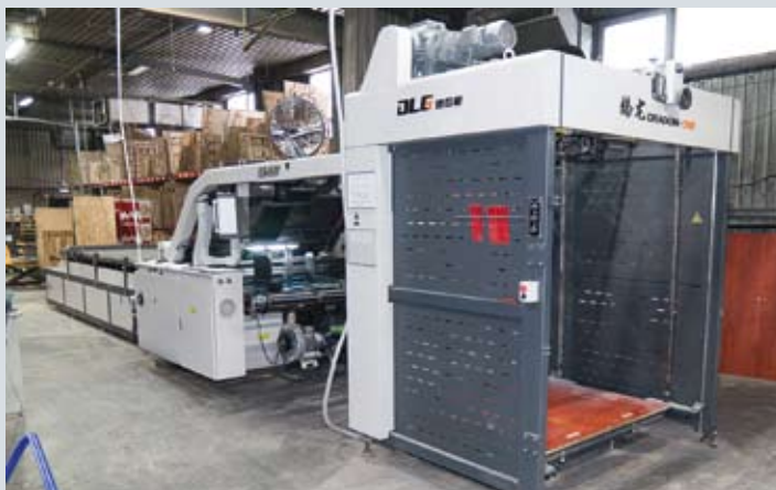
Для автоматизации производства гофроупаковки установлена лакировальная машина DLG Dragon One (слева) и пресс для высечки Nikko. Все оборудование на фото на этой странице поставлено специалистами компании «Т-Системы»
