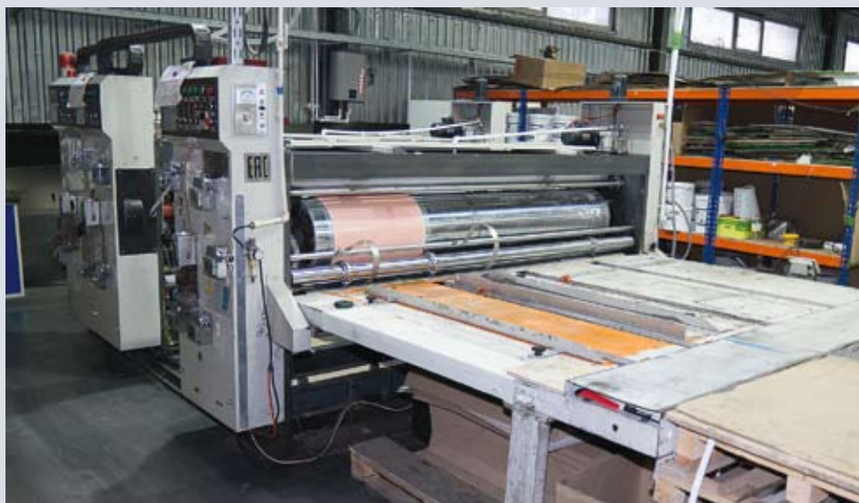
Двухкрасочная флексографская печатная машина используется для изготовления брендированной гофротары, в том числе крупноформатной
