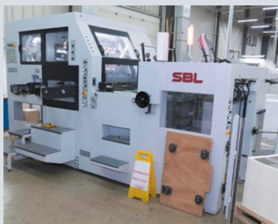
Одно из недавних приобретений «Парето-Принт»: пресс для тиснения фольгой по листам обложечного материала. Это второй пресс этого производителя, первый уже успешно работает несколько лет
