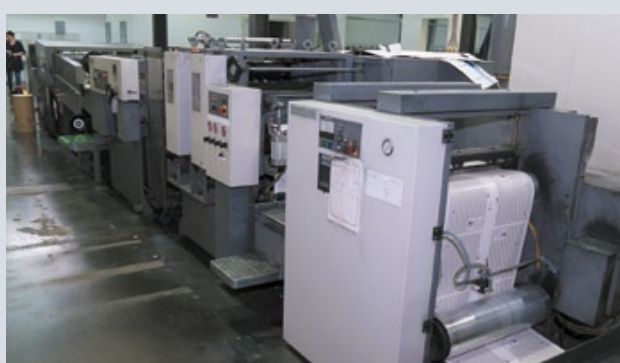
В линию с печатной машиной установлена система ротационной высечки и биговки
