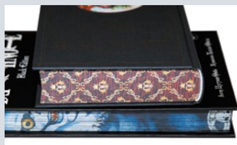
Примеры некоторых уникальных технологий типографии «Парето-Принт»: возможность изготавливать книжные блоки толщиной более 8 см, и наносить красочные изображения на обрезы блока
