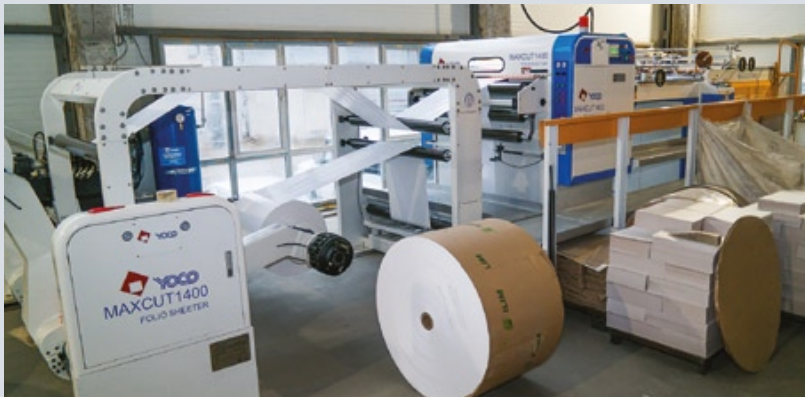
Машина MaxCut 1400 компании Yoso обеспечивает размотку рулонов бумаги и картона на листы нужного формата
