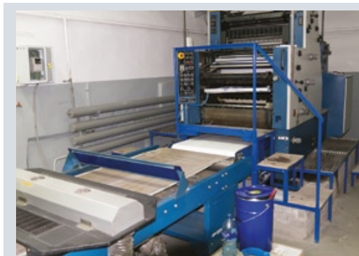
Историческая машина KBA Rapida 72K теперь переделана в УФ-лакировальную машину
