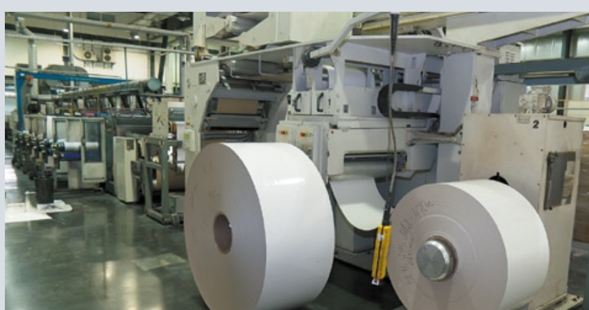
Печатный парк типографии «Роспак» состоит из шестикрасочной рулонной печатной машины Komori Chambon, использующей технологию офсетной УФ-печати
