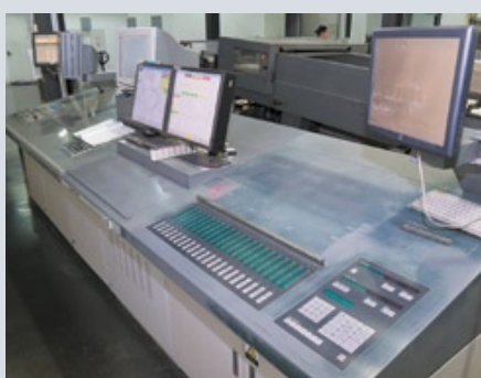
Печатный парк типографии «Роспак» состоит из шестикрасочной рулонной печатной машины Komori Chambon, использующей технологию офсетной УФ-печати
