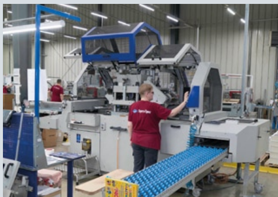
Новое приобретение типографии — еще один пресс для тиснения по переплетным крышкам
