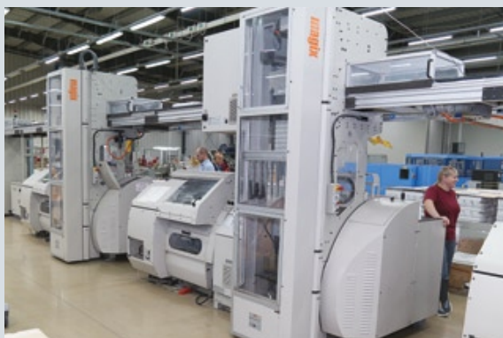
Новое приобретение типографии — еще один пресс для тиснения по переплетным крышкам
