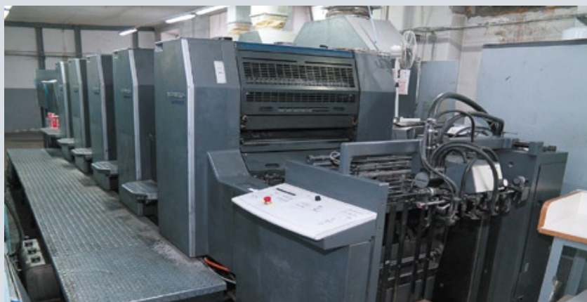
Историческая машина KBA Rapida 72K теперь переделана в УФ-лакировальную машину
