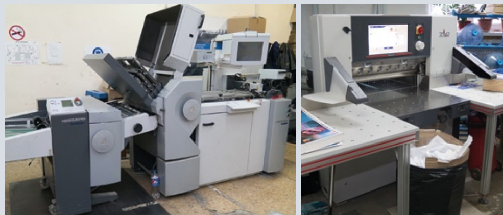
Большая часть производственного парка типографии «РустПресс» представлена оборудованием компании Heidelberg. В частности, послепечатный парк оснащен резальными устройствами Polar, фальцевальной машиной Stahlfolder и машинами клеевого бесшвейного скрепления Eurobind
