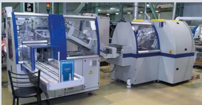
Трехножевая машина Kolbus HD для трехсторонней обрезки книжных блоков
