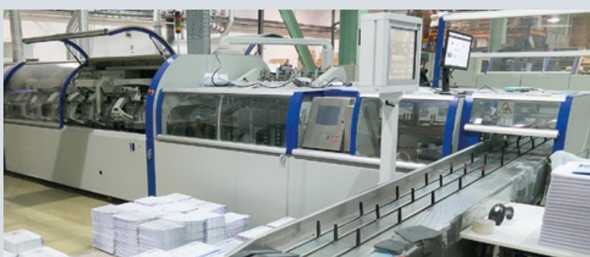
Высокоавтоматизированная книжная линия для проклейки книжного блока термостеклом и вставки его в переплетную крышку или обложку
