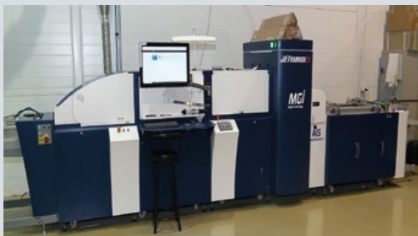
Выборочное лакирование по матовой ламинации выполняется на MGI JETVarnish 3D
