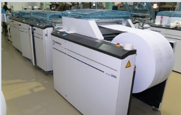
Для резки запечатанных рулонов на отдельные листы блока используются две линии от компании Hunkeler
