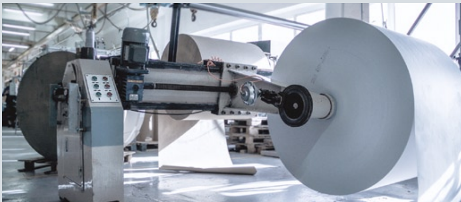
Гофролиния SP-1400 для производства двухслойного микрогофрокартона профилей F и E. На нем типография «ПЕТРОПАК» изготавливает гофроматериал для последующей кашировки
