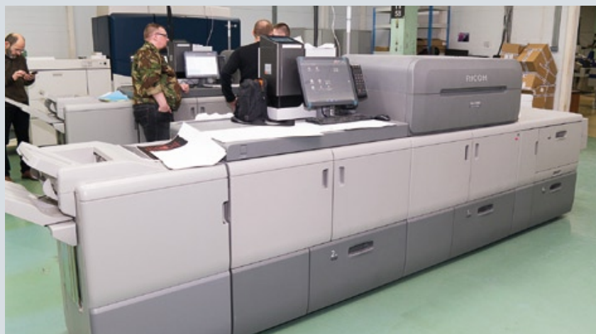
В этом году цифровая типография Т8 полностью заменила парк печатного оборудования, установив пять цифровых машин Ricoh. На фото: машины для полноцветной печати Ricoh Pro C9200, которые используются для производства обложек и книжных вкладок
