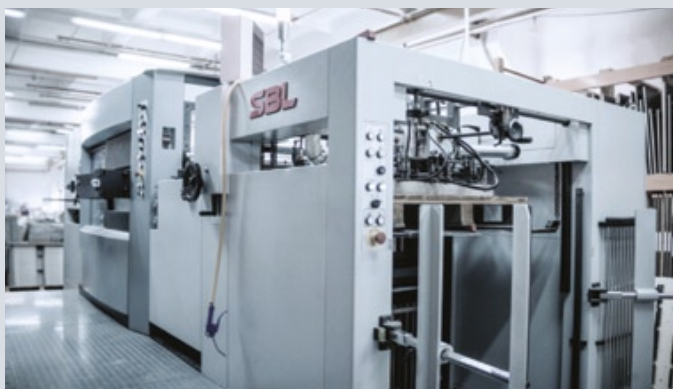
Вырубной пресс может вырубать листы как из обычного картона, так и из кашированного микрогофрокартона, в том числе выполнять конгревное тиснение
