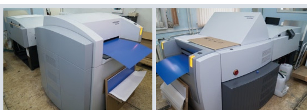
Два термальных CtP-устройства — Suprasetter 75S и Suprasetter A75HDX — изготавливают около 15 тыс. форм в месяц
