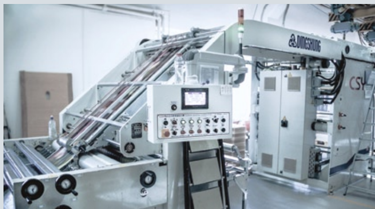
Кашировальная линия Aspire CS 1316 осуществляет точное совмещение листов при двустороннем кашировании и может работать с тонким лайнером до 120 г/м 2
