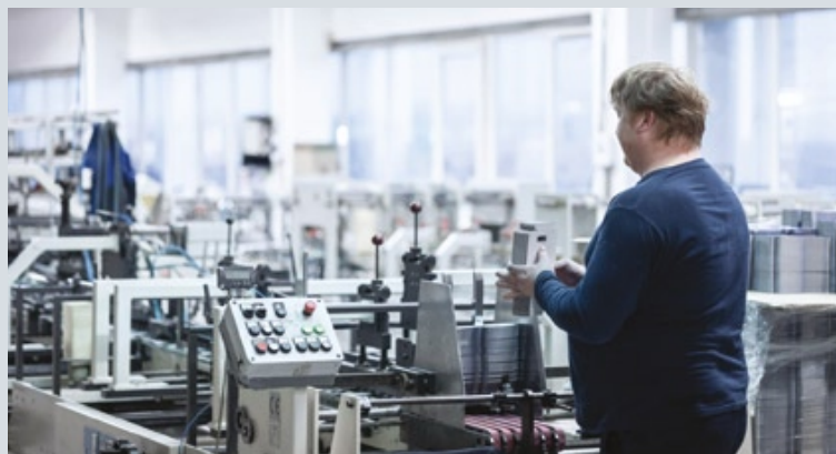
Фальцевально-склеивающая линия для трехточечной склейки заготовок из кашированного микрогофрокартона
