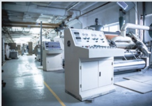
Гофролиния SP-1400 для производства двухслойного микрогофрокартона профилей F и E. На нем типография «ПЕТРОПАК» изготавливает гофроматериал для последующей кашировки
