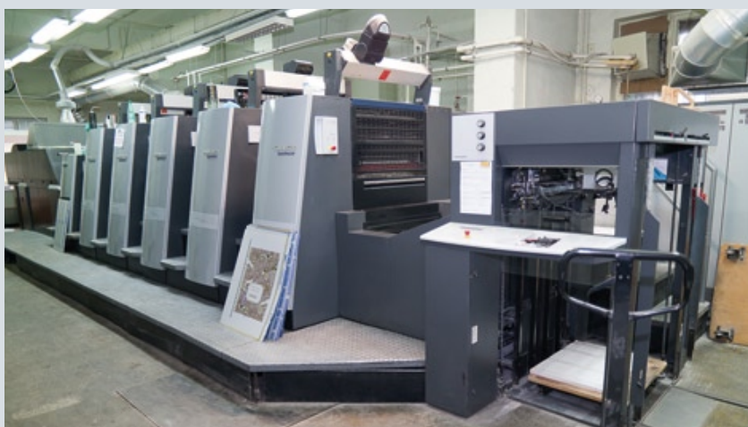
Печатная машина Heidelberg — пятикрасочная Speedmaster XL 75 с секцией лакирования — позволила типографии «РустПресс» наряду с рекламной полиграфией наладить производство упаковки. Оборудование с одинаково высоким качеством печатает как на бумаге, так и на плотном картоне, обеспечивая автоматическую переналадку на тираж и быструю смену форм
