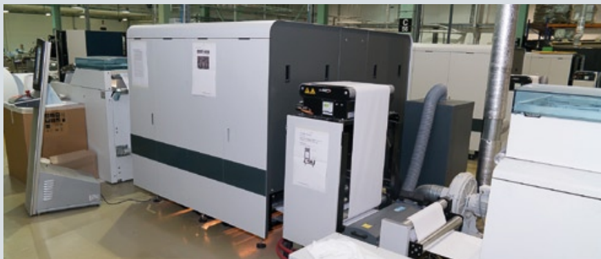
На производственной площадке Т8 установлены три рулонные струйные печатные машины Ricoh: две монохромные Pro V20100 и одна полноцветная VC20000 для производства книжных блоков. Машины оснащены модулями размотки/намотки от компании Hunkeler
