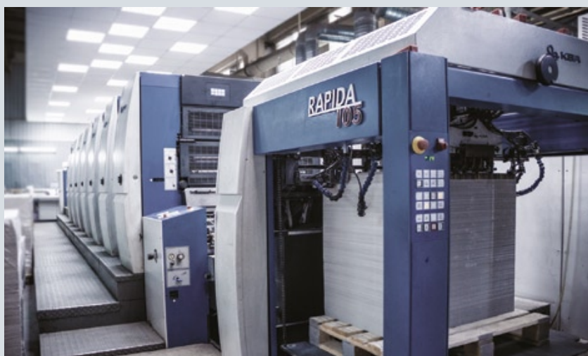
В типографии «ПЕТРОПАК» в этом году запущена шестикрасочная печатная машина компании Koenig&Bauer Rapida 105-6+L с возможностью печати масляными и УФ-красками, а также оснащенная секцией лакирования
