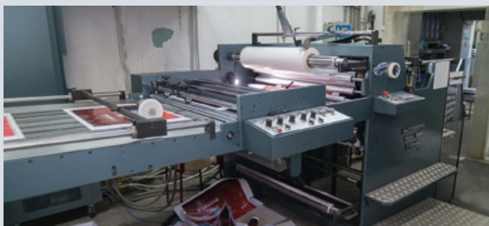
Промышленный ламинатор Autobond позволяет ламинировать пленкой лайнеры для последующей кашировки, а также обложки для многополосной продукции
