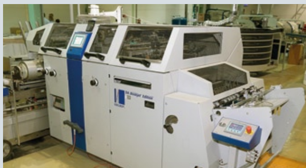
Крышкоделательный автомат компании Kolbus в конфигурации Bookjet Edition, предназначенный для работы с короткими тиражами
