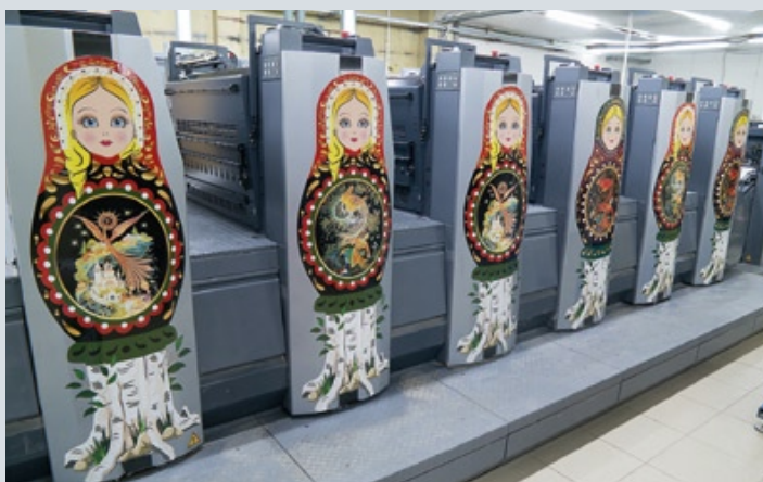
Новая пятикрасочная офсетная печатная машина RMGT 920ST-5+CC+SLD, оснащенная секцией лакирования и ИК-сушкой, была установлена в этом году в типографии «Куранты». Благодаря этой инсталляции предприятие вышло в первый формат
