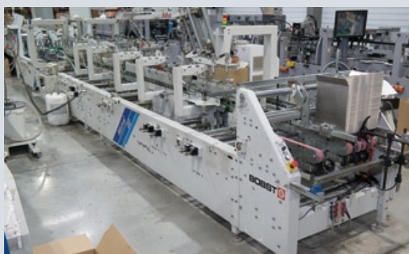
На производственной площадке «Альба Плюс» работают пять фальцевально-склеивающих линий, предназначенных для работы с заготовками из картона и микрофлуккартона с возможностью склейки до 6 точек
