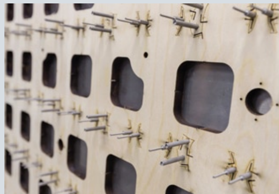
Станок HybridSetter позволяет в автоматическом режиме монтировать все типы выталкивающих элементов в фанерное основание
