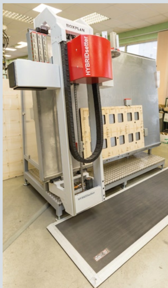
В октябре этого года в компании «ЛАЗЕРПАК» запущен в эксплуатацию станок HybridSetter для изготовления штампов для удаления отходов от компании BOXPLAN, входящей в группу BOBST
