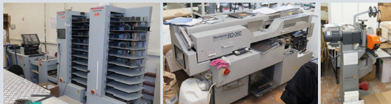
«Смарт Пресс» работает в разных сегментах полиграфического рынка, поэтому требуется оборудование под разные задачи. На фото — листоподборочная линия, машина КБС и проволокошвейный агрегат для производства многостраничной продукции
