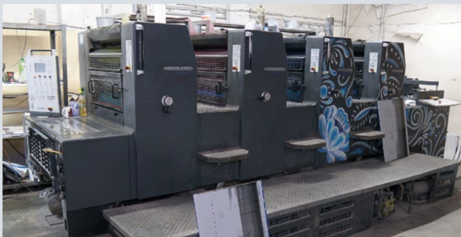
На производственной площадке типографии работают также офсетные печатные машины Heidelberg — две полуформатные четырехкрасочные машины Speedmaster
