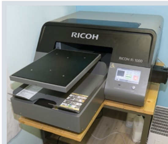
В марте этого года в компании «Профессионал-С.В.» приобрели текстильный принтер Ricoh Ri 1000. Оборудование позволяет печатать на любых видах одежды и ткани
