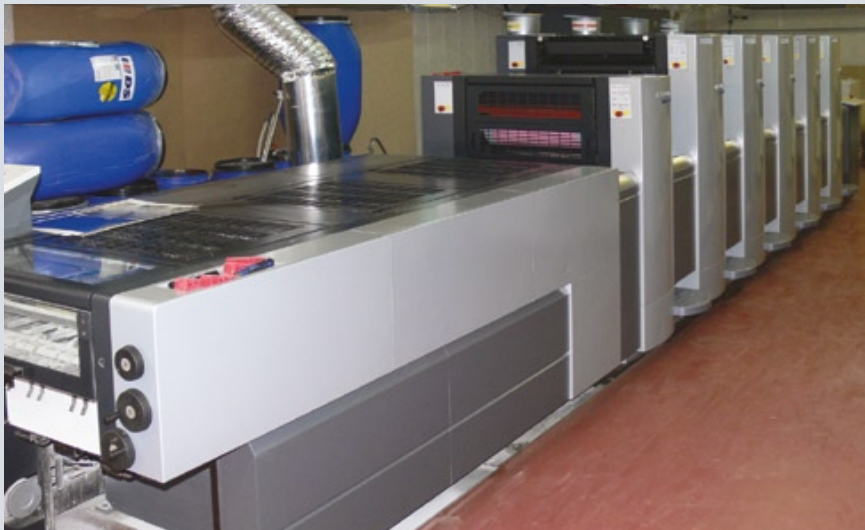
Типография «Синержи» имеет статус «Гейдельберг Предприятие-Партнер» и использует на производстве много единиц оборудования Heidelberg. На фото: пятикрасочная офсетная печатная машина Speedmaster SM 52 с секцией лакирования
