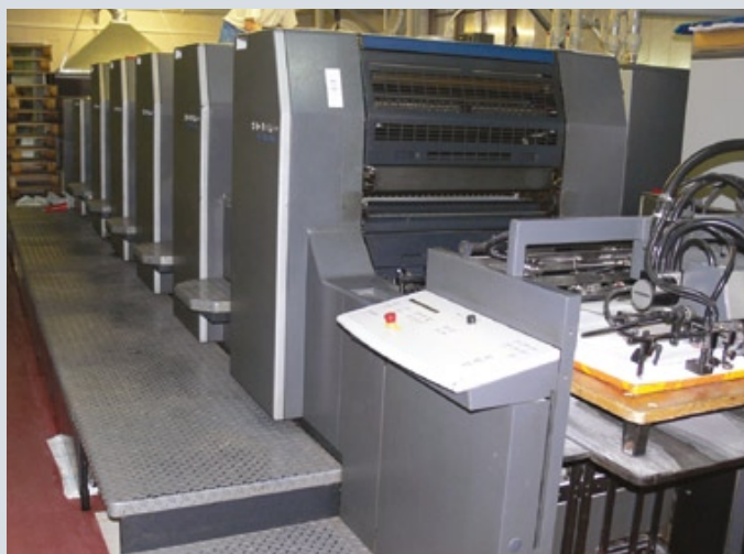
На предприятии работают три машины Heidelberg разной комплектации. На фото: двухкрасочный Speedmaster SM 52 и пятикрасочный Speedmaster SM 74 с секцией лакирования
