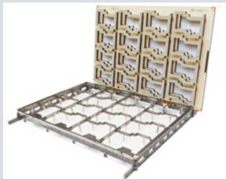
Комплект вырубной оснастки для разделения заготовок
