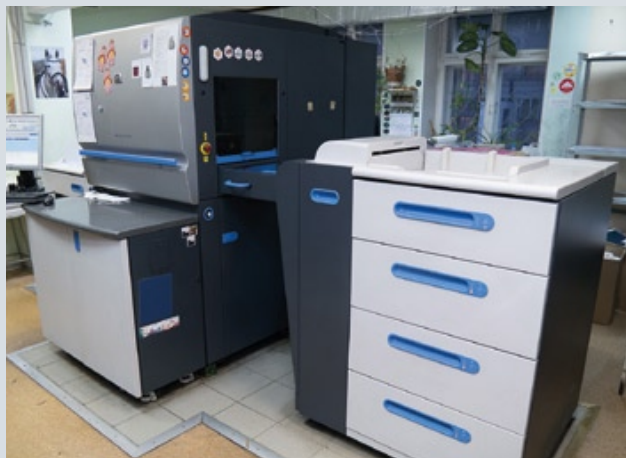
Цифровой печатный участок типографии «Синержи»: полноцветная HP Indigo Press 5500 и монохромная Ricoh Pro 1357ex
