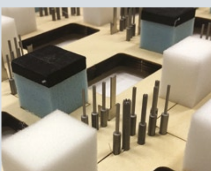
Выталкивающие элементы на штампе для удаления отходов — пины «корона», которые используются для изготовления динамических систем удаления
