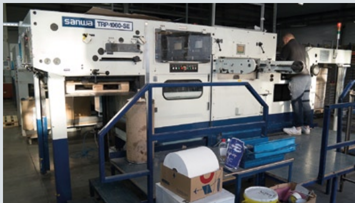
В «Альба Плюс» работают четыре промышленных вырубных прессы разных производителей для вырубki заготовок будущих коробок из картона и микрофлуккартона
