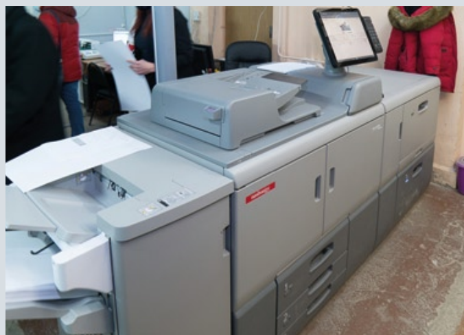
В оснащении цифрового подразделения в типографии «Куранты» свой выбор сделали в пользу оборудования компании Ricoh. На предприятии работают две полноцветные машины Ricoh Pro C7200X и Ricoh Pro C9200, а также машина монохромной листовой печати Ricoh Pro 8300
