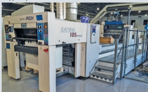
УФ-лакировальная линия на базе KBA Rapida 105 Universal для декоративной отделки
