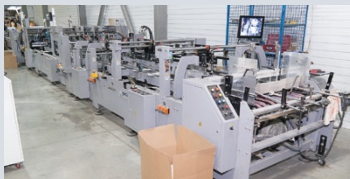
На производственной площадке «Альба Плюс» работают пять фальцевально-склеивающих линий, предназначенных для работы с заготовками из картона и микрофлуккартона с возможностью склейки до 6 точек
