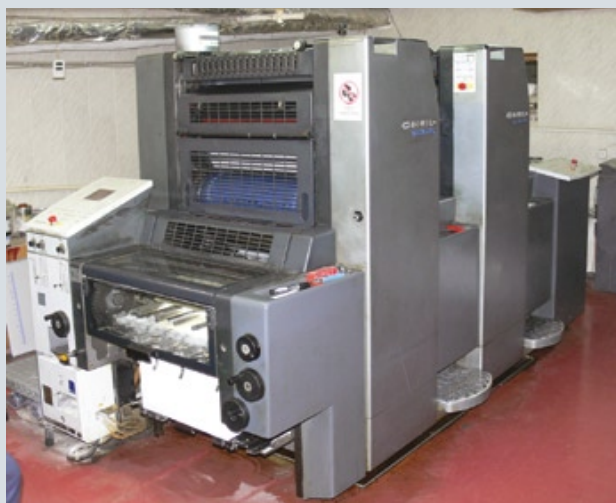
На предприятии работают три машины Heidelberg разной комплектации. На фото: двухкрасочный Speedmaster SM 52 и пятикрасочный Speedmaster SM 74 с секцией лакирования
