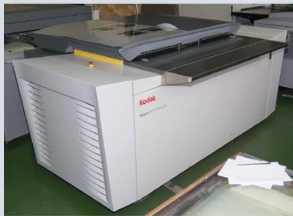
Экспонирующие устройства Kodak используются для изготовления форм для печатных машин Rapida 105
