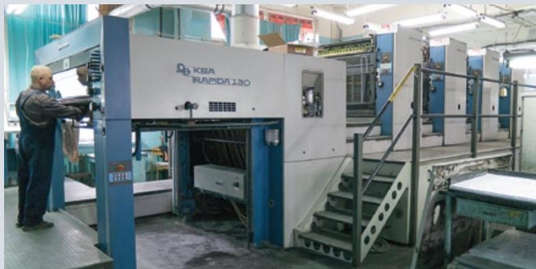
Пять машин большого формата Rapida 130 задействованы на комбинате для печати книжной продукции для ведущих российских издательств. Благодаря формату печати 900x1300 мм машины подходят для экономичной раскладки большинства форматов тетрадей книжного блока
