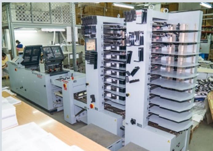
В марте 2019 г. в типографии установили листоподборочно-брошюровальный комплекс Horizon VAC-1000 SPF-200L, который позволяет в автоматическом режиме изготавливать многополосную продукцию формата А4 с альбомной ориентацией листа. Это единственная линия, обладающая такими возможностями
