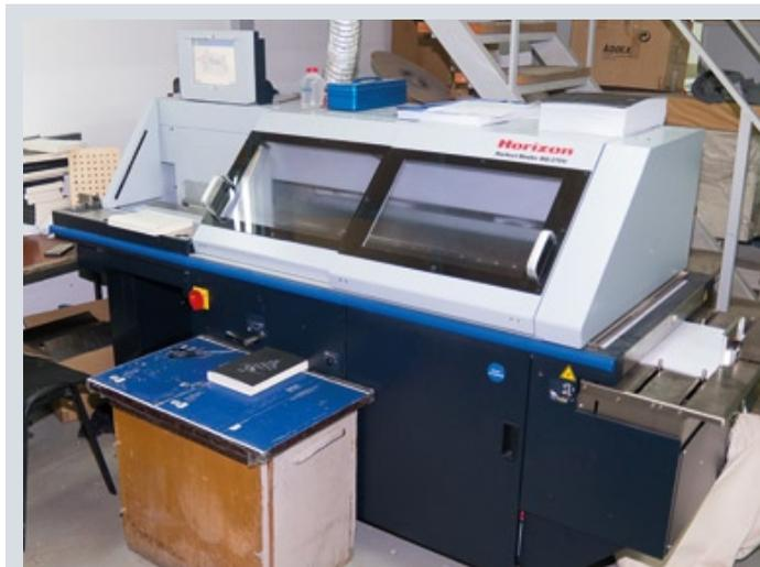
Инсталляция этой осени — новая модель клеевой бесшвейной линии Horizon BQ-270V. Линия КБС также заточена на изготовление изданий альбомного формата
