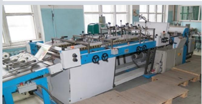
Фальцевально-склеивающая машина Fidia Cordo Garda для изготовления интегральных крышек и обложек с клапанами
