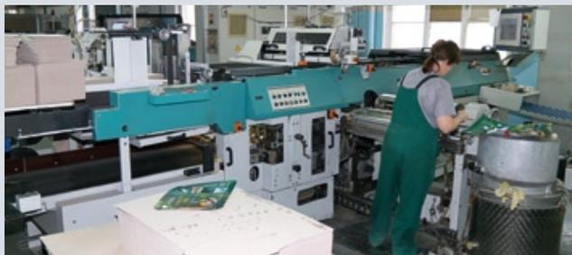
На комбинате работают две книговставочные линии Kolbus Compact-60, которые позволяют изготавливать издания в твердом и интегральном переплетках с толщиной блока до 65 мм
