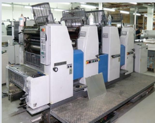
В типографии «Радуга» работают три офсетные печатные машины — Ryobi 522 H, Ryobi 662 и поставленная в августе 2018 г. четырехкрасочная Ryobi 784
