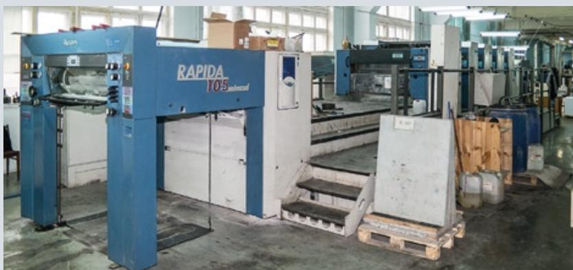
Печатный парк «Тверского полиграфического комбината» базируется на оборудовании концерна Koenig & Bauer. Сегодня здесь работают 7 машин. Из них две машины — пятикрасочные Rapida 105 с секцией лакирования. Они используются для печати многоцветных обложек и рекламной продукции
