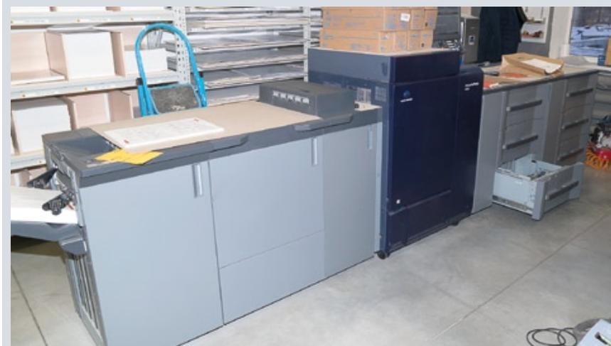
*В типографии «Гуд Принт» установлены две промышленные машины для коммерческой цифровой печати AccurioPress C6100, оснащенные модулем управления качеством печати IQ-501. За счет дублирования техники в компании стараются минимизировать производственные риски*
