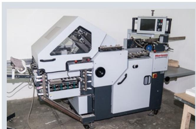
Новая фальцевальная машина Horizon AFC-544AKT обладает высокой автоматизацией и оснащена встроенными системами контроля, которые обеспечивают безошибочный процесс фальцовки листов для последующего скрепления
