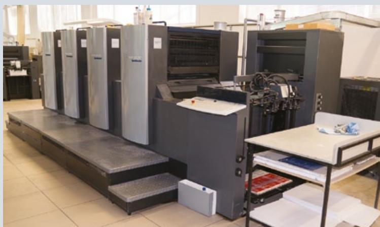
Производство типографии Sochi Press построено в основном на оборудовании компании Heidelberg. Для вывода офсетных форм используется CtP-устройство SupraSetter A75, а печатные мощности представлены пятикрасочной машиной Speedmaster 52 с секцией лакирования и четырехкрасочной Speedmaster второго формата
