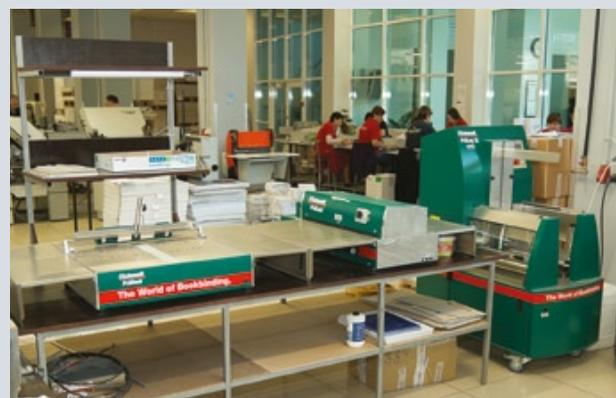
*В этом году в типографии наладили производство книжных изданий в твердом переплете. С этой целью приобрели ниткошвейный автомат и линию для изготовления переплетных крышек и вставки в них блоков*
