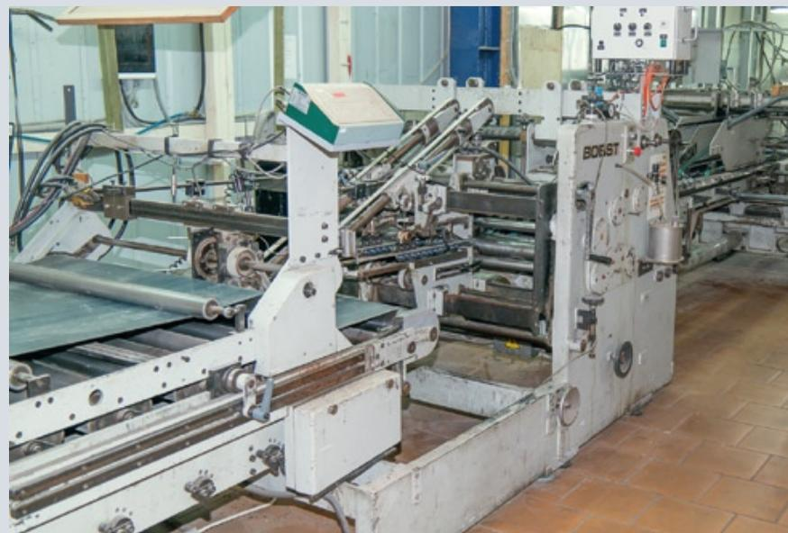
*Еще одна фальцевально-склеивающая линия BOBST приобретена для переделки в линию для нанесения клея на заготовки и приклейки полиэтиленовых пакетов к конвертам. Для этого на нее устанавливаются новые клеевые головки*
