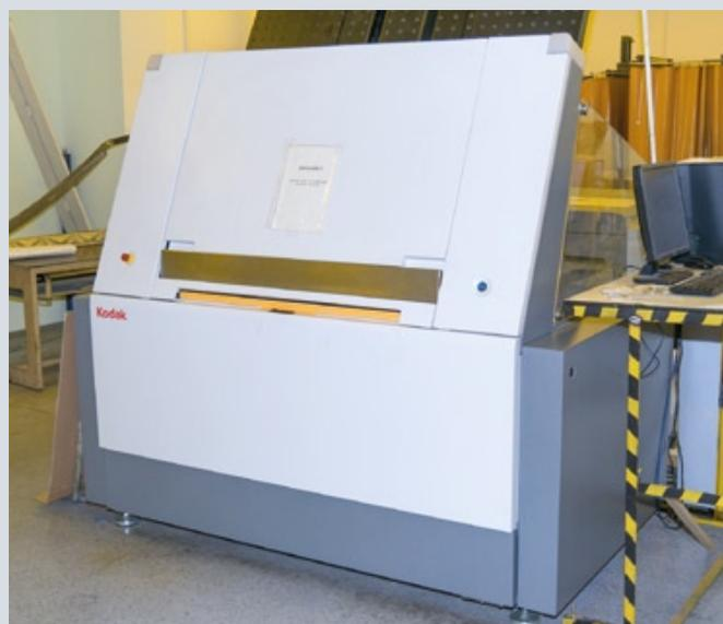
Цех допечатной подготовки типографии полностью укомплектован оборудованием производства Kodak разных годов выпуска. Самая свежая установка — специальная «быстрая» версия Kodak Trandsetter 800 для газетной печати (нижнее фото) — смонтированная в прошлом году
