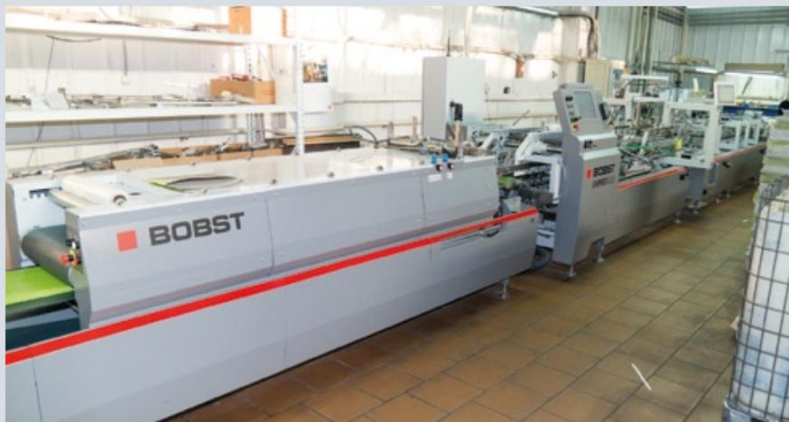
*Для вырубки и склейки конвертов из картона в компании «Курт» был установлен комплекс оборудования компании BOBST, состоящий из вырубного прессы EXPERTCUT и фальцевально-склеивающей линии EXPERTFOLD. Этот же комплекс позволяет изготавливать и картонную упаковку*
