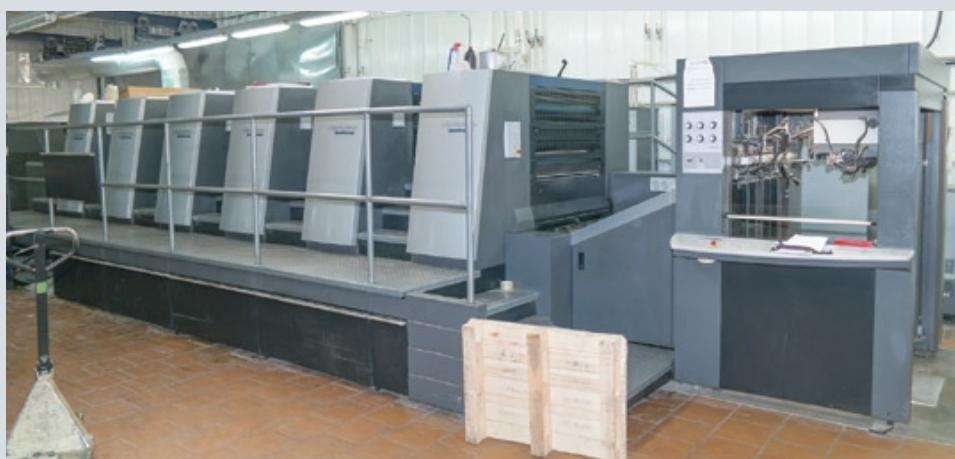
Для печати заготовок для красочных конвертов в типографии установлена печатная машина Heidelberg Speedmaster XL 105
