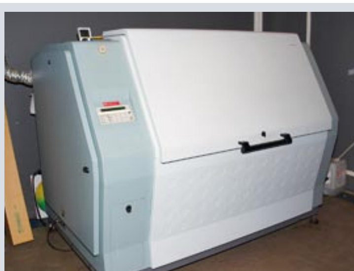
Вот на таких устройствах в настоящее время проводится экспонирование фотобумаги. Экспонирование проводится тремя цветными лазерами, фотобумага впоследствии проявляется обычным способом
