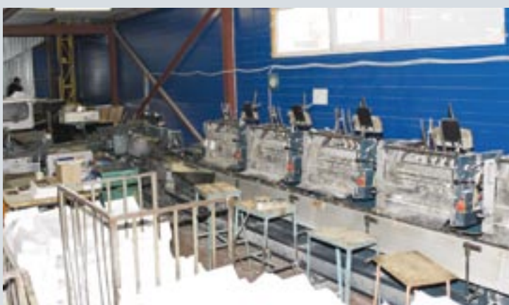
В послепечатном цехе есть все необходимое для изготовления изданий и «на скрепке», и «на клею», причем материалы используют- ся самые современные, включая полиуретановый клей
