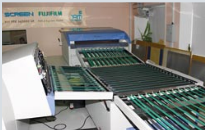
Основа допечатных процессов типографии «Девиз» — технология ZAC компании FujiFilm, реализованная в термальных пластинах LH-PXE и специальном процессоре, при этом на производстве работают выводные устройства разных производителей
