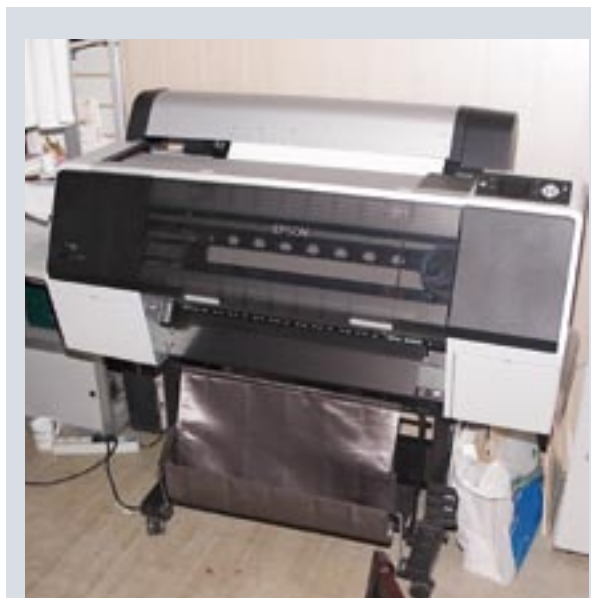
Для печати фотографий большого размера и обложек фотоальбомов используется струйный широкоформатный принтер
