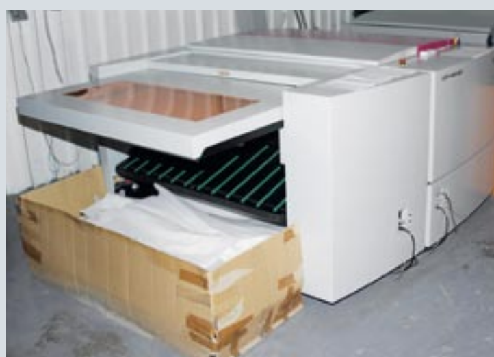
Установленное недавно новое выводное устройство позволяет намного быстрее выводить необходимый комплект печатных форм, к тому же работает на недорогих пластинах
