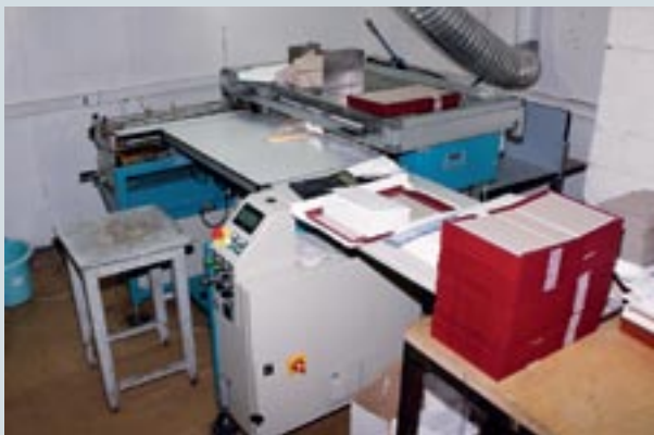
В силу небольших тиражей книг в типографии «Буки Веди» крышкоделательная машина ручная
