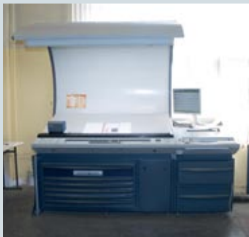
На «Московском комбинате игрушек» в настоящее время работают две печатные машины manroland: пятикрасочный Roland 700 HiPrint и пятикрасочный с удлиненной приемкой Roland 500, оба с секциями лакирования
