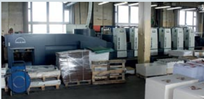
На «Московском комбинате игрушек» в настоящее время работают две печатные машины manroland: пятикрасочный Roland 700 HiPrint и пятикрасочный с удлиненной приемкой Roland 500, оба с секциями лакирования
