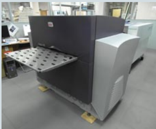
Формы для Genius 52UV экспонируются на CtP-устройстве Kodak Magnus 400. Для этого используются специальные пластины Toray для УФ-печати с силиконовым слоем
