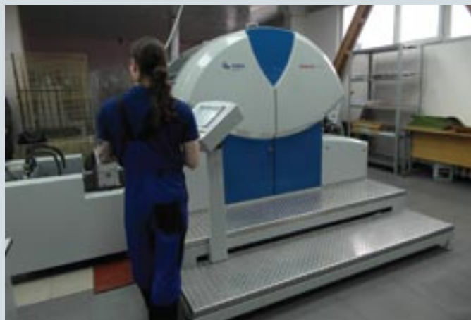
В типографии «БЭТТА АЛЪЯНС» пятикрасочная машина Genius 52UV используется для печати заготовок для пластиковых карт, но вскоре планируется изготавливать и другую продукцию на невпитывающих материалах
