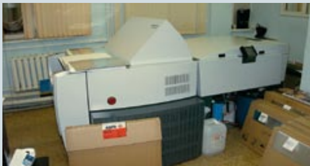
Устройство прямого вывода форм Supra setter 75 S — также от компании Heidelberg
