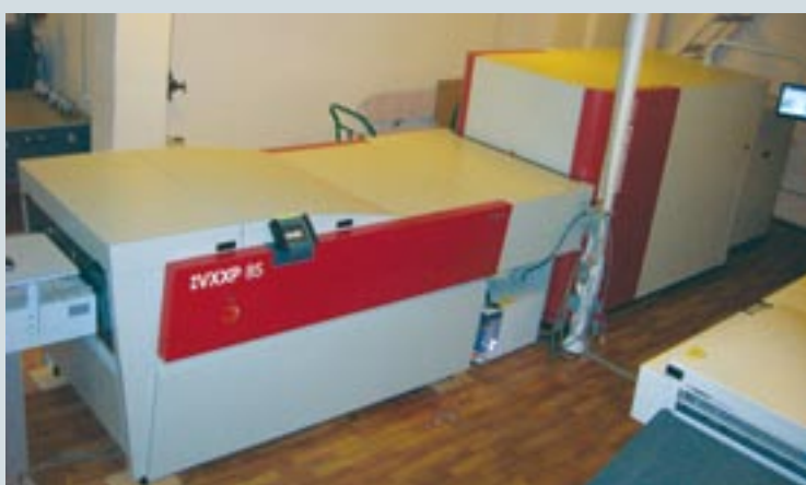
В октябре этого года в типографии «Прайм Принт Воронеж» установлено экспонирующее устройство Agfa Advantage N-DL XXT с процессором Agfa :VXXP 85. Это одно из самых быстрых фиолетовых устройств Agfa для газетных типографий со скоростью экспонирования до 220 пластин в час
