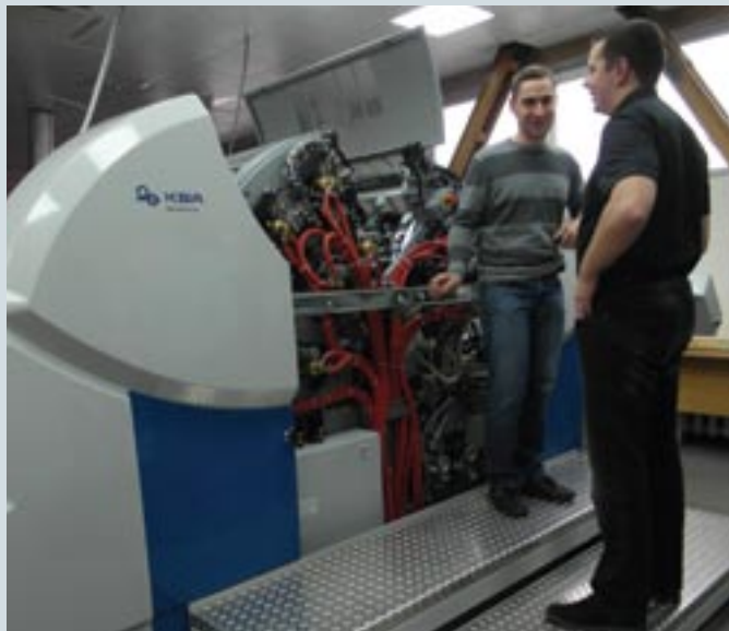
Планетарное построение делает печатную машину Genius 52UV компактным решением для производства малых и средних тиражей на невпитывающих материалах
