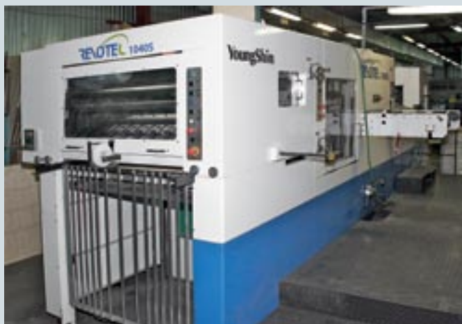
Вырубной пресс и линия для фальцесклейки коробок — необходимое оборудование для изготовления упаковки из плотного картона
