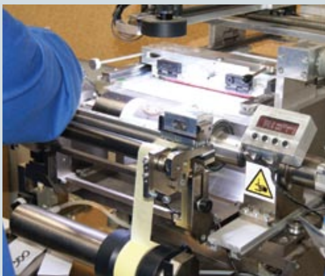
Приемка новой машины Nikelmap на заводе с печатью тестового тиража на реальной колбасной оболочке
