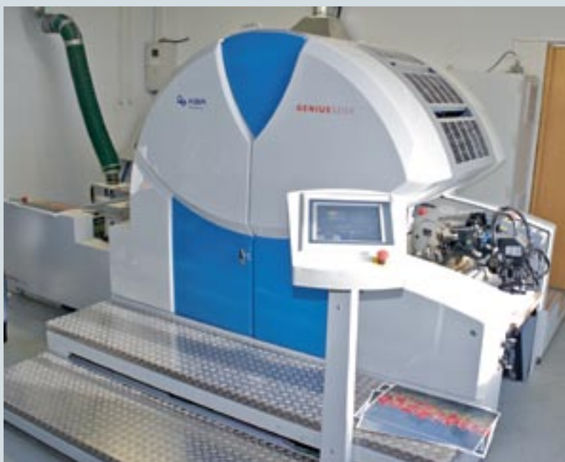
Компактная печатная машина KBA Genius 52 UV с технологией «сухого» офсета
