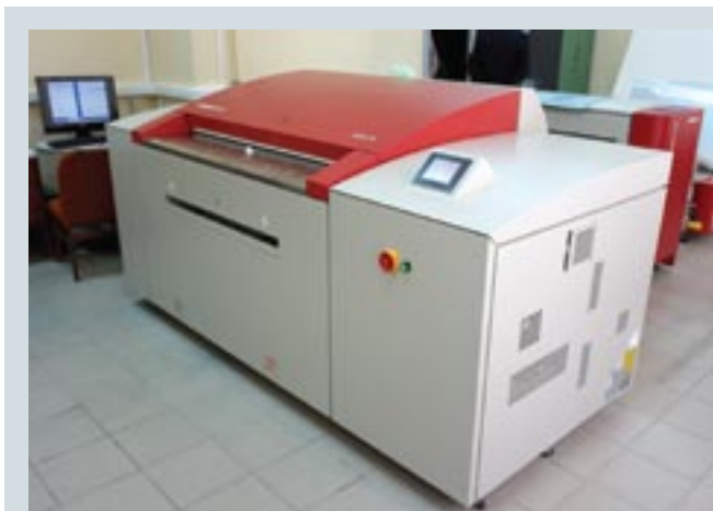
Новые устройства прямого экспонирования офсетных пластин в «Белорусском Доме печати». Слева — устройство серии :Avalon для коммерческой печати, справа — :Advantage для газетной
