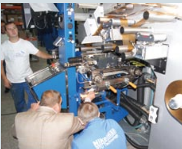
Приемка новой машины Nikelmap на заводе с печатью тестового тиража на реальной колбасной оболочке
