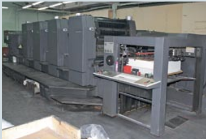
Цветная «рабочая лошадка» типографии — восьмикрасочная KBA Rapida 105 для печати цветной продукции 4+4 за один прогон
