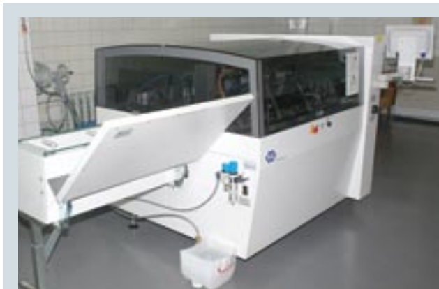
Пробойник для пластин с оптическим позиционированием по приводочным крестам печатной формы существенно ускоряет приладку на печатной машине
