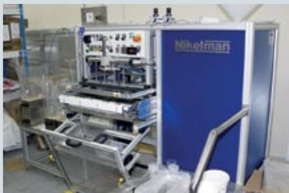
Гофратор для готовых оболочек (слева) и устройство вакуумной упаковки увлажненной и гофрированной оболочки (справа)
