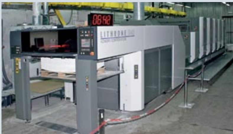
Свежее приобретение типографии «Вся Полиграфия»: новейшая пятикрасочная печатная машина Komori Lithrone G40 поколения drupa 2012
