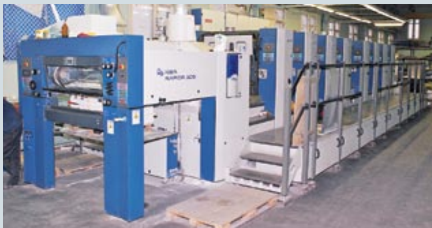
Цветная «рабочая лошадка» типографии — восьмикрасочная KBA Rapida 105 для печати цветной продукции 4+4 за один прогон
