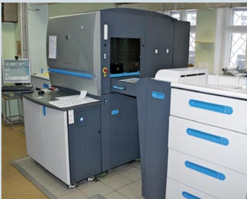
В типографии «Синержи» есть собственное цифровое подразделение, представленное цифровой печатной машиной HP Indigo 5500, с возможностью печати в семь красок, а также специально выделенным комплексом послепечатного оборудования для оперативной работы
