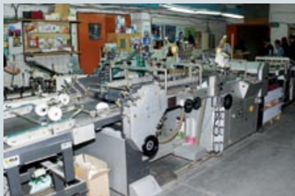
Вырубной пресс и линия для фальцесклейки коробок — необходимое оборудование для изготовления упаковки из плотного картона
