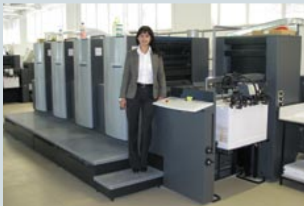
Парк печатных машин типографии Sochi Press в настоящее время составляют две печатные машины Heidelberg: пятикрасочный Speedmaster 52 с секцией лакирования и четырехкрасочный Speedmaster второго формата
