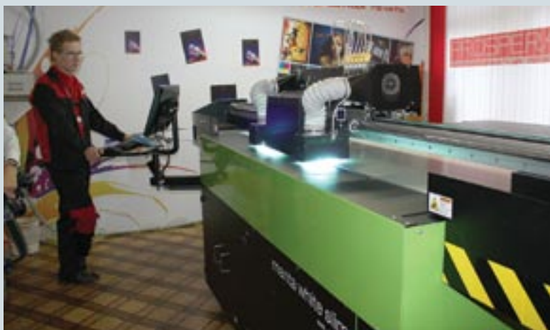
Широкоформатное устройство Grapo Manta Slim с УФ-отверждением чернил печатает на любых поверхностях
