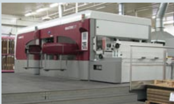
Вырубной пресс для гофрокартона Bobst MasterCut сверх-большого формата
