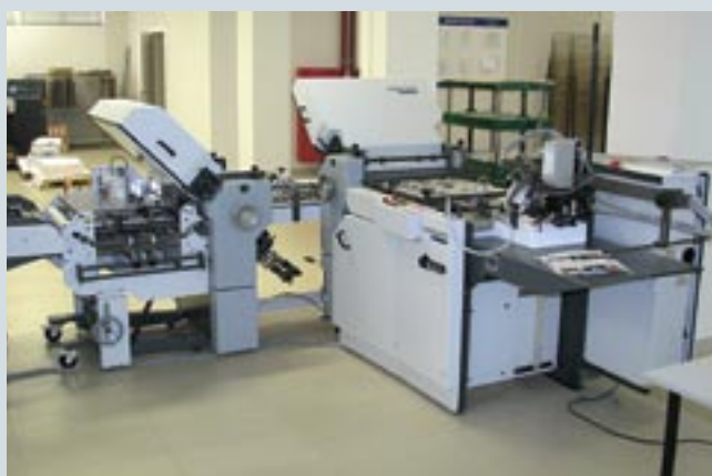
Послепечатные процессы также выполняются на оборудовании, поставленном Heidelberg: машина клеевого бесшвейного скрепления (вверху), линия для листовой подборки, шитья проволочными скобами и фальцовки (в середине) и многокассетная фальцевальная машина (внизу)
