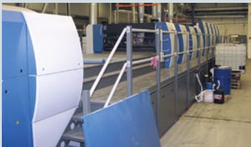
Новая машина KBA Rapida 162a с двумя секциями лакирования недавно установлена в PVG
