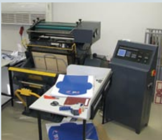
Вспомогательное послепечатное оборудование, используемое в типографии: пресс для вырубки и машина для шитья блоков нитками
