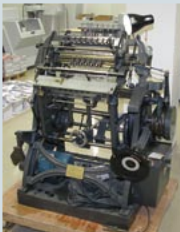
Вспомогательное послепечатное оборудование, используемое в типографии: пресс для вырубки и машина для шитья блоков нитками
