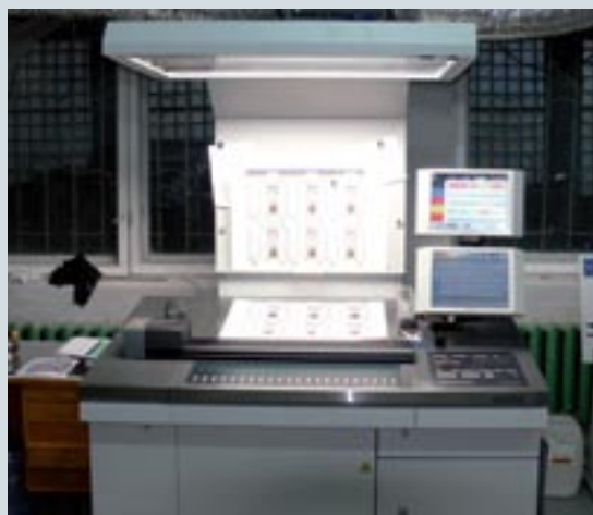
Новое приобретение типографии «Дельта Принт»: пятикрасочная печатная машина Komori Lithrone S29 с секцией лакирования и системой спектрофотометрического контроля цвета
