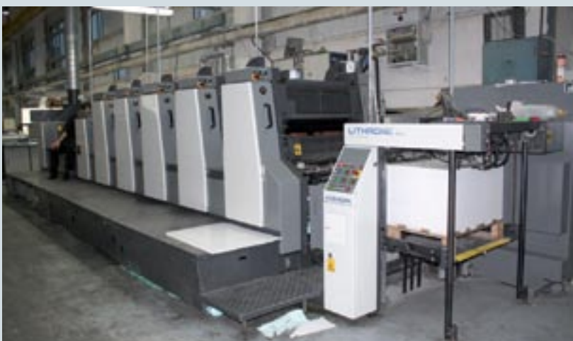
Основу производственного парка типографии составляют печатные машины KBA Rapida 105 (вверху) и полуформатный Komori Lithrone S528, обе машины с возможностью УФ-печати
