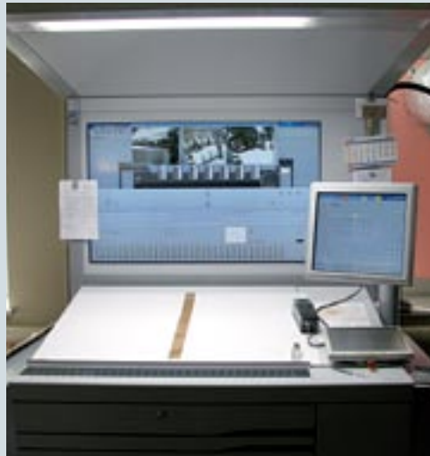
Новинка в типографии «Формат»: шестикрасочный Speedmaster CD102 с секцией лакирования и централизованным пультом управления с системой наблюдения за работой машины WallScreen
