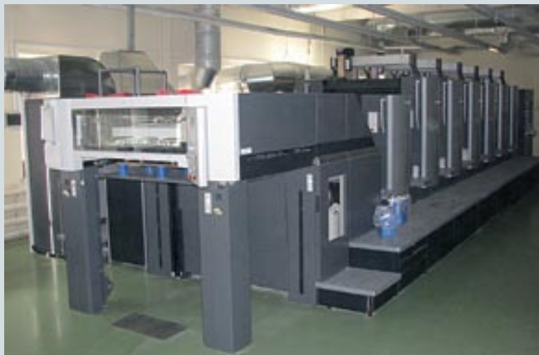
Новинка в типографии «Формат»: шестикрасочный Speedmaster CD102 с секцией лакирования и централизованным пультом управления с системой наблюдения за работой машины WallScreen
