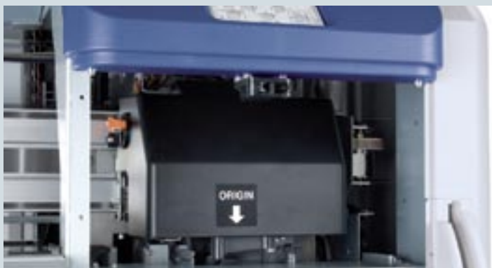
Механизм печатных головок плоттера Xerox 8254E
