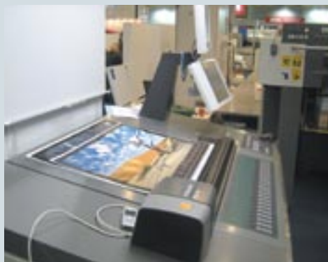
В оснащение печатных машин Komori входит сканирующая система контроля
