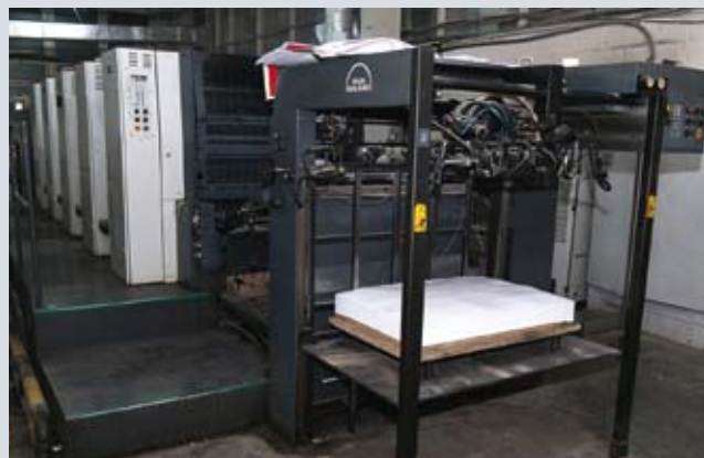
Офсетный печатный парк типографии построен на машинах компании manroland в классическом и гибридном исполнении
