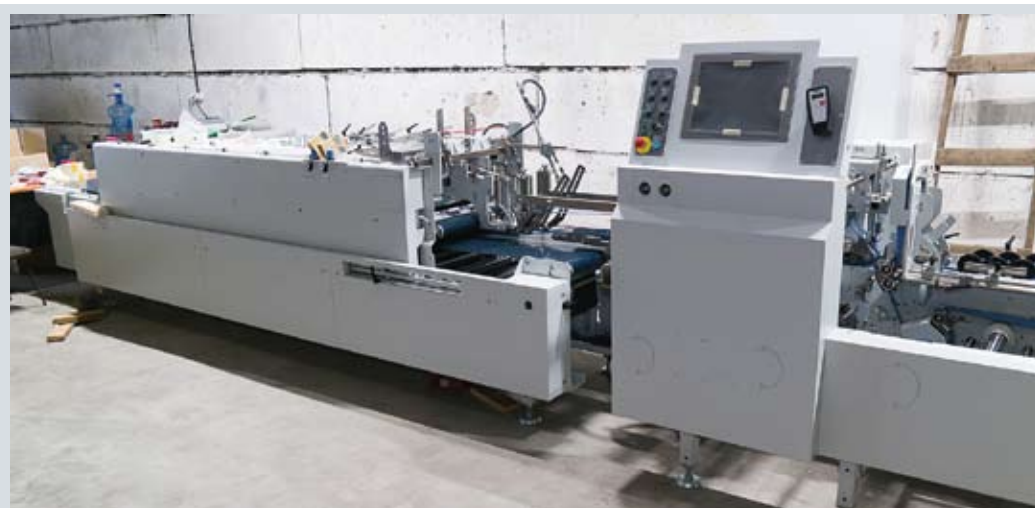
Фальцевально-склеивающая машина Bobst BOBST NOVAFOLD позволяет производить коробки множества типов из различных материалов со скоростью до 300 метров в минуту. Быстрая и удобная настройка и смена тиража и легкий доступ ко всем компонентам машины обеспечивают ее минимальное обслуживание
