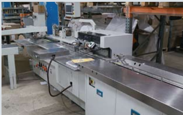
Уникальная автоматизированная линия для изготовления продукции, скрепленной проволочной спиралью
