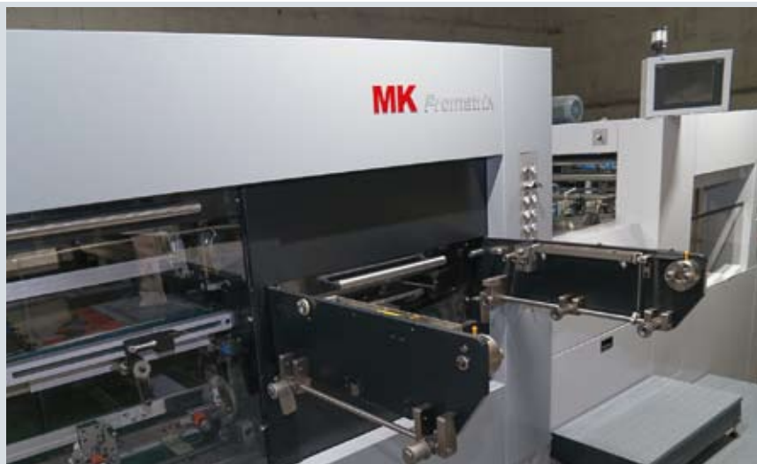
Автоматический высекальный пресс Promatrix 106 CS производства китайской компании Masterwork работает с бумагой и картоном форматом до 760x1060 мм и плотностью 90–2000 г/м², а также гофрокартоном толщиной до 4 мм. Максимальная скорость — 8000 л./ч. Его особенностью является наличие системы оптической приводки MasterSet, которая позволяет выполнять выравнивание по меткам, изображению или краю листа, а также спецоснащение для работы с гофрокартоном
