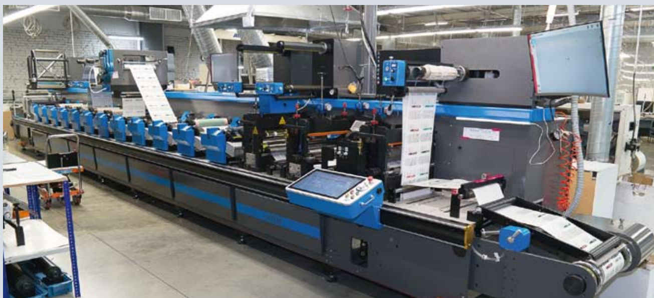
Флексографская 12-секционная сервоприводная машина i3S китайской компании Hude в типографии «Мегафлекс»
