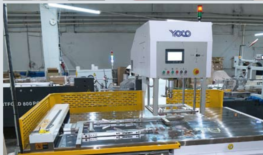
Недавние установки на производстве: автоматизированный пресс для высечки MNK 1050CE компании Dayuan Machinery с секцией удаления облоя и устройство для автоматизации разделения заготовок компании Yoco от «Терра Систем»
