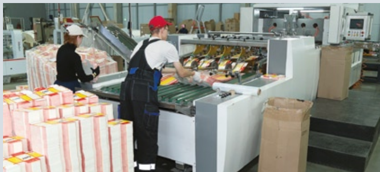
Из отпечатанного рулона получается готовая заготовка коробки. За один прогон: вырубка прямо из рулона, удаление обоя и разделение заготовки
