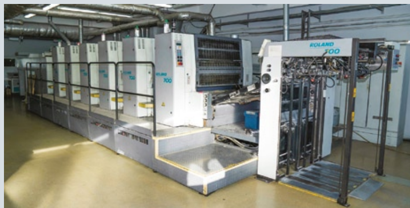
Листовая печатная машина используется для печати некоторых журнальных обложек, в том числе со сплошным и выборочным лакированием
