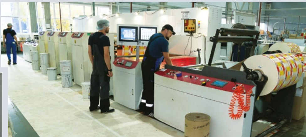
Пятикрасочная флексографская машина Weifang покупалась сразу в расчете на производство и бумажной посуды, и картонной упаковки
