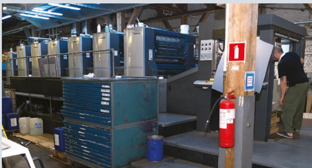
Основной «рабочей лошадкой» типографии является гибридная шестикрасочная печатная машина Heidelberg Speedmaster с лакировальной секцией
