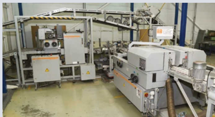
Рулонные машины оснащены системама склейки брошюр по корешку на фальцаппарате. На выкладке устанавливаются системы, проводящие поэземпллярную обрезку с трех сторон (на фото внизу)
