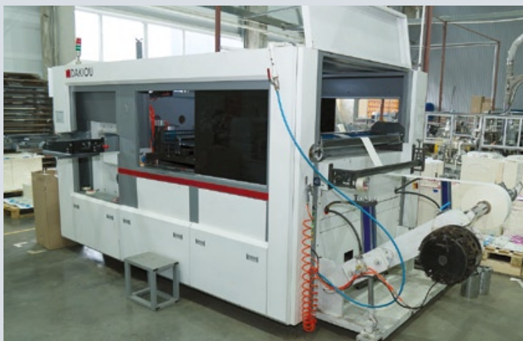
Заготовки для стаканов так же вырубаются из запечатанного рулона
