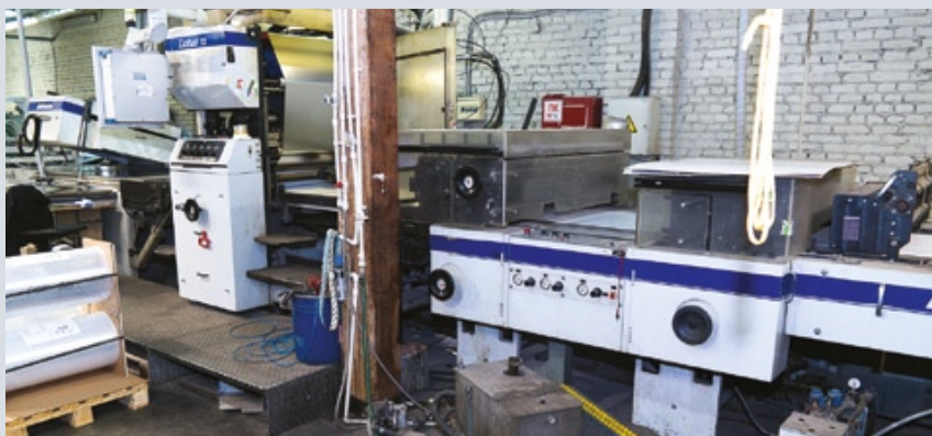
В типографии работает два промышленных ламинатора, с помощью которых здесь изготавливают металлизированный картон
