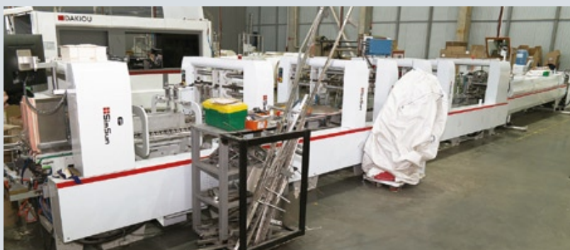
Фальцевально-склеивающая машина SimSun успешно склеивает коробки на скорости почти 50 тыс. экз. в час
