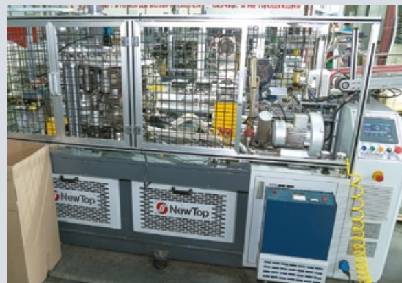
Заготовки для стаканов так же вырубаются из запечатанного рулона
