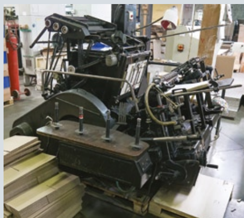
Для высечки изделий малыми тиражами применяют тигельный пресс
