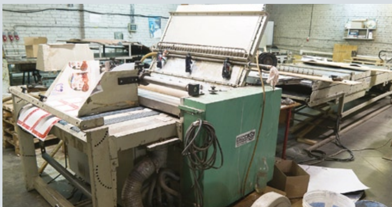
Две линии каширования позволяют изготавливать упаковку из гофрокартона, а также из плотного «переплетного» картона
