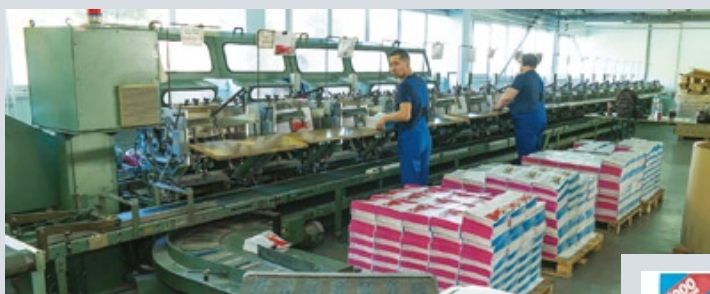
Оборудование для изготовления многостраничной продукции клеевым бесшвейным способом
