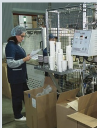
Заготовки для стаканов так же вырубаются из запечатанного рулона
