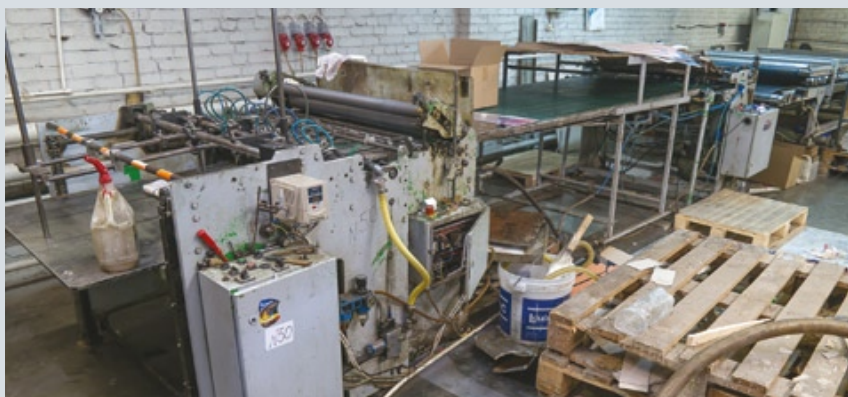
В типографии работает два промышленных ламинатора, с помощью которых здесь изготавливают металлизированный картон
