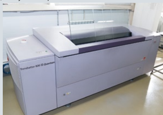
Собственный участок допечатной подготовки базируется на CtP-системе Kodak Trendsetter
