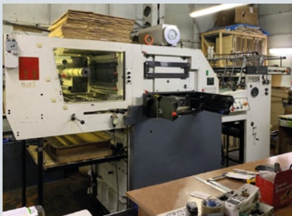
Фальцевально-склеивающая линия и вырубной пресс для послепечатной обработки заготовок картонной упаковки
