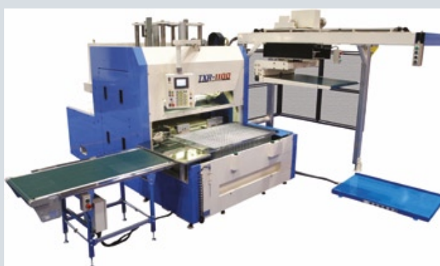
Автоматическое оборудование Kawahara TXR для отделения запечатанных заготовок из стопы и удаления обложки, оснащенное модулем загрузки и транспортером для выгрузки готовых изделий.
