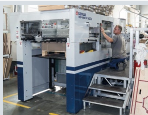
Комплекс послепечатного оборудования типографии «Борус» для производства упаковки — фальцевально-склеивающая линия и вырубной пресс
