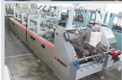
На предприятии установлен комплекс послепечатного оборудования компании BOBST — высекальный пресс NOVACUT 106E и фальцевально-склеивающая линия EXPERTFOLD 80A2
