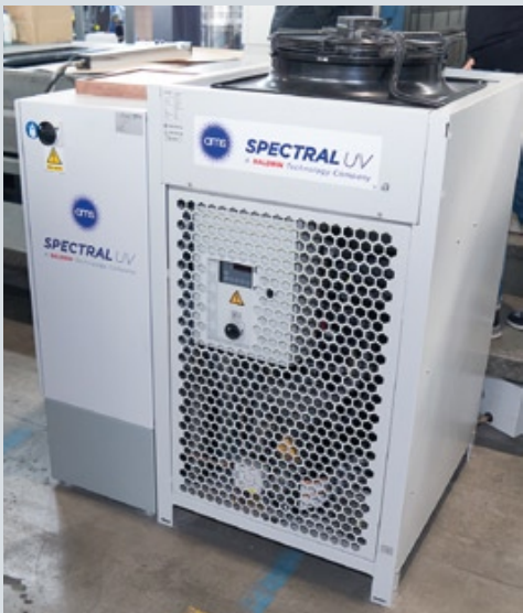
Система водяного охлаждения и блок питания светодиодной сушишки
