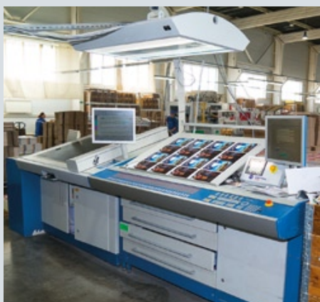
В начале 2019 г. в типографии «Борус» завершена реализация проекта по оснащению листовой пятикрасочной офсетной машины Rapida 105+5-L светодиодной сушикой
