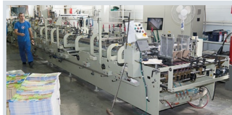
Комплекс послепечатного оборудования типографии «Борус» для производства упаковки — фальцевально-склеивающая линия и вырубной пресс
