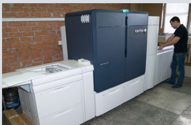
Недавней инсталляцией в типографии «Поликraft» стала цифровая печатная машина Iridesse Production Press от компании Xerox с возможностью печати до 6 цветов одновременно
