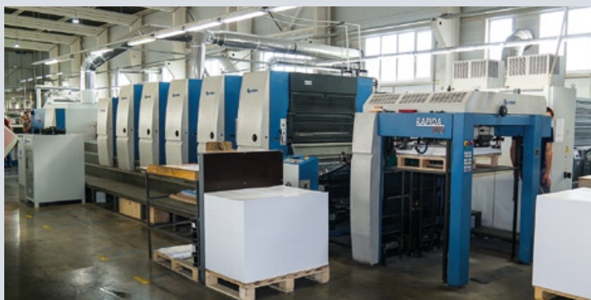
В начале 2019 г. в типографии «Борус» завершена реализация проекта по оснащению листовой пятикрасочной офсетной машины Rapida 105+5-L светодиодной сушикой
