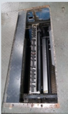
Извлеченная из машины светодиодная сушилка AMS Spectral UV XP9i
