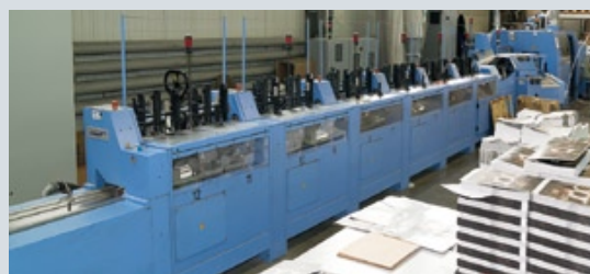
Высокопроизводительная линия клеевого бесшвейного скрепления Muller Martini Pantera, оснащенная двумя клеевыми станциями для нанесения как термоклей, так и PUR-клея
