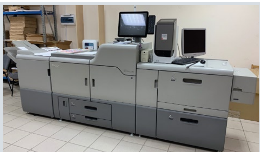
Типография «Корvus», одна из ведущих полиграфических компаний Алтайского края, установила в прошлом году флагманскую модель цифровой печатной машины Ricoh Pro C7200X с дополнительным пятым цветом. Оборудование позволило рентабельно печатать малые тиражи не только рекламной продукции, но и упаковки на плотных материалах
