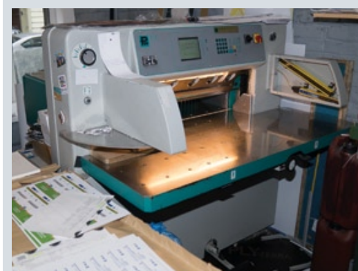
В типографии «Трактат» установлено профессиональное резальное оборудование и термоклеевая машина для изготовления книг с бесшвейным скреплением
