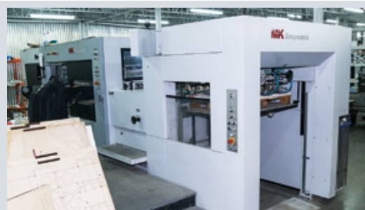
Вырубной пресс Easymatrix 106 C/CS для послепечатной обработки упаковочной продукции
