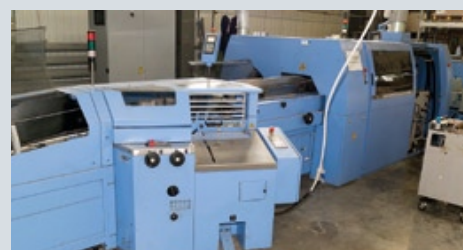
Высокопроизводительная линия клеевого бесшвейного скрепления Muller Martini Pantera, оснащенная двумя клеевыми станциями для нанесения как термоклей, так и PUR-клея
