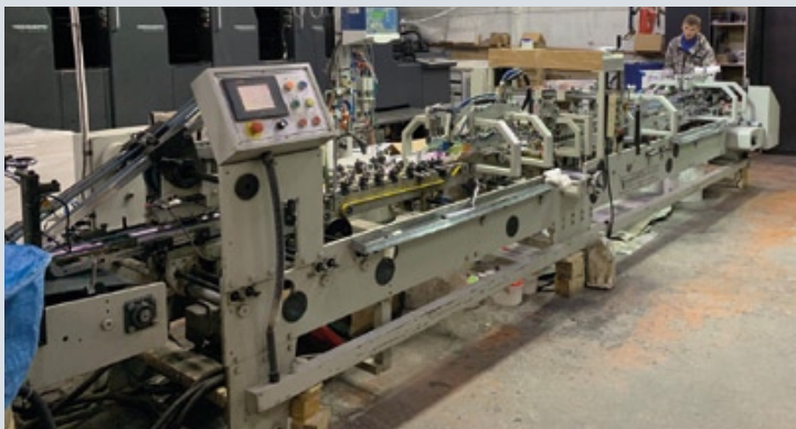
Фальцевально-склеивающая линия и вырубной пресс для послепечатной обработки заготовок картонной упаковки
