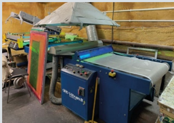
Трафаретная линия позволяет выполнять декоративную отделку УФ-лаком
