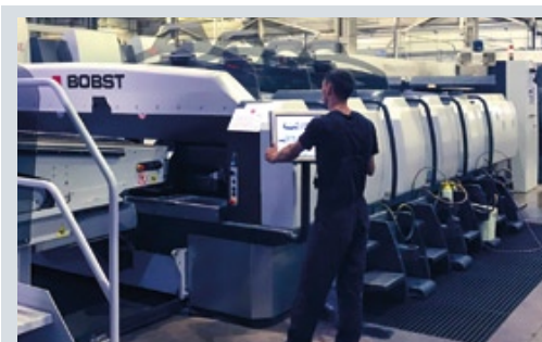
Автоматическая линия по изготовлению упаковки из гофрокартона FFG 8.20 EXPERTLINE
