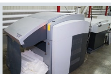
CtP-устройства Heidelberg для экспонирования пластин — Suprasetter A75 и Suprasetter S105
