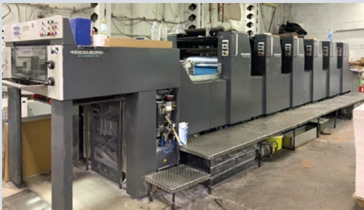
Шестисекционная печатная машина Heidelberg Speedmaster 74-6, переоборудованная для нанесения ВД-лака, используется для производства упаковочной продукции
