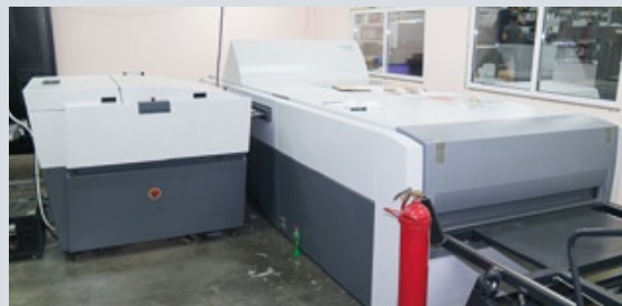
CtP-устройства Heidelberg для экспонирования пластин — Suprasetter A75 и Suprasetter S105
