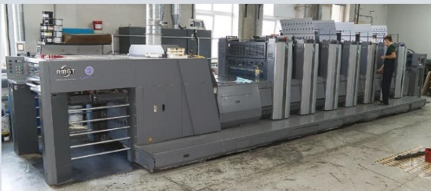
В прошлом году в типографии «Рубикон» была установлена шестикрасочная офсетная машина RMGT 920ST-6 в специальной конфигурации для печати высокорезактивными красками. Она оснащена секцией лакирования и несколькими полупроводниковыми сушильными устройствами фирмы AMS. Машина позволила изготавливать сложную «сухую» этикетку по привлекательной себестоимости
