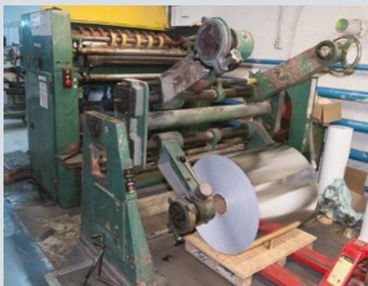
Оборудование для изготовления металлизированной бумаги для производства этикеток
