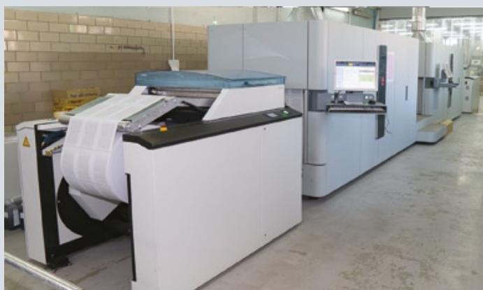
Парк цифрового печатного оборудования типографии «Паблит» представлен машинами компании Canon. Основу парка составляет рулонная цифровая печатная машина Océ ColorStream
