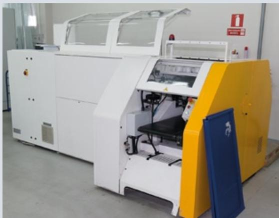
Оборудование для изготовления книг в твердом переплете с шитьем нитками
