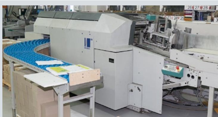
Послепечатное оборудование для производства книжных изданий в мягкой обложке: линия для подборки тетрадных блоков, машина для клеевого бесшвейного скрепления, линия для накидки обложек
