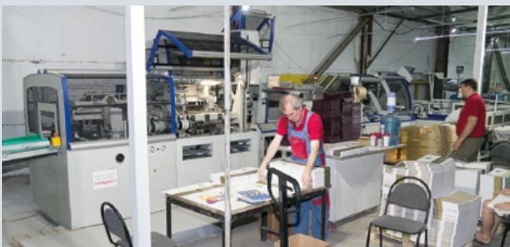
Оснащение типографии «Буки Веди» позволяет изготавливать книжные издания как в мягкой обложке, так и в твердом переплете. Слева: машина клеевого бесшвейного скрепления, справа: линия для изготовления твердого переплета
