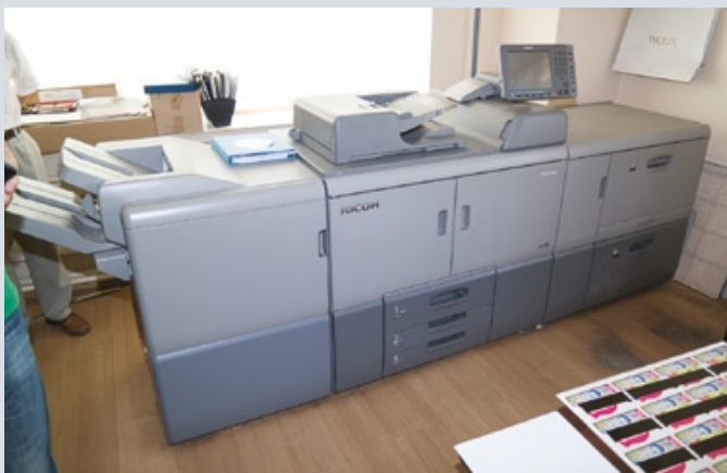
В связи с востребованностью рынком печатной продукции с переменными данными в типографии установили цифровую монохромную машину Ricoh Pro 8100, на которой впечатывают часть сменяемой графической информации
