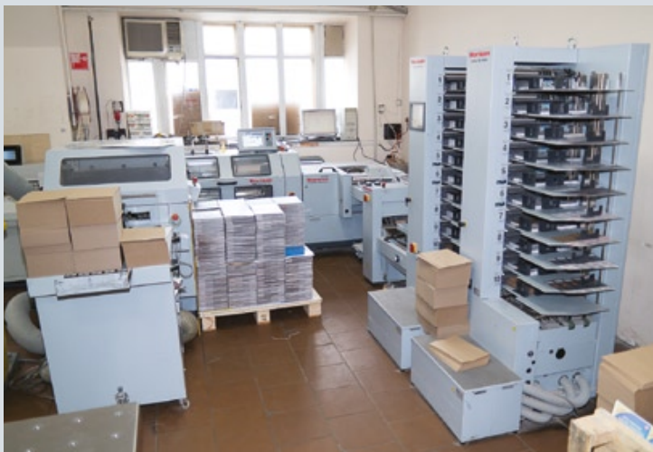
Типография «Аква Арт Принт» несколько лет назад обновила парк послепечатного оборудования, установив резальную машину Schneider Senator и брошюровальный комплекс Horizon StitchLiner, который оснащен листоподборочной станцией, биговально-фальцевальным модулем, проволокошвейным модулем и трехножевой резальной машиной. Оборудование позволяет профессионально и с высокой производительностью изготавливать брошюры с корешком классической формы
