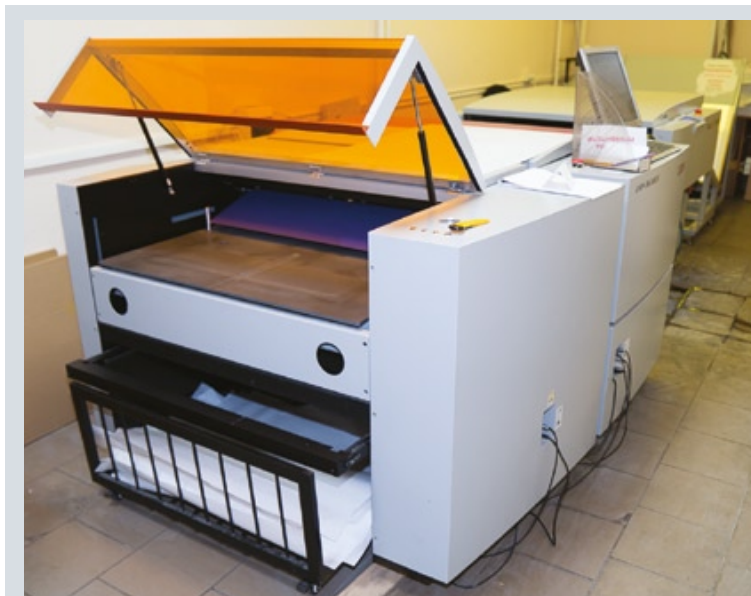
В рамках программы переоснащения производственного парка в типографии приобрели устройство для экспонирования офсетных пластин Crop. Наличие собственного допечатного участка позволило заметно сэкономить ресурсы
