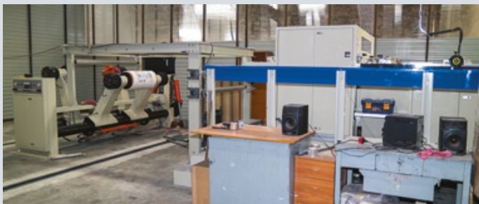
«Упакресурс» закупает картон в рулонах, а затем распускает его на листы на специальном оборудовании. Так производство микрогофрокартона и упаковки получается экономически выгоднее
