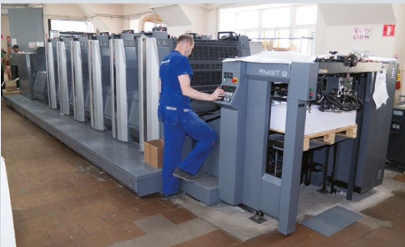
В типографии «Аква Арт Принт» установлена пятикрасочная печатная машина RMGT 920 ST-5 с секцией лакирования, инсталлированная специалистами компании «Терра Системы». Она оснащена автоматической системой одновременной смены печатных форм Smart FPC сразу на всех секциях, что позволяет эффективно выполнять короткие тиражи. Для компании, специализирующейся на производстве рекламной полиграфии, это весомый аргумент при выборе печатного оборудования
