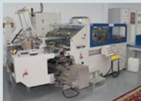
Производственные комплексы Muller Martini в типографии (сверху вниз): вкладочно-швейно-резальный агрегат Presto, линия бесшвейного скрепления Pantera, линия для производства книг в твердом переплете Diamant MC
