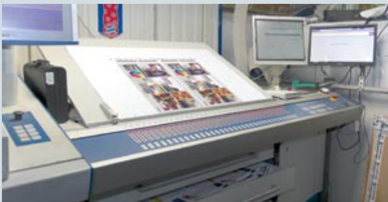
Несколько лет назад в типографии «Арбат» была установлена печатная машина KBA Rapida 105 с возможностью печати УФ-отверждаемыми красками...
