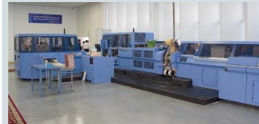
Производственные комплексы Muller Martini в типографии (сверху вниз): вкладочно-швейно-резальный агрегат Presto, линия бесшвейного скрепления Pantera, линия для производства книг в твердом переплете Diamant MC
