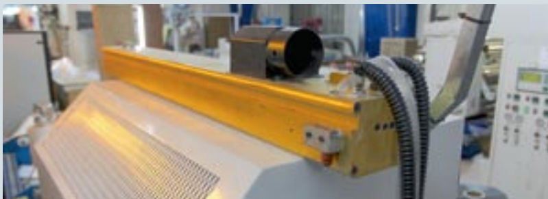
...а недавно на эту машину было установлено сушильное устройство HR-UV, позволяющее использовать высокорезактивные краски
