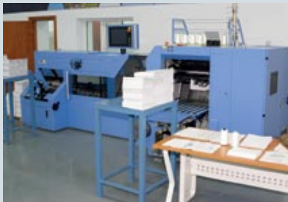
В дополнение к производственным линиям был установлен и комплекс другого необходимого брошюрово-переплетного оборудования (сверху вниз): трехножевая резальная машина Granit, крышкоделательная машина Horauf, ниткошвейный агрегат Ventura
