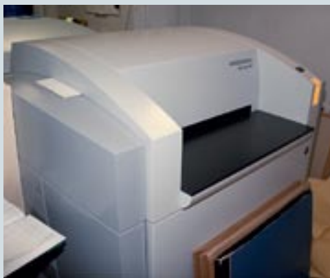
Печатные формы для двух печатных машин изготавливаются на недавно обновленном термальном выводном устройстве Heidelberg Suprasetter
