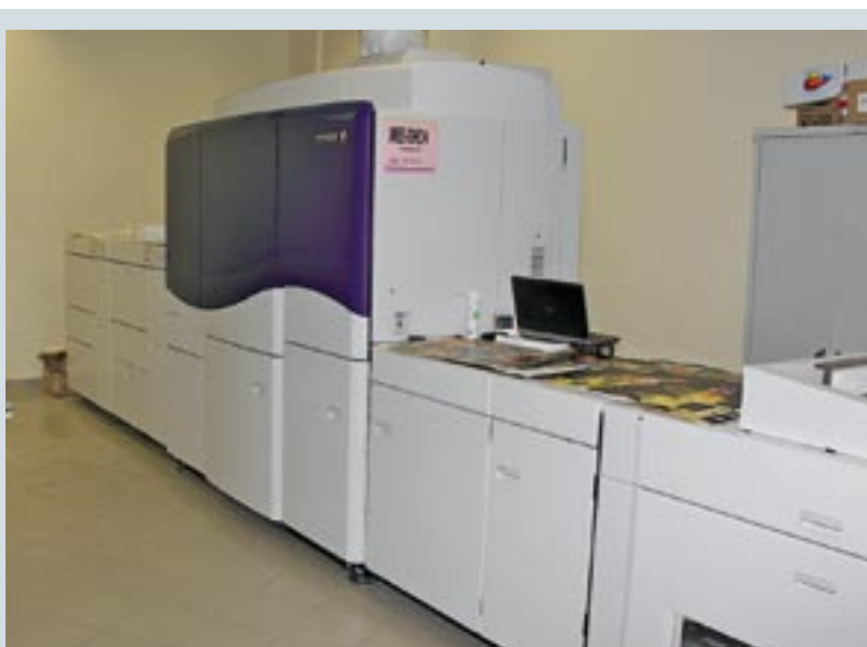
Самая производительная цифровая печатная машина Xerox iGen 150 с контроллером печати EFI Fiery установлена в типографии «Футурис». Она позволит повысить оперативность выполнения заказов, в том числе с переменными данными
