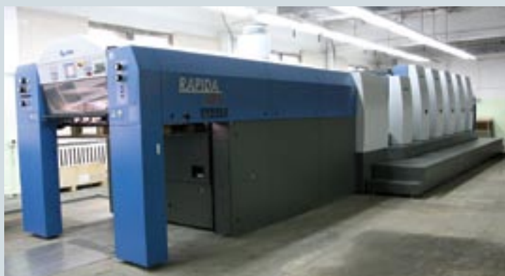
Пятикрасочная печатная машина KBA Rapida 105 с секцией лакирования обеспечивает высокую производительность и позволяет печатать как на тонких, так и на плотных материалах, в частности на трехслойном микрофруктоне
