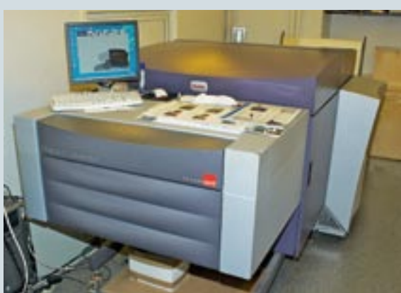
Типография «Альфа-Дизайн» стала одной из первых, которая перешла на беспроцессную и экологически чистую технологию изготовления печатных форм. На предприятии работает термальное выводное устройство Kodak Magnus 400 Quantum
