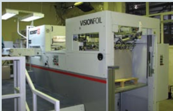
Bobst VisionFoil — пресс для высококачественного тиснения фольгой
