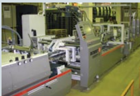
Две фальцевально-склеивающие линии Bobst позволяют работать и с плотным, и с гофрированным картоном
