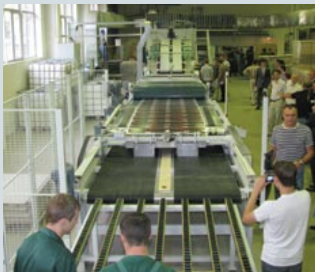
Кашировальная машина большого формата Asitrade (входит в группу Bobst) обеспечивает высококачественную склейку картона (или гофрокартона) с предварительно запечатанным верхним листом
