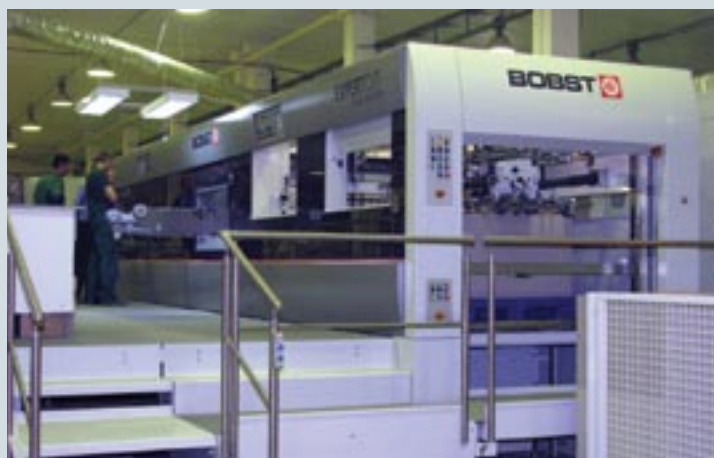
Две фальцевально-склеивающие линии Bobst позволяют работать и с плотным, и с гофрированным картоном
