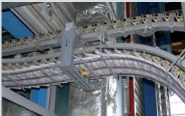
Прямо с печатных машин готовые газеты по транспортеру попадают в цех экспедирования
