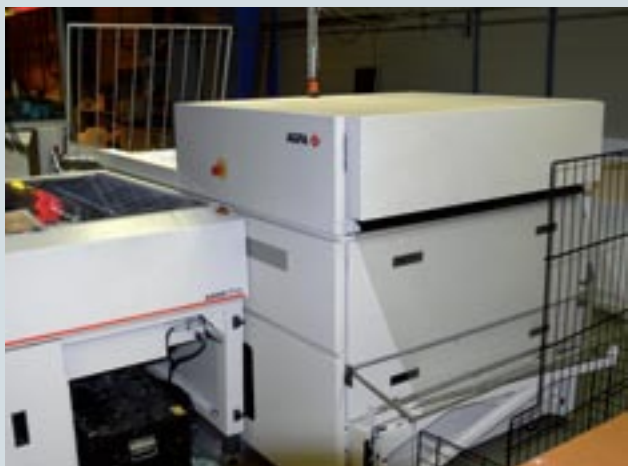
В ПК «Экстра М» используются устройства экспонирования пластин различных моделей, предназначенных и для экспонирования форм газетной печати, и пластин для журнального производства. Все устройства произведены компанией Agfa
