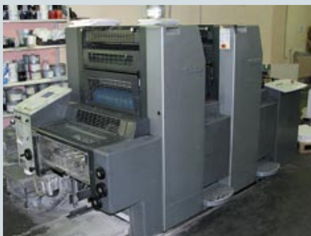
Двухкрасочный Heidelberg Speedmaster 52 используется в типографии уже несколько лет, и при этом прекрасно справляется со своими задачами. На нем печатают продукцию 1+1 либо используют для печати дополнительными красками Pantone или золото/серебро
