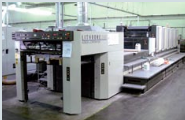
Печатный парк типографии «Инсайт Полиграфик» составляют печатные машины Komori Lithrone S40: четырехкрасочная для простых цветных работ (слева) и пятикрасочная с лаковой секцией (справа) для сложных заказов
