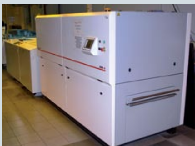
В ПК «Экстра М» используются устройства экспонирования пластин различных моделей, предназначенных и для экспонирования форм газетной печати, и пластин для журнального производства. Все устройства произведены компанией Agfa
