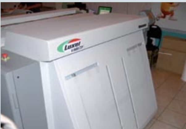
Печатные формы в типографии выводят на CTP-устройстве FujiFilm Luxel, а резка бумаги и готовой продукции происходит на резальном комплексе фирмы Perfecta
