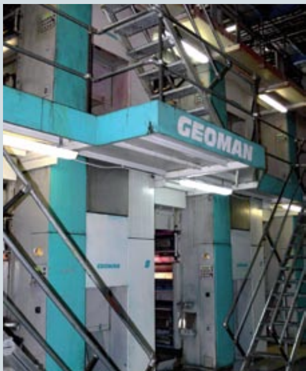
Печать газет проводится на печатном комплексе Geoman, состоящем из 8 печатных башен
