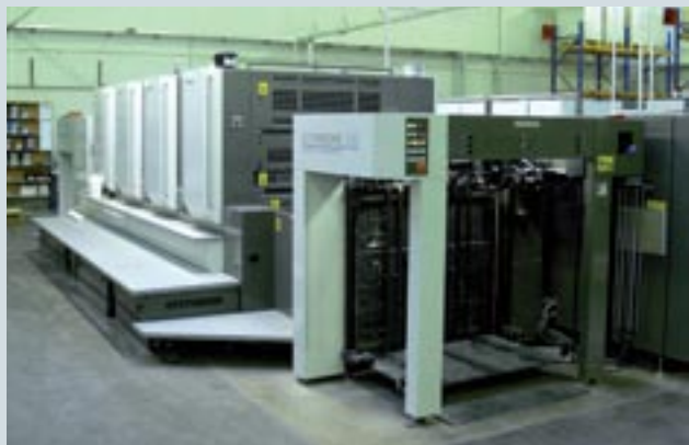
Печатный парк типографии «Инсайт Полиграфик» составляют печатные машины Komori Lithrone S40: четырехкрасочная для простых цветных работ (слева) и пятикрасочная с лаковой секцией (справа) для сложных заказов
