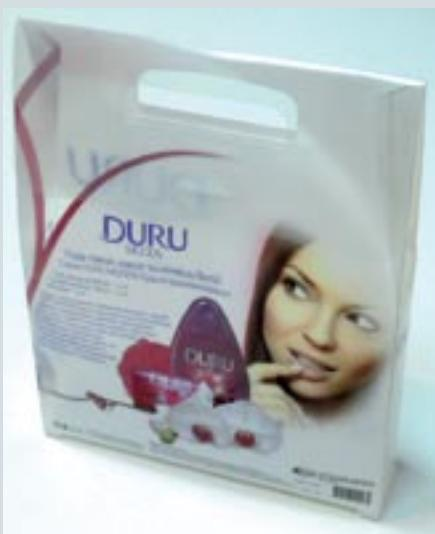
Печать на прозрачном пластике имеет определенные особенности: красочное изображение наносится на предварительно положенные белила, а затем покрывается лаком (выборочным или сплошным). Вырубка изделий из толстых полимерных материалов также требует специального подхода
