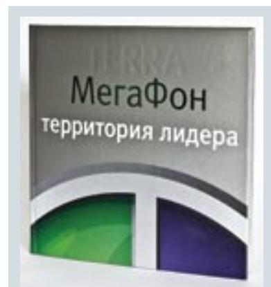
УФ-технология позволяет наносить изображения на переплетные материалы со сложной поверхностью, например, на серебристый «Балакрон»
