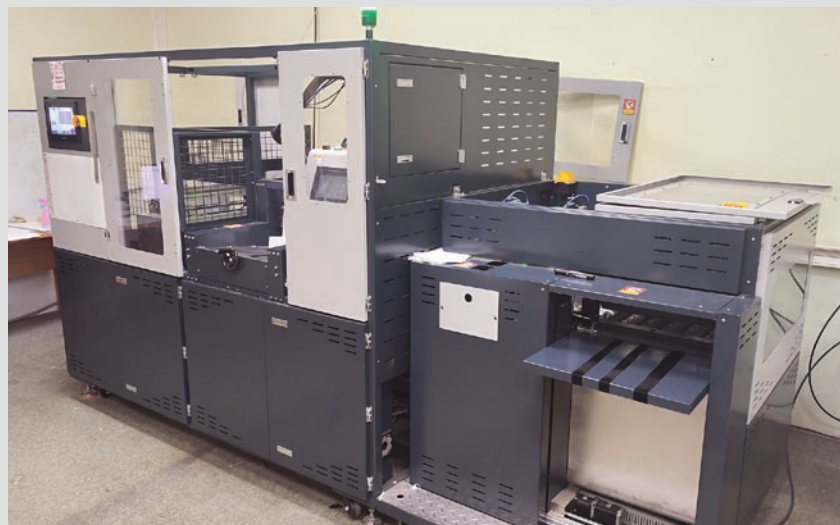
Машина для автоматической вставки блоков в переплетную крышку
