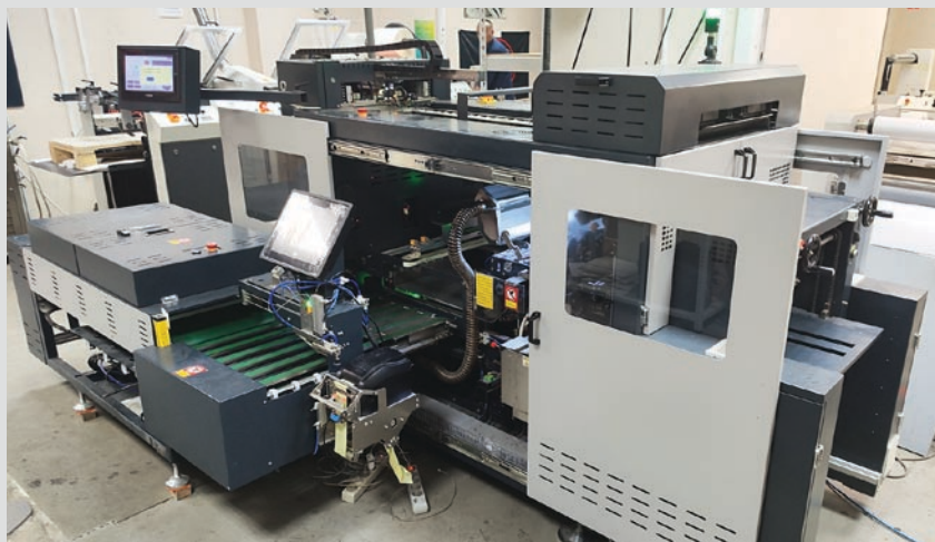
Машина для полистной склейки фотоальбомов «бабочкой»
