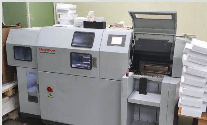
Машина автоматической трехсторонней обрезки книжных блоков с автоподачей и выкладом
