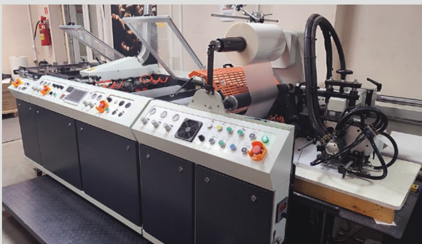
Новый промышленный ламинатор позволяет осуществлять фактурное тиснение
