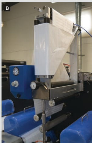
Новое приобретение типографии — восьмикрасочная флексографская печатная машина Label Source: а) модуль размотки, выравнивания и подготовки полотна, б) модуль ротационной высечки, в) модуль деламинации/ламинации и переворота полотна, г) модуль холодного тиснения фольгой
