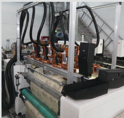
Цифровая печатная машина для нанесения переменной информации и Data Matrix кодов
