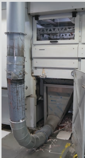
Все прессы для высадки и другое оборудование подключены трубопроводами к системе аспирации компании Hunkeler Systeme: отходы собираются, удаляются и прессуются автоматически
