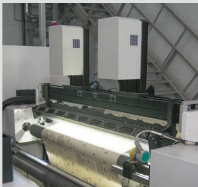
Цифровая печатная машина для нанесения переменной информации и Data Matrix кодов
