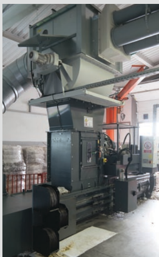
Все прессы для высадки и другое оборудование подключены трубопроводами к системе аспирации компании Hunkeler Systeme: отходы собираются, удаляются и прессуются автоматически
