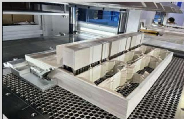
Вверху: общий вид машины KYD-1080A компании Kuaiyida. Внизу: слева — система штырей нижней плиты, выталкивающих заготовки из листа, справа — механизм «рядного» извлечения заготовок.
