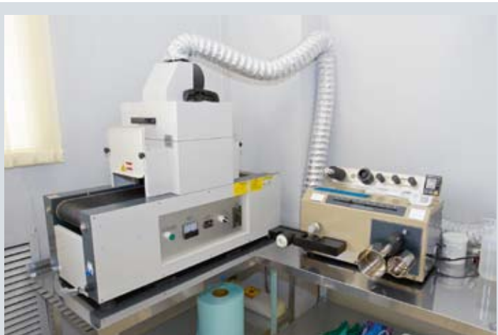
Пробопечатный станок и УФ-сушка для изготовления выкрасок УФ-отверждаемых красок
