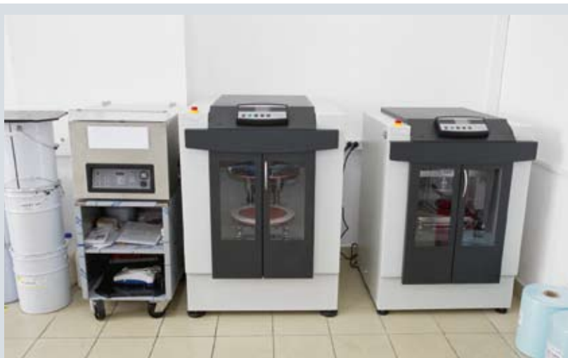
Гироскопические миксеры для перемешивания смешанной краски и вакуумный упаковщик, улучшающий качество упаковки банки краски и повышающий срок ее хранения
