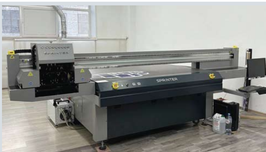
Недавно приобретенный промышленный УФ-принтер Sprinter TC-F2132 позволил существенно повысить оперативность, технологичность и экономичность изготовления вывесок
