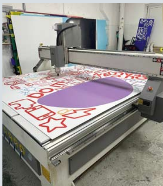
Для изготовления конструкций вывесок в «М4» используются фрезеровальные станки с цифровым управлением
