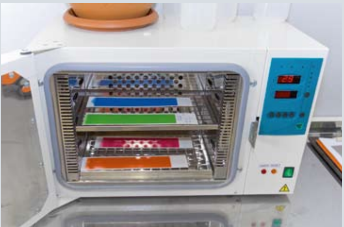
Специальный сушильный шкаф для ускоренной сушки образцов масляных красок
