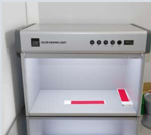
Просмотровый бокс с нормированным источником света для визуальной оценки образцов
