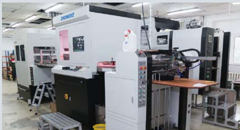
Комплекс для изготовления кашированных коробок компании Zhongke состоит из нескольких производственных модулей, связанных системой транспортеров
