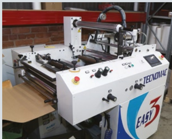
Автоматический ламинатор используется для изготовления фотокниг
