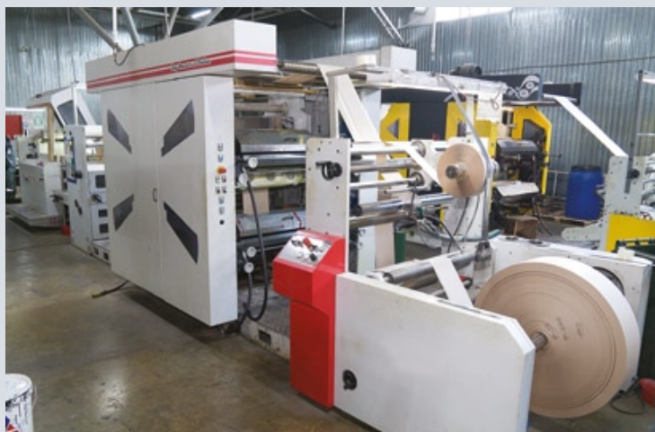
Бобинорезальное оборудование используется для разрезки широкого рулона бумаги на более узкие, ширина которых определяется форматом пакета
