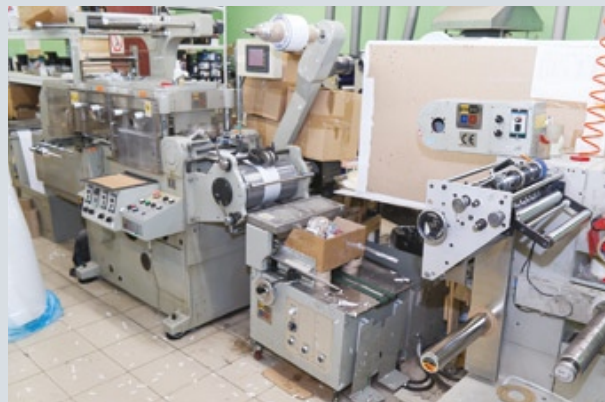
Линии Orthotec для промышленного производства самоклеящейся этикетки методом высокой и флексографской печати
