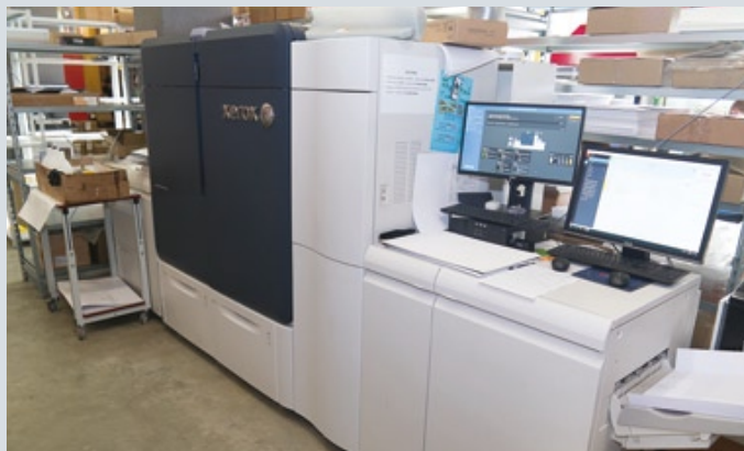
Парк цифрового оборудования типографии «Четыре цвета»: одна из самых длинных комплектаций Xerox iGen5 (слева) и Xerox Iridesse Production Press (справа) с возможностью печати дополнительными цветами — белым, прозрачным и металлизированными тонерами (серебро, золото)
