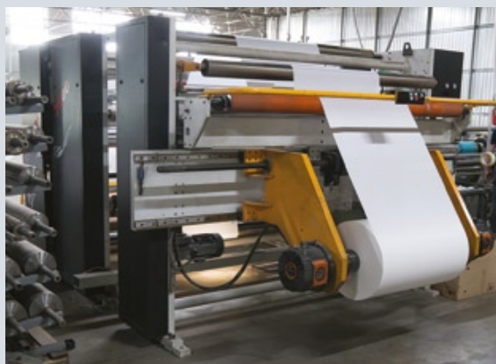
Бобинорезальное оборудование используется для разрезки широкого рулона бумаги на более узкие, ширина которых определяется форматом пакета
