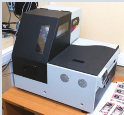
В принтерах VIPcolor реализована печать водными красками на основе технологии Memjet. В типографии используют их для печати малых тиражей этикетки с высоким разрешением на скорости до 18 м/мин
