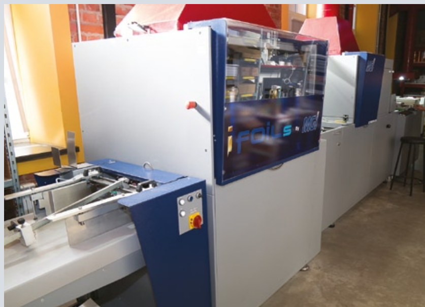
Оборудование MGI JetVarnish 3Ds Foil для цифровой декоративной отделки отрисовок фольгой и объемным лаком
