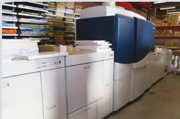
Парк цифрового оборудования типографии «Четыре цвета»: одна из самых длинных комплектаций Xerox iGen5 (слева) и Xerox Iridesse Production Press (справа) с возможностью печати дополнительными цветами — белым, прозрачным и металлизированными тонерами (серебро, золото)
