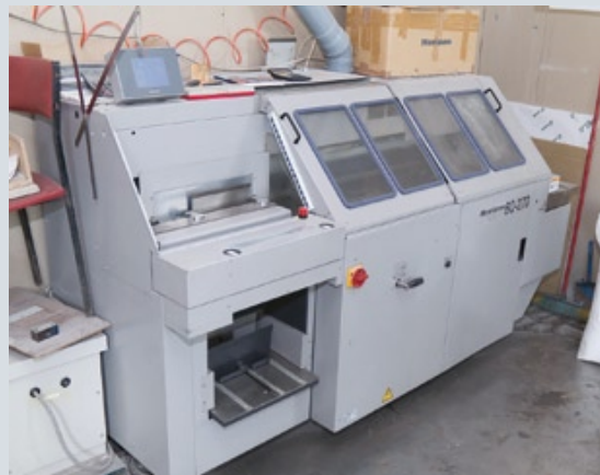
Линия для листоподборки и скрепления на скобу, а также машина для клеевого скрепления от компании Horizon
