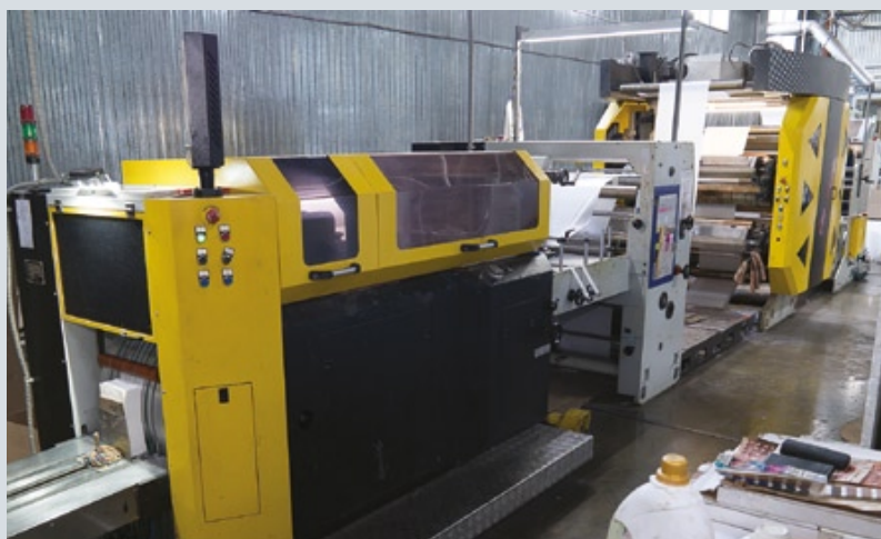
Оборудование для нарезки отпечатанных рулонов на листы. Используется при производстве оберточной бумаги для фастфуда
