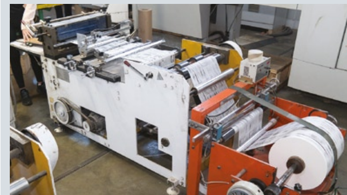
Оборудование для нарезки отпечатанных рулонов на листы. Используется при производстве оберточной бумаги для фастфуда
