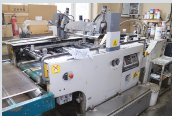
Трафаретная линия оснащена УФ-сушкой для работы с красками и лаками УФ-закрепления
