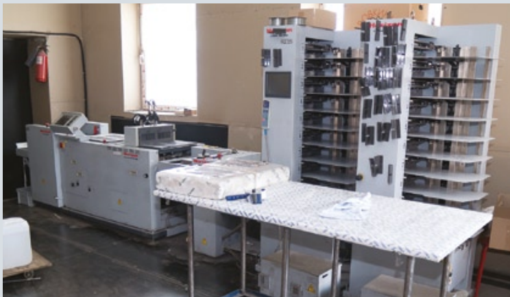
Линия для листоподборки и скрепления на скобу, а также машина для клеевого скрепления от компании Horizon
