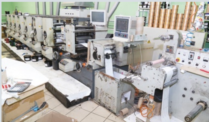
Линии Orthotec для промышленного производства самоклеящейся этикетки методом высокой и флексографской печати
