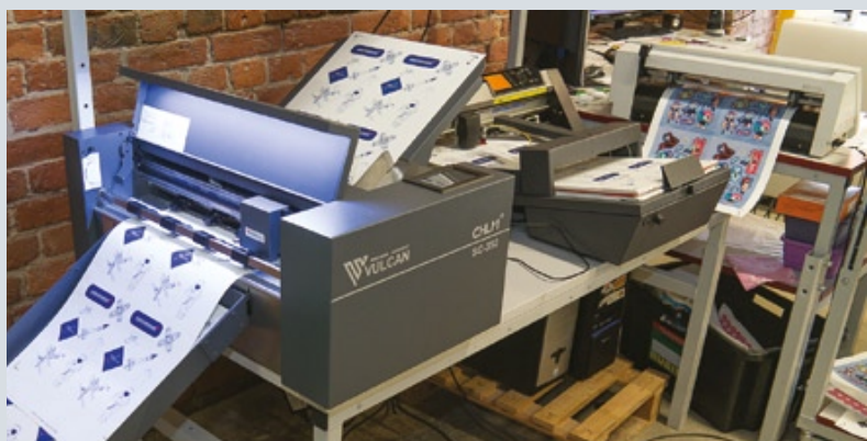
Компактный настольный режущий плоттер с листовой автоподачей для наклеек и этикеток
