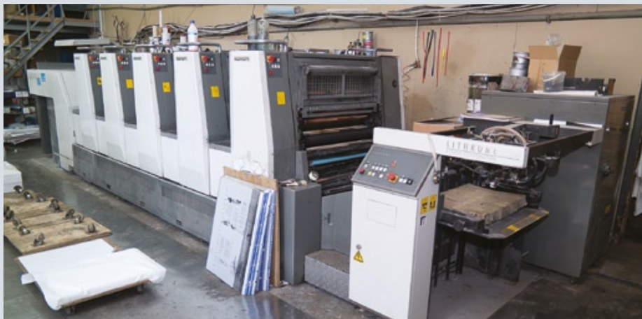
Офсетная пятикрасочная печатная машина Komori Lithrone LS-529 формата B2
