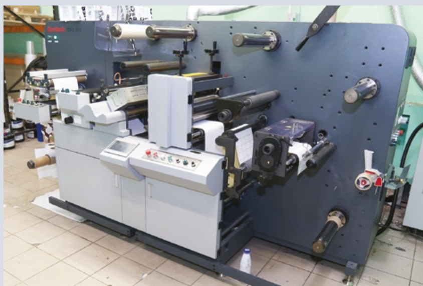
Отделочная этикеточная машина Eurotech CDFS 330 от китайского поставщика Brotech Digital Graphics инсталлирована в типографии «Тавро Плюс». Оборудование приобреталось для выполнения декоративной отделки цифровой этикетки. Машина оснащена флексографской ротационной печатной секцией с УФ-сушкой, системой для холодного тиснения фольгой и УФ-ламинации, а также блоком высечки
