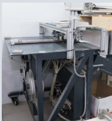
Комплекс послепечатного оборудования для производства будущих фотоальбомов: крышкоделательные машины, книгоставочное оборудование, машина клеевого бесшвейного скрепления блока
