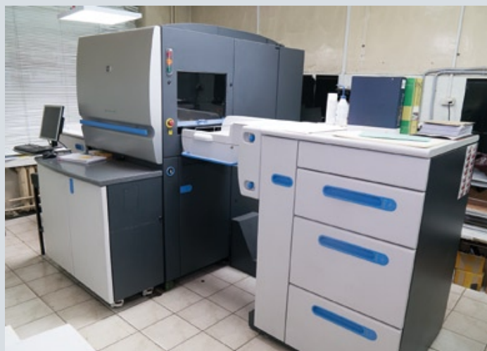
Цифровая печатная машина HP Indigo 5000 применяется в основном для производства малых тиражей, например, изготовления образцов продукции на тиражной бумаге для утверждения с заказчиком
