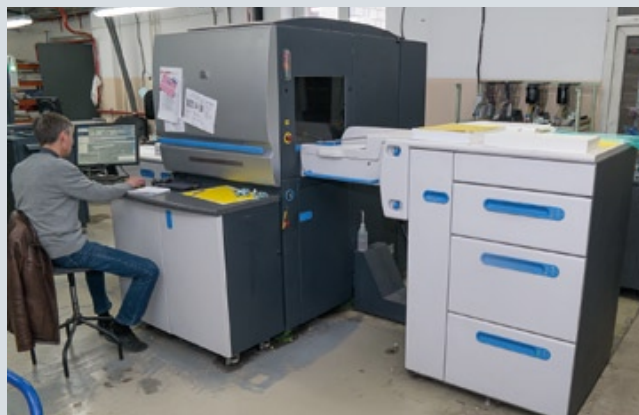
Основу цифрового печатного парка группы компаний FINEARTPRINT представляют машины HP Indigo 7600 и HP Indigo 5500, которые позволяют получать качество отпечатков, максимально приближенное к офсетному
