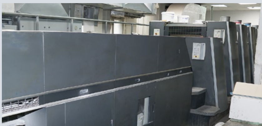
Пятикрасочная печатная машина Speedmaster CD 74 с секцией лакирования от компании Heidelberg
