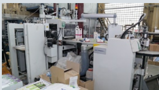
Часть оборудования для производства упаковки и POS-материалов: фальцевально-склеивающие линии, режущий плоттер, тигельный пресс для вырубки и тиснения
