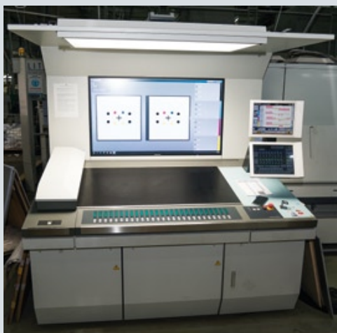
Новая восьмикрасочная печатная машина Komori Lithrone GL-837P формата 640x940 мм с устройством переворота листа и технологией H-UV стала одним из крупных инвестиционных проектов полиграфического комплекса «Буки Веди» в этом году
