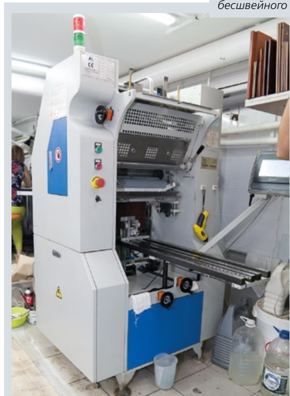
Машина Maufung MF-PF500 для скрепления фотоальбомов по технологии каширования lay-flat. Позволяет автоматически собирать блоки фотокниг
