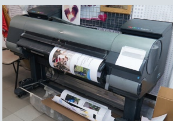
Оборудование широкоформатной печати Canon также активно применяется для изготовления продукции фотографического качества. Последующая резка на листы меньшего формата осуществляется с использованием специализированной резальной машины
