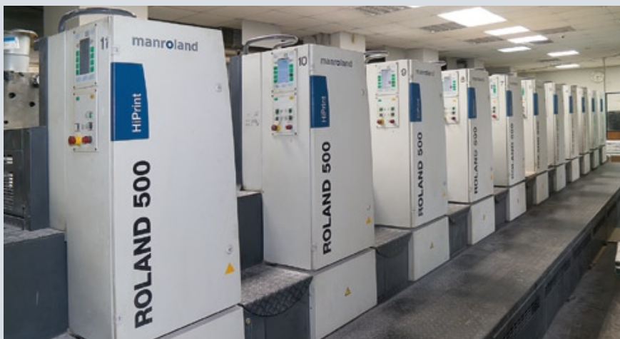
Основу печатного парка типографии «Альфа-Дизайн» составляют машины ведущих немецких производителей, в частности десятикрасочная машина Roland 500 с устройством переворота листа и секцией лакирования
