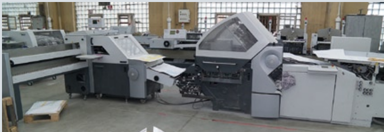
Промышленный комплекс оборудования для изготовления рекламной многоголосной продукции — ВШРА, листоподборочная линия, фальцевальные машины, линия КБС, оборудование для изготовления переплетных крышек
