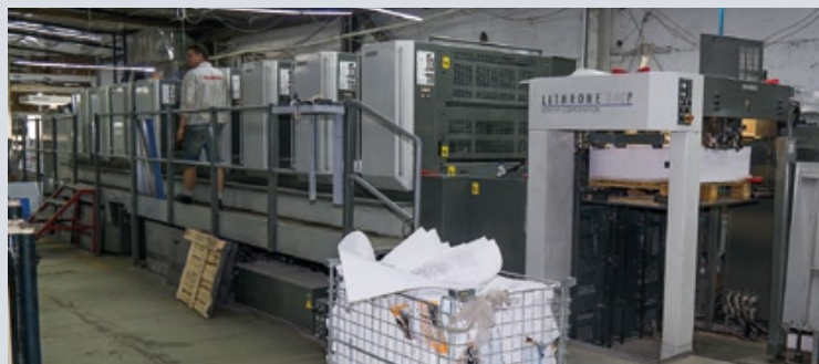
Восьмикрасочная печатная машина Komori LS840P с устройством переворота листа для многоцветных работ
