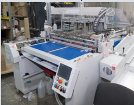
Промышленный комплекс оборудования для изготовления рекламной многоголосной продукции — ВШРА, листоподборочная линия, фальцевальные машины, линия КБС, оборудование для изготовления переплетных крышек
