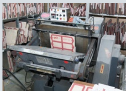
Часть оборудования для производства упаковки и POS-материалов: фальцевально-склеивающие линии, режущий плоттер, тигельный пресс для вырубки и тиснения
