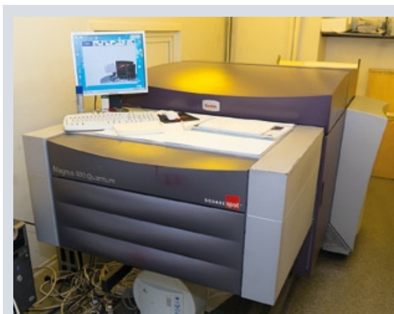
В типографии «Альфа-Дизайн» применяют беспроцессную технологию на основе решений Kodak: устройства Kodak Magnus 400 Quantum и пластин Sonora X
