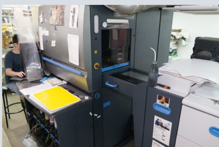
Цифровая печатная машина HP Indigo Press 5500 в семикрасочном исполнении. На ней в компании «Сэйко» ведется печать фотопродукции
