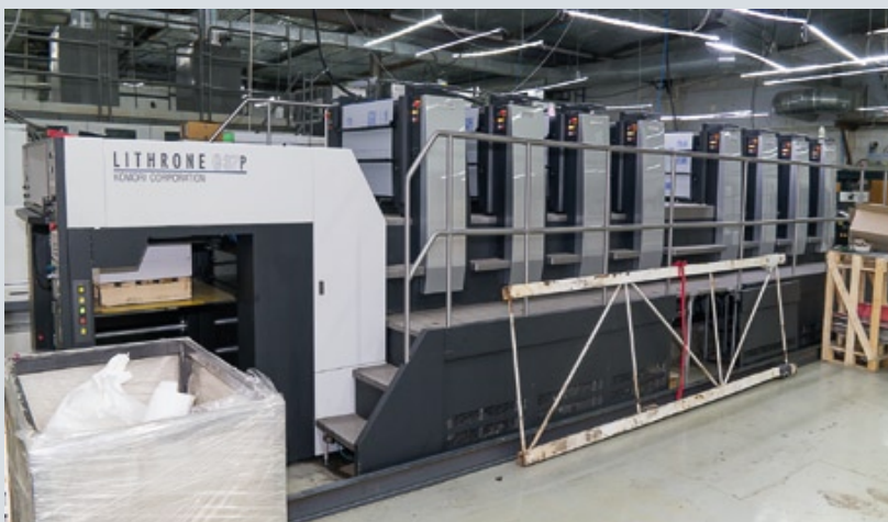
Новая восьмикрасочная печатная машина Komori Lithrone GL-837P формата 640x940 мм с устройством переворота листа и технологией H-UV стала одним из крупных инвестиционных проектов полиграфического комплекса «Буки Веди» в этом году
