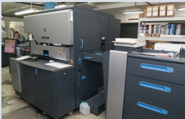
Основу цифрового печатного парка группы компаний FINEARTPRINT представляют машины HP Indigo 7600 и HP Indigo 5500, которые позволяют получать качество отпечатков, максимально приближенное к офсетному
