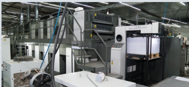
Двухуровневый перфектор Komori Lithrone 440 SP L+X одновременно запечатывает лист с обеих сторон, что повышает точность совмещения лица и оборота и позволяет стабильно работать на высоких скоростях
