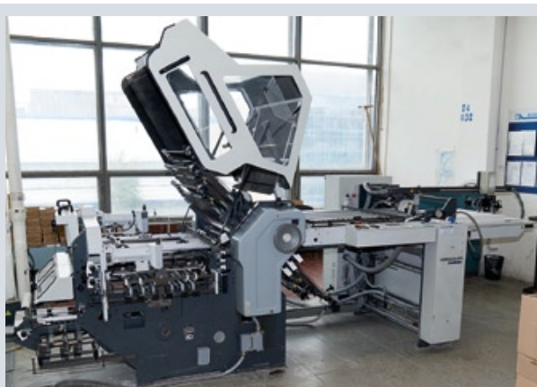
Для производства листовой продукции был подобран комплекс для финишной обработки — фальцевальное устройство Heidelberg Stahlfolder и несколько единиц резального оборудования Polar
