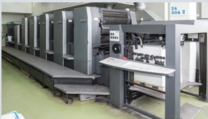
Установка на предприятии пятикрасочной листовой печатной машины Heidelberg Speedmaster SM102 с секцией лакирования стала шагом в процессе серьезной модернизации производства
