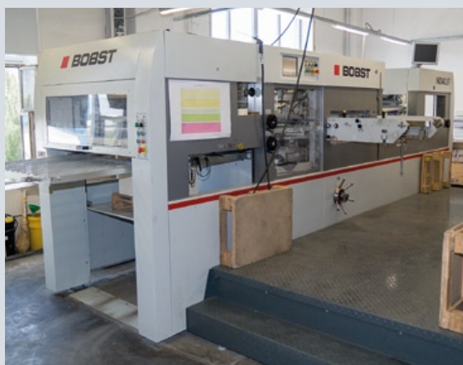
Обновленный комплекс послепечатного оборудования от ведущего производителя в области работы с картоном компании Bobst — высекальный пресс NovaCut 106E и фальцевально-склеивающая линия ExpertFold 80A2. «Печатный Дом Ависс» отмечает преимущества современного оборудования в плане удобства и автоматизации процессов вырубки картонных заготовок, а также фальцовки и склейки коробок
