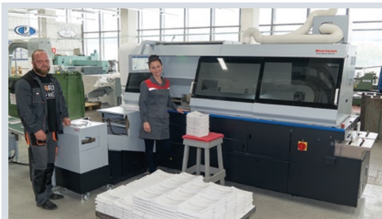
В июне этого года на предприятии установили послепечатный комплекс от компании Horizon, состоящий из четырехкареточной машины бесшвейного скрепления BQ-480, транспортера и трехножевой бумагорезательной машины NT80. Оборудование установлено в линию, что заметно повысило производственный процесс. Благодаря новому оборудованию типография «Двор печатный АВТОВАЗ» решила задачу производства объемных руководств и инструкций по эксплуатации, которые в обязательном порядке прилагаются в комплекте к каждому автомобилю. Кроме того, предприятие получило возможность эффективного изготовления малотиражных изданий с более качественным термоклеевым скреплением
