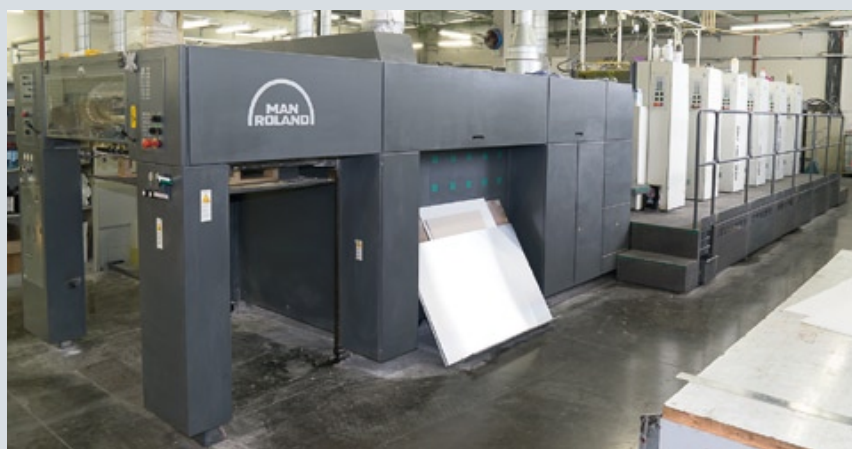
Две пятикрасочные листовые печатные машины Roland 705 LV, оснащенные секцией лакирования, применяются на ППК для печати обложек, рекламных вставок и вклеек, а также рекламно-представительской продукции и небольших тиражей журналов
