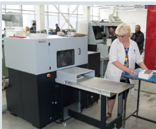
В июне этого года на предприятии установили послепечатный комплекс от компании Horizon, состоящий из четырехкареточной машины бесшвейного скрепления BQ-480, транспортера и трехножевой бумагорезательной машины NT80. Оборудование установлено в линию, что заметно повысило производственный процесс. Благодаря новому оборудованию типография «Двор печатный АВТОВАЗ» решила задачу производства объемных руководств и инструкций по эксплуатации, которые в обязательном порядке прилагаются в комплекте к каждому автомобилю. Кроме того, предприятие получило возможность эффективного изготовления малотиражных изданий с более качественным термоклеевым скреплением
