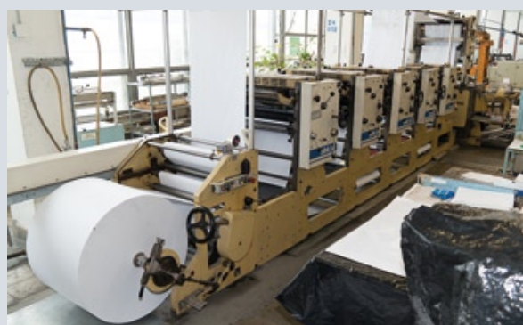
Одна из последних новых рулонных печатных машин — полноцветная Concepta от Muller Martini
