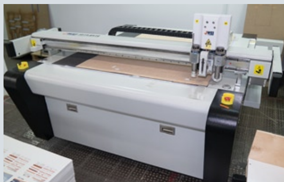
Режущий плоттер применяется для раскроя картонных коробок
