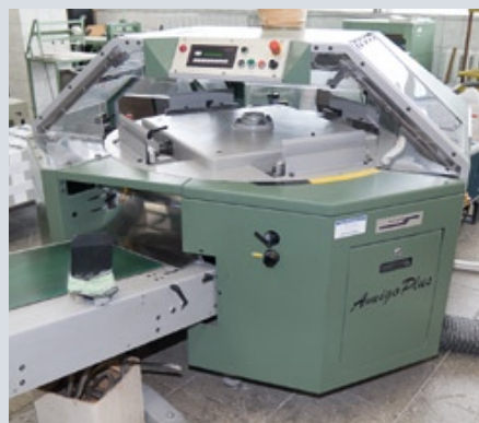
Вкладочно-швейно-резальный агрегат Muller Martini и устройство для бесшвейного скрепления Muller Martini Amigo Plus позволили типографии выпускать высококачественные рекламные проспекты со скреплением на скобу, а также многополосные каталоги с термоклеевым скреплением
