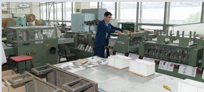
Вкладочно-швейно-резальный агрегат Muller Martini и устройство для бесшвейного скрепления Muller Martini Amigo Plus позволили типографии выпускать высококачественные рекламные проспекты со скреплением на скобу, а также многополосные каталоги с термоклеевым скреплением
