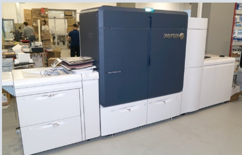
В компании «Технологии рекламы» недавно установлена новая цифровая печатная машина Xerox Iridesse Production Press, позволяющая выполнять отделку цифровых отпечатков
