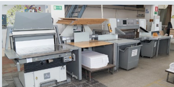
Для производства листовой продукции был подобран комплекс для финишной обработки — фальцевальное устройство Heidelberg Stahlfolder и несколько единиц резального оборудования Polar
