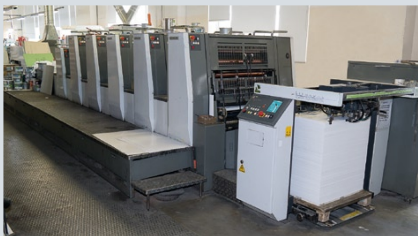
Производительность пятикрасочной печатной машины Komori Lithrone с секцией ВД-лакирования в полной мере обеспечивает потребность в печати полуфабрикатов для последующего изготовления картонной упаковки
