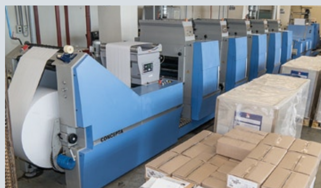
Одна из последних новых рулонных печатных машин — полноцветная Concepta от Muller Martini
