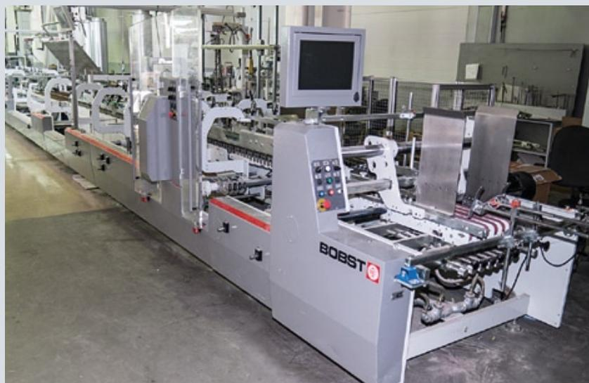
*«Европринт» был первой типографией в России в которой была установлена флагманская модель фальцеально-склеивающих линий Masterfold с возможностью поворота заготовки на 90° и склейки в один прогон сложных коробок*
