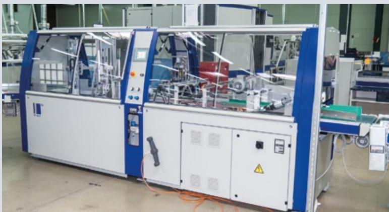
Новая книжная линия Kolbus состоит из агрегата клеевого бесшвейного скрепления KM412 (вверху), блокообработывающей и вставочной линии KM530 (в центре), стекера DS и других единиц. Но фото справа вверху: модуль бесшвейного агрегата, который используется для оклейки шитых нитками блоков
