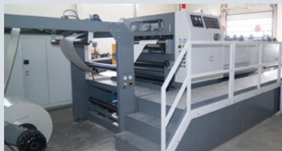
В «Европринте» есть и собственное бобинорезальное оборудование для размотки фольги для тиснения и флаторезальная машина для рулонного картона
