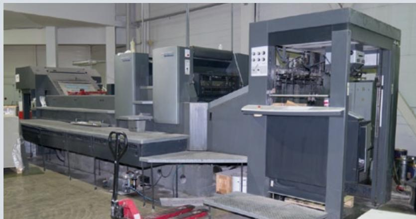
*Специальная лакировальная машина для нанесения сложных видов лака построена на базе лакировальных модулей Heidelberg Speedmaster*
