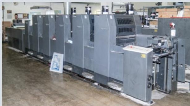
На Heidelberg Speedmaster SM52 была установлена LED-UV-сушка от AMS для отладки технологии
