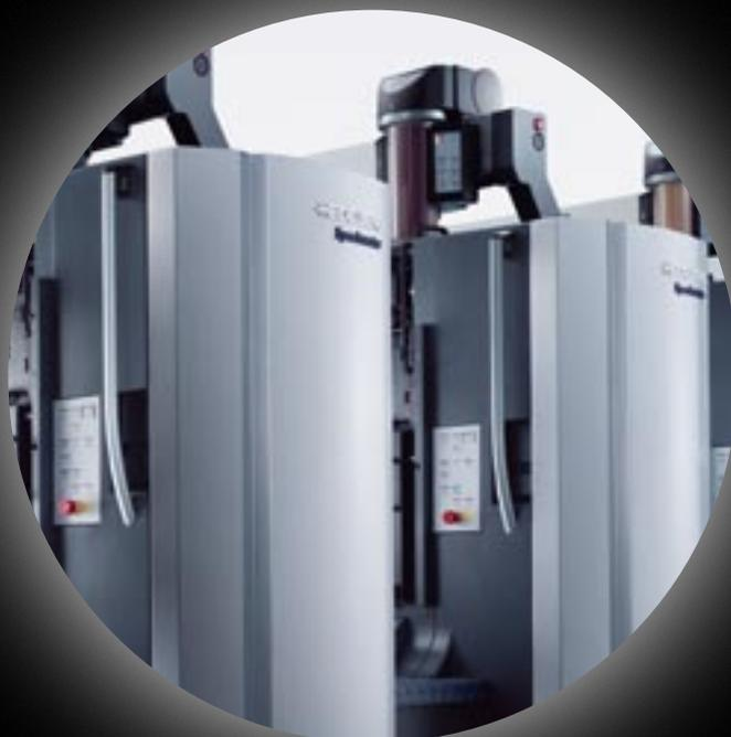
Инновации рождают инновации. Печатная машина Heidelberg Speedmaster CX 102 объединяет передовые решения серии Speedmaster XL и модели Speedmaster CD 102. Результат – снижение временных затрат на переналадку и производственная скорость 16 500 оттисков в час, что идеально соответствует требованиям рынка.
