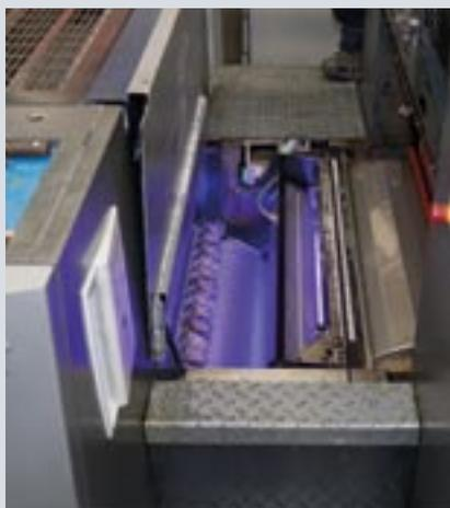
LED-UV-сушка, установленная после последней секции в печатной машине перед лакировальной секцией
