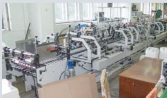
Формирование коробок проводится на фальцевально-склеивающих машинах, способных склеивать коробки, содержащие до шести точек
