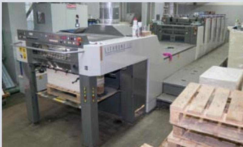
Основу печатного парка типографии «Дельта-Принт» составляют две печатные машины: подготовленный под УФ-печать manroland 505 и установленная позже машина для печати масляными офсетными красками Komori Lithrone S529L
