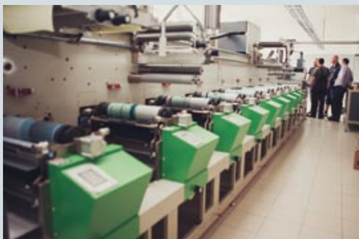
В начале августа на производственной площадке «ИПФ «Воронеж» была инсталлирована девятикрасочная узкорулонная флексографская машина GiDue Combat M5. Таким образом, типография начала освоение нового для себя направления по изготовлению самоклеящейся этикетки и гибкой упаковки
