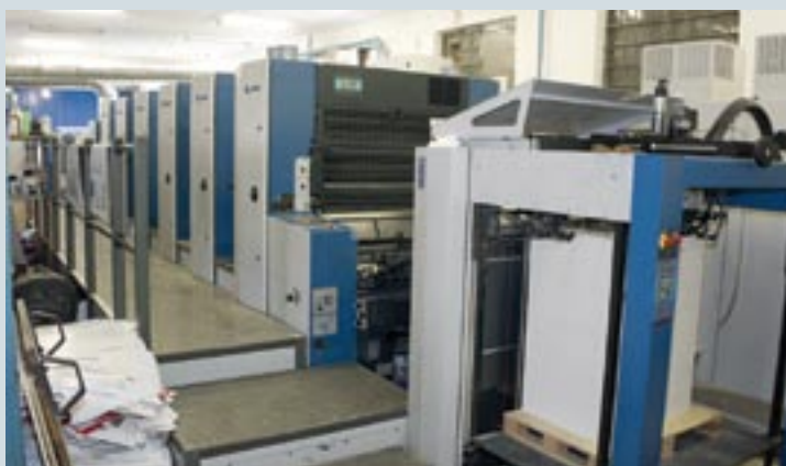
Шестикрасочная печатная машина KBA Rapida 105-6+L с секцией ВД-лакирования оснащена пакетом для тонких от 45 г/м 2 и для толстых бумаг до 1,2 мм, что в действительности делает ее универсальной, подходящей для выполнения большого ассортимента полиграфических работ — от упаковки до книжно-журнальной и рекламной продукции. Для вывода офсетных форм для этой машины используется редкое в нашей стране CtP-устройство XPose! 230 UV от компании Luescher
