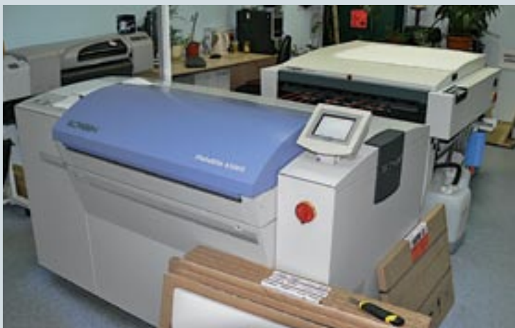
Качеству допечатной подготовки в типографии уделяют повышенное внимание. В 2008 г. на предприятии установлен CtP-комплекс PlateRite 4300S для изготовления офсетных печатных форм, благодаря которому стало возможным получать высочайшее качество конечной продукции
