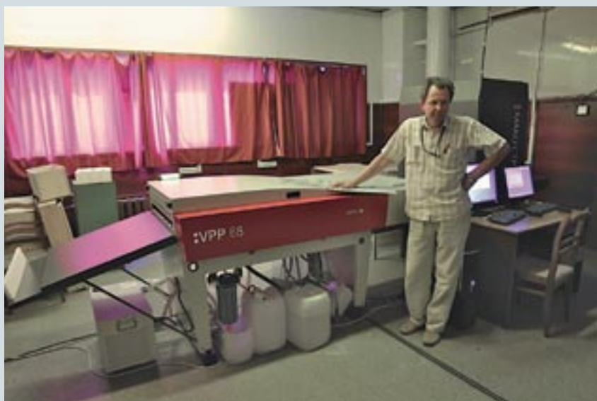
В мае этого года «ИПФ «Воронеж» приобрела у компании «Терем» вторую СтР-систему ECRM Maiko 400 с проявочным онлайн-процессором Agfa :VPP68. Тем самым типография увеличила производительность допечатного участка и предусмотрела дублирование систем для изготовления офсетных печатных форм. На фото: Сергей Казбан, начальник отдела допечатной подготовки типографии
