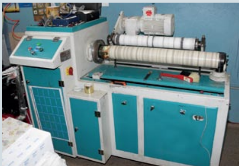
Производственные мощности компании «Синержи» позволяют изготавливать до 150 тыс. тубусов в месяц при работе в одну смену. Здесь установлено оборудование для приклейки этикетки к тубусу и завальцовки дна
