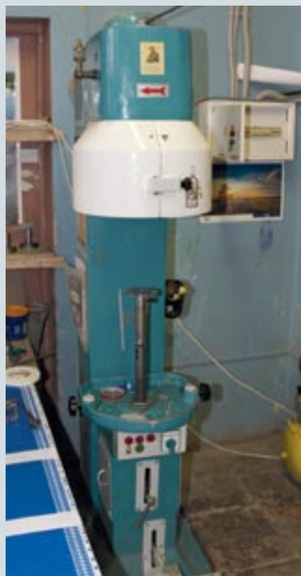
Производственные мощности компании «Синержи» позволяют изготавливать до 150 тыс. тубусов в месяц при работе в одну смену. Здесь установлено оборудование для приклейки этикетки к тубусу и завальцовки дна
