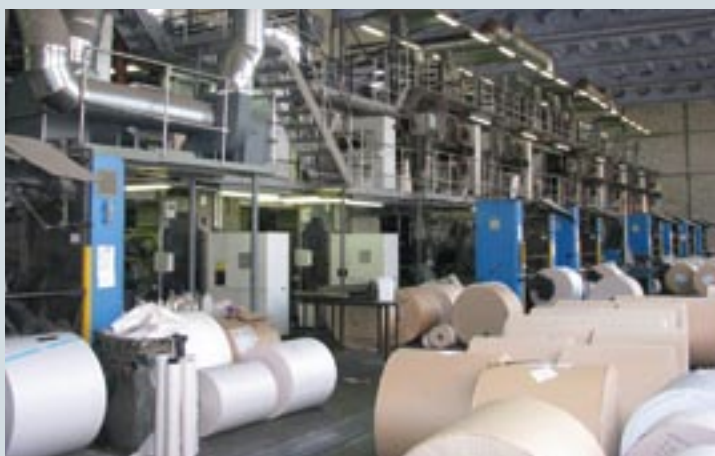
Основные рабочие печатные машины типографского комплекса «Девиз»: восьмибашенная газетная машина с воздушной сушкой Goss Universal 70 и машина с газовой сушкой KBA Compacta S80
