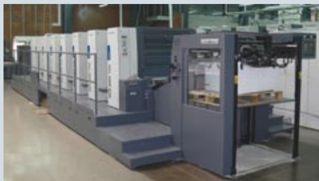
Основу печатного парка типографии составляют машины manroland, в том числе машины большого формата 140x100 см (слева). Недавно установлена восьмикрасочная машина формата 100x70 см для одновременной печати лица и оборота листа
