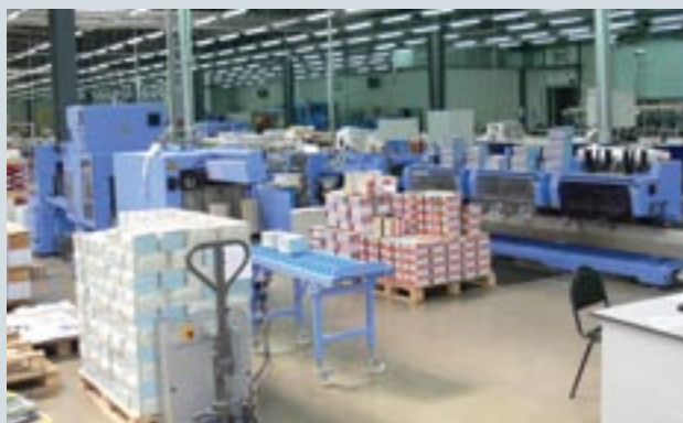
Для производства изданий в мягкой обложке и брошюр на скосе используется линия бесшовного скрепления (слева) и вкладочно-швейно-резальный агрегат (справа), поставленные Muller Martini
