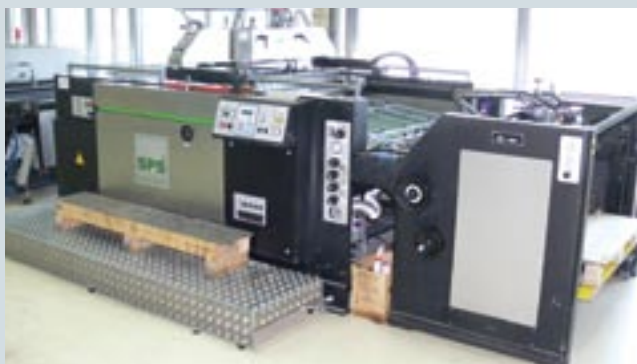
Помимо офсета, используется и трафаретная печать, например, для лакирования обложек и печати на переплетных материалах
