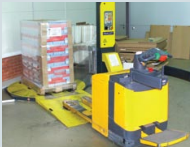
Подготовка палет к транспортировке автоматизирована. Упаковка готовых палет — европейская, с защитными углами
