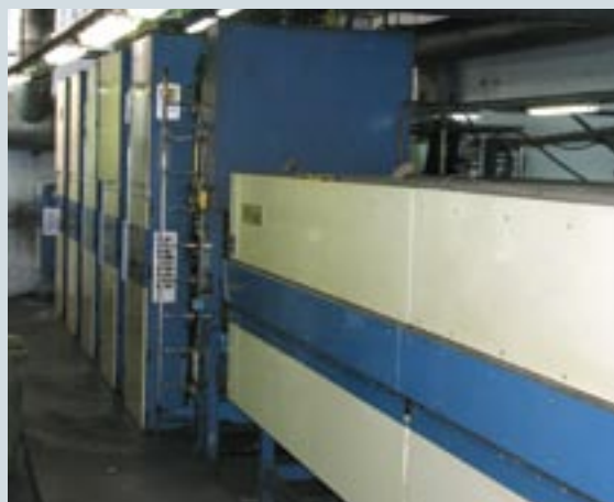
Основные рабочие печатные машины типографского комплекса «Девиз»: восьмибашенная газетная машина с воздушной сушкой Goss Universal 70 и машина с газовой сушкой KBA Compacta S80
