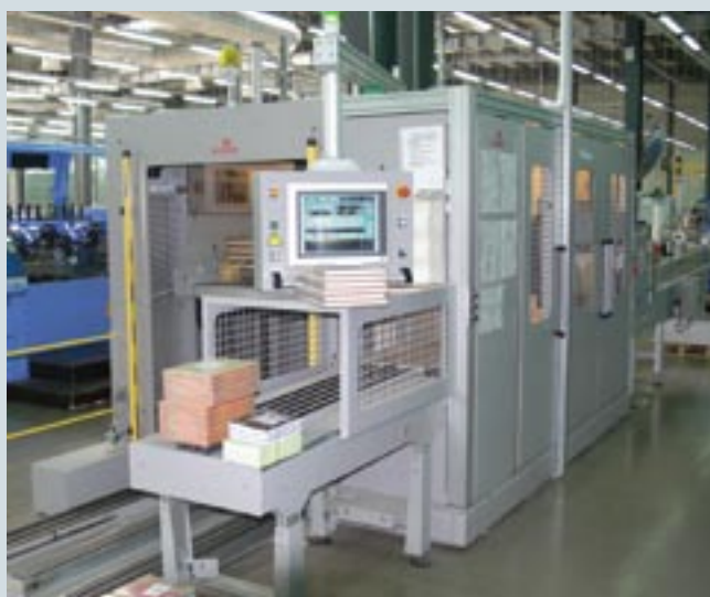
Подготовка палет к транспортировке автоматизирована. Упаковка готовых палет — европейская, с защитными углами
