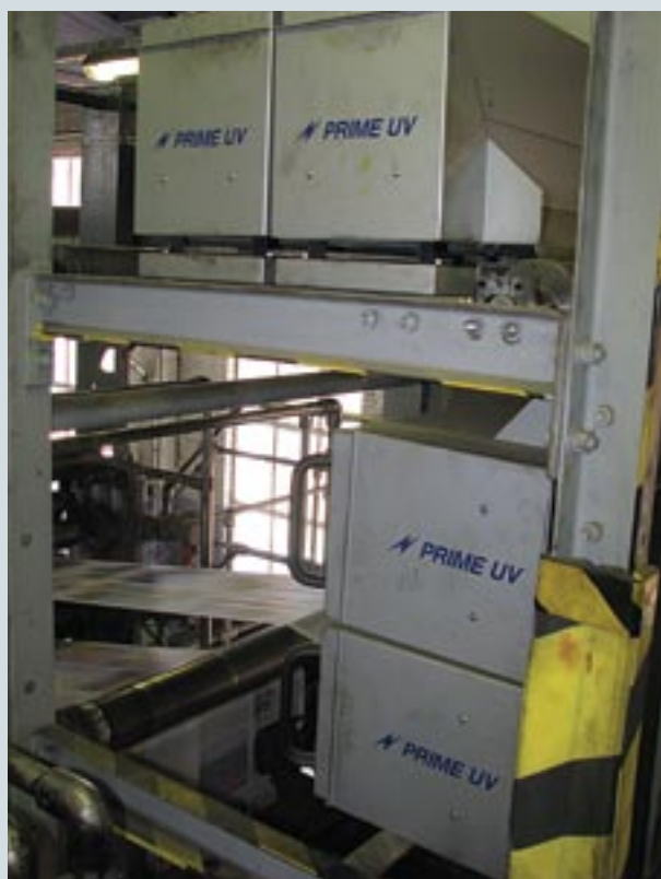
На одну из башен газетной печатной машины Goss Universal 70 недавно было установлено УФ-сушильное устройство
