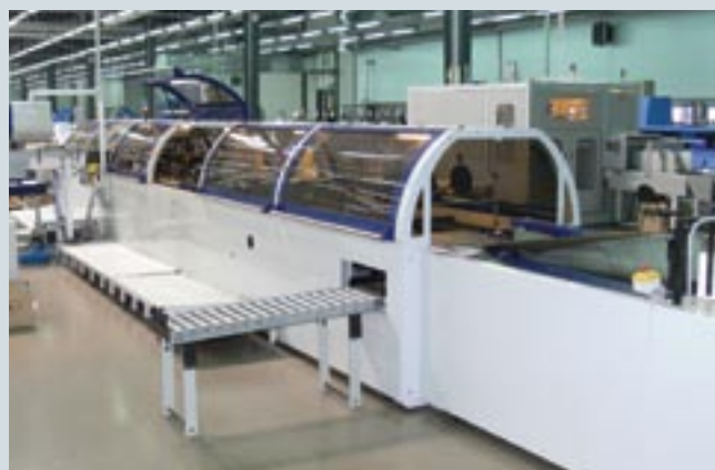
После шитья книжные блоки поступают на блокообработывающие книжные линии: Muller Martini Diamant (вверху) и Kolbus (внизу)
