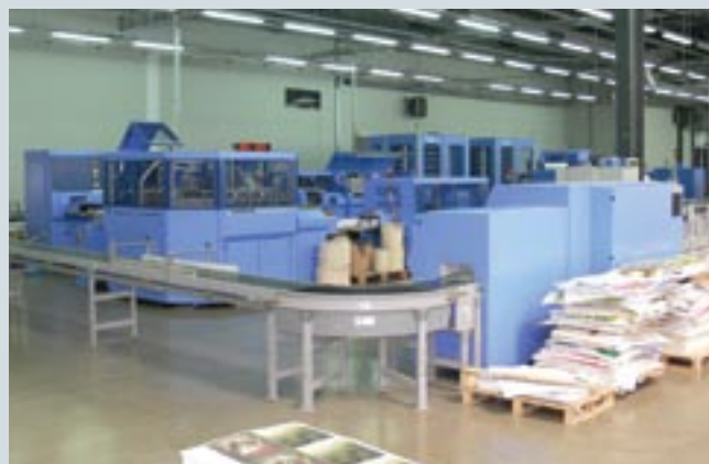
Для шитья книжных блоков используются ниткошвейные линии, которые автоматически подбирают тетради в комплект и подают их на шитье сразу на несколько ниткошвейных машин. Вверху: линия Muller Martini, внизу — Meccanotecnica
