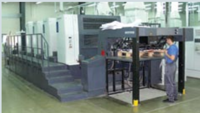
Основу печатного парка типографии составляют машины manroland, в том числе машины большого формата 140x100 см (слева). Недавно установлена восьмикрасочная машина формата 100x70 см для одновременной печати лица и оборота листа
