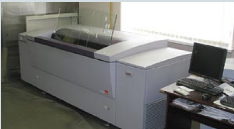
Формы изготавливаются на современных системах CtP. В типографии их установлено несколько — для повышения скорости вывода в пиковый период
