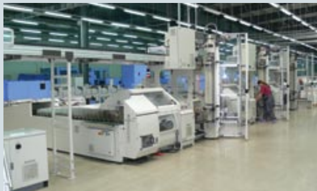
Для шитья книжных блоков используются ниткошвейные линии, которые автоматически подбирают тетради в комплект и подают их на шитье сразу на несколько ниткошвейных машин. Вверху: линия Muller Martini, внизу — Meccanotecnica
