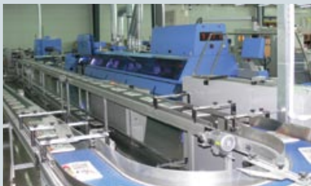
Для производства изданий в мягкой обложке и брошюр на скосе используется линия бесшовного скрепления (слева) и вкладочно-швейно-резальный агрегат (справа), поставленные Muller Martini
