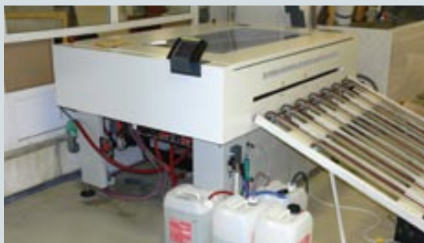
Новый высокоавтоматизированный процессор для пластин дозирует подкрепляющие растворы буквально миллилитрами, обеспечивая высочайшую стабильность проявления и экономию растворов
