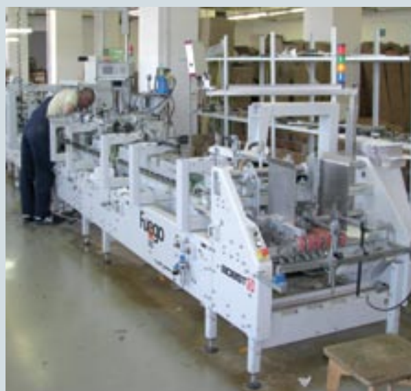
В типографии эксплуатируются две фальцевально-склеивающие линии производства компании Bobst, отличающиеся форматом и уровнем автоматизации
