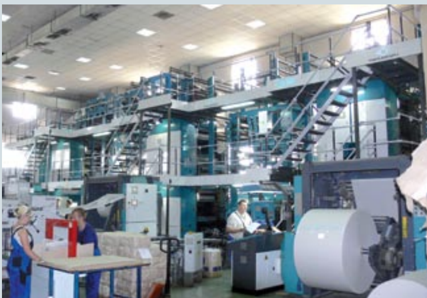
В настоящее время типография «ВМГ-Принт» эксплуатирует машину HiLine 45, состоящую из четырех башен 4+4 и двух фальцаппаратов, что позволяет при необходимости печатать две разные газеты одновременно
