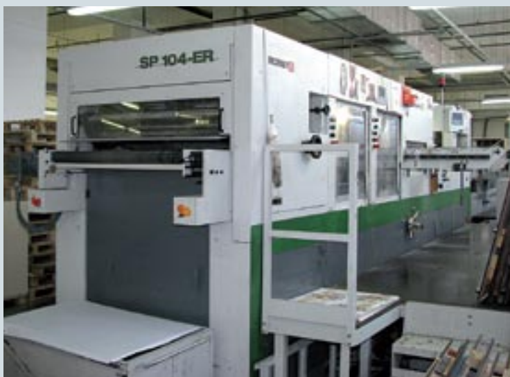
Вырубной пресс Bobst SP-104 ER, осуществляющий вырубку, удаление облоя и разделение заготовок. На правом рисунке показан стол равнения листа по изображению. Это дает возможность получать высочайшую точность вырубki даже очень сложных изделий
