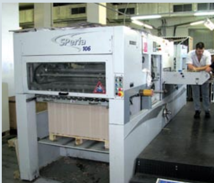
Вырубной пресс Bobst Speria 106 E — флагман линейки вырубных прессов «Московского центра упаковки». В типографии используются пресса со стальной загрузкой увеличенной высоты, что позволяет работать с картоном более экономично
