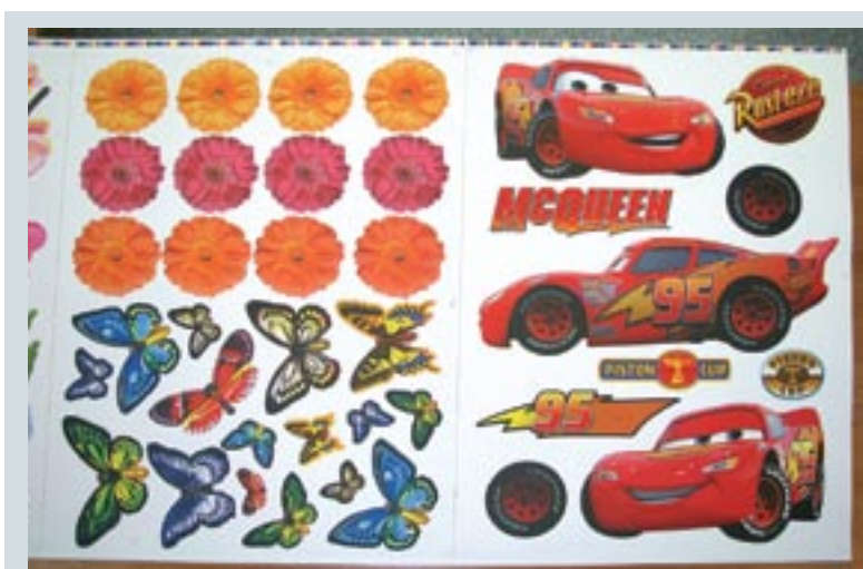
Для изготовления декоративных самоклеящихся этикеток большими листами требуются вырубные прессы с высочайшей точностью и равномерностью давления. Мельчайшая неравномерность приведет к сквозному прорубанию с одной стороны и «недорубки» с другой
