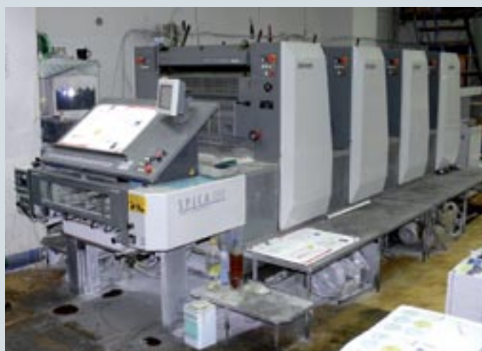
Четырехкрасочная машина с устройством переворота листа Komori Spica 26P самого маленького формата в модельном ряду
