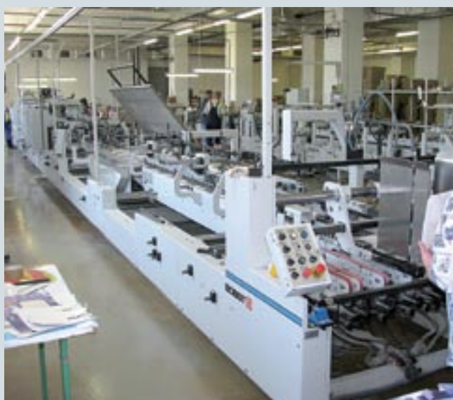
В типографии эксплуатируются две фальцевально-склеивающие линии производства компании Bobst, отличающиеся форматом и уровнем автоматизации
