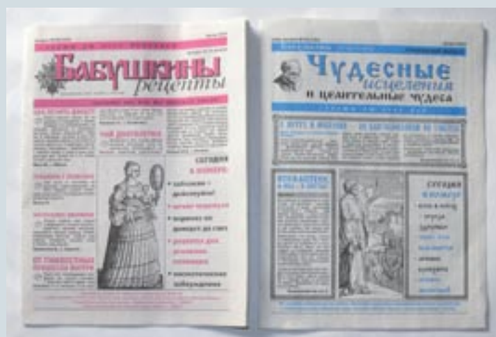
Благодаря наличию устройства дополнительного фальца типография может эффективно изготавливать «псевдожурналы» формата А4 на газетной бумаге
