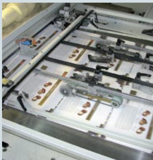
Вырубной пресс Bobst SP-104 ER, осуществляющий вырубку, удаление облоя и разделение заготовок. На правом рисунке показан стол равнения листа по изображению. Это дает возможность получать высочайшую точность вырубki даже очень сложных изделий
