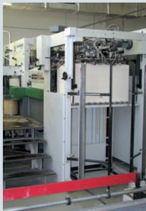
Вырубной пресс Bobst Speria 106 E — флагман линейки вырубных прессов «Московского центра упаковки». В типографии используются пресса со стальной загрузкой увеличенной высоты, что позволяет работать с картоном более экономично
