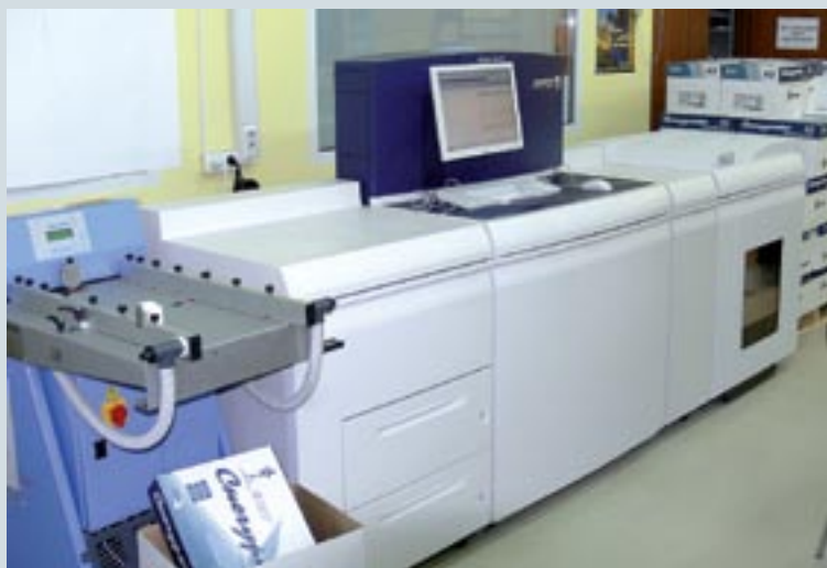
Черно-белые цифровые печатные машины, используемые в типографии «Вишневый пирог» для изготовления черно-белой печатной продукции. Слева — Xerox Nuvera 144EA, справа — Xerox 4112
