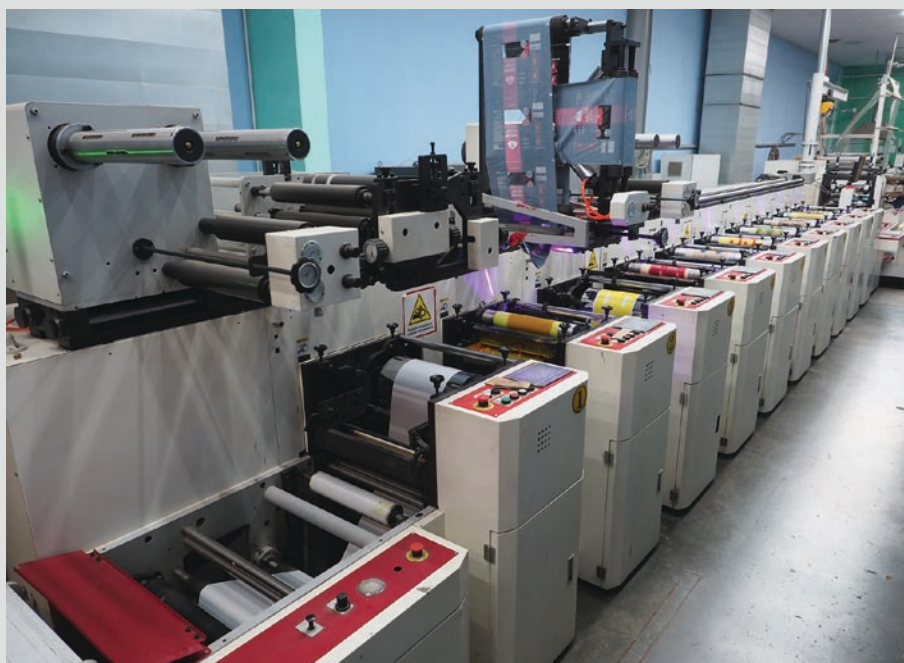
Узкорулонная десятикрасочная печатная машина DongHang DHF20350-10 уже несколько лет успешно работает в типографии
