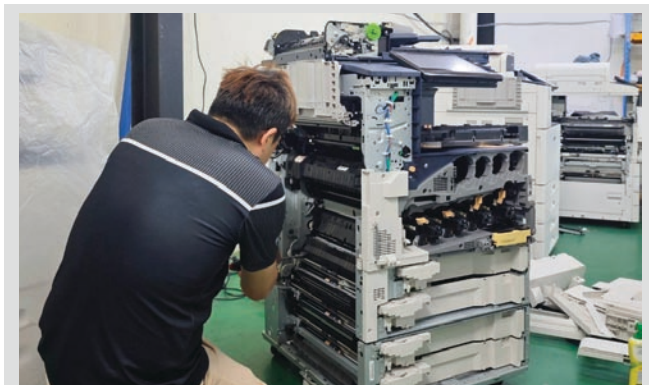
Профессиональное восстановление включает разборку, дефектовку и замену изношенных деталей новыми оригинальными
