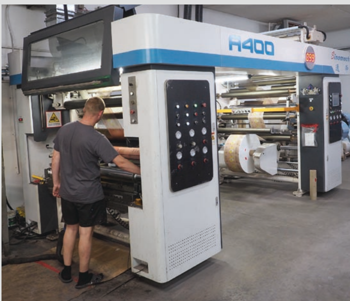
Промышленный ламинатор Sinomech
