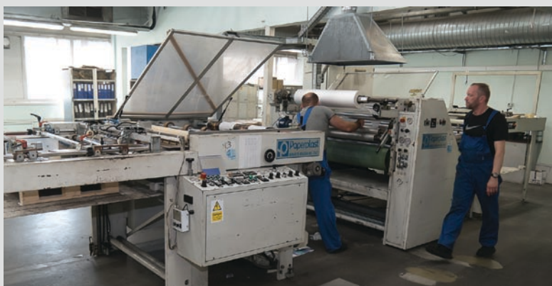
В типографии теперь есть ламинатор для ламинирования обложек журналов
