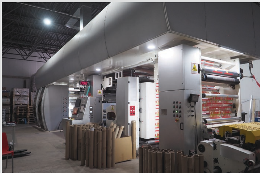
Новое приобретение типографии «Полифлекс» — восьмисекционная флексографская печатная машина с дополнительной печатной секцией DongHang DH-CI 1200-9
