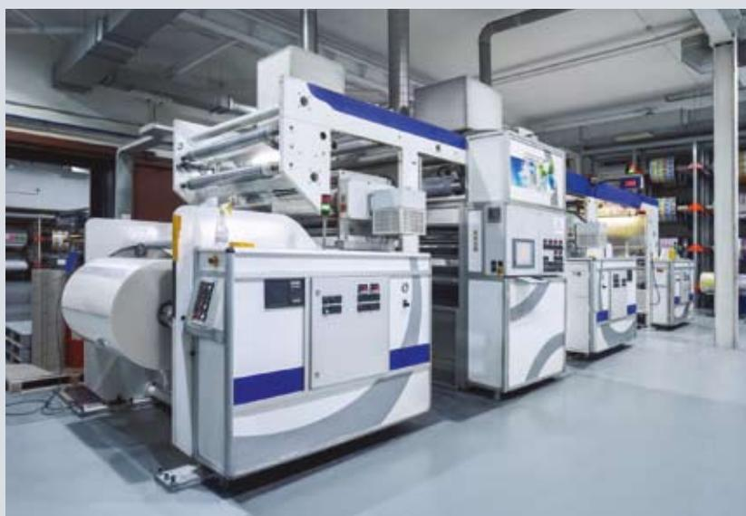
На производстве установлено большое количество различного послепечатного оборудования: сольвентные и бессольвентные ламинаторы, перемотчики, бобинорезки, машины для нанесения покрытий, устройства лазерной высечки и перфорации и т.д. Это позволяет типографии выпускать самые разные виды гибкой упаковки и полимерной этикетки
