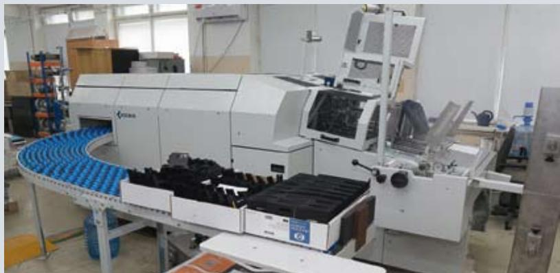
Специализированное оборудование для изготовления книг в твердом переплете: «цифровая» ниткошвейка и автоматическая машина для изготовления переплетных крышек
