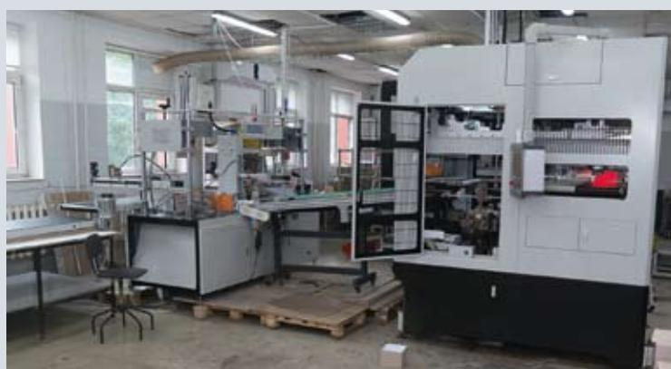
*В FineArtPrint используется большой парк специализированного оборудования для изготовления кашированных коробок, включая пазорезные станки, автоматический пресс для высечки и автоматизированная линия сборки и склейки оклейных жестких коробок. Его поставку осуществила компания «ПринтПак»*
