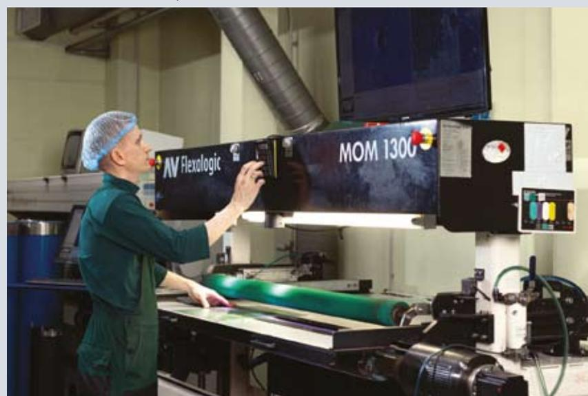
Система высокоточного монтажа печатных форм на формные гильзы
