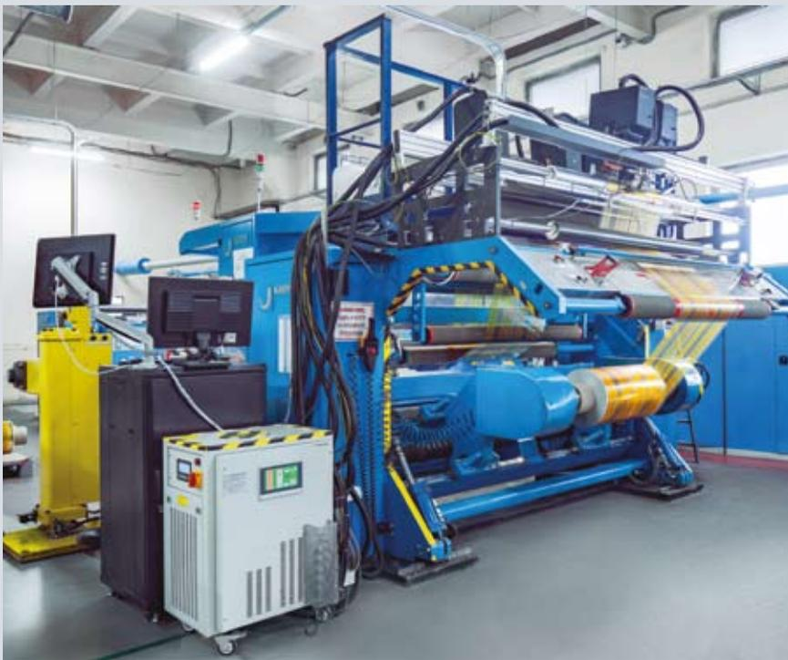
Одна из бобинорезальных машин оснащена цифровыми печатными головками для впечатавания переменных кодов «Честный знак»
