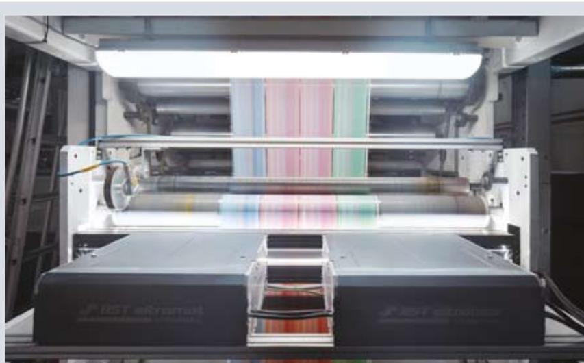
Качество печати контролируется встроенными системами видеоконтроля, работающими на полной скорости печатной машины
