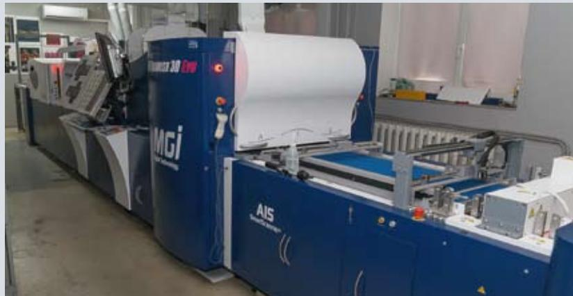
Отделка оттисков осуществляется промышленной системой для цифрового лакирования и тиснения фольгой большого формата
