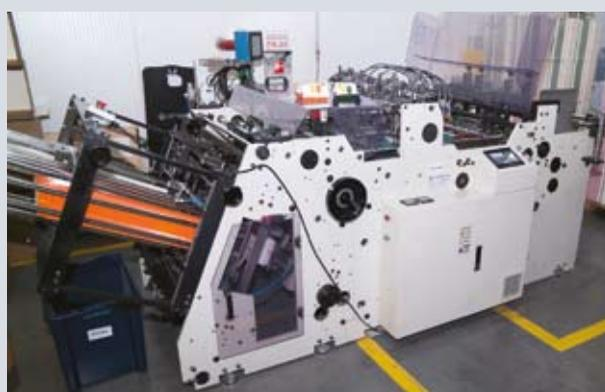
Отдельная лакировальная машина позволяет наносить УФ-лак с очень высоким качеством. В типографии есть также машина для изготовления бумажной посуды для сетей фастфуда
