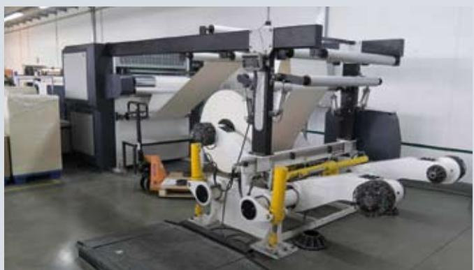
*Стоп-цилиндрическая машина используется для сложных видов тиснения, своя флаторезная машина для экономии картона*
