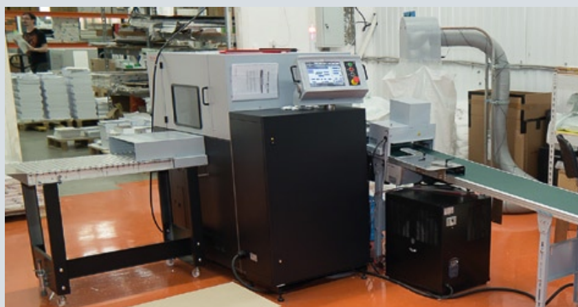
В линию с Horizon BQ-500 EVA смонтирована трехножевая бумагорезальная машина HT-80 для повышения скорости изготовления цифровых заказов малыми и сверхмалыми тиражами
