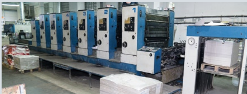
Офсетные листовые машины первого формата используются для печати на плотных материалах, а также лайнеров для производства кашированной упаковки
