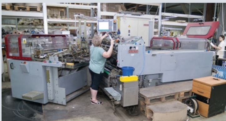
Крышкоделательная машина для изготовления переплетных крышек из картона до 2 мм формата А4 и А5
