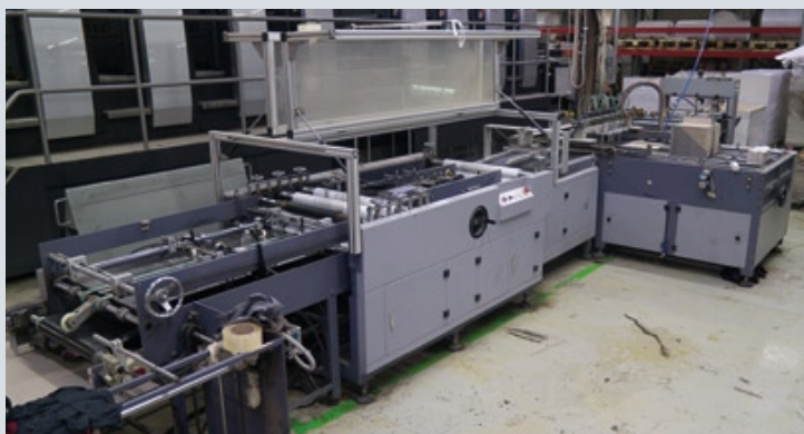
Еще одна крышкоделательная машина для изготовления переплетных крышек, в том числе альбомного формата, из картона до 3 мм, а также картона с поролоном
