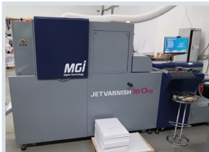
В прошлом году в OneBook была инсталлирована струйная машина для выборочного УФ-лакирования MGI JETvarnish 3D ONE
