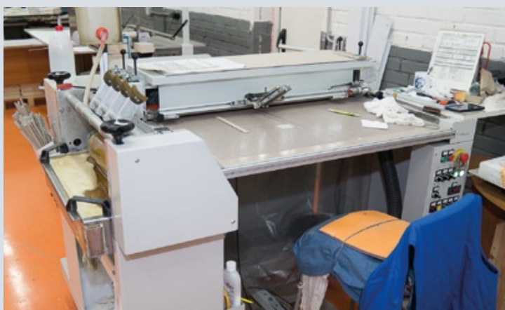
Крышкоделательное оборудование для изготовления твердого переплета и кашировки
