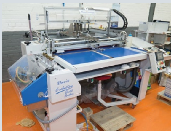
Полуавтоматическое устройство для изготовления переплетных крышек
