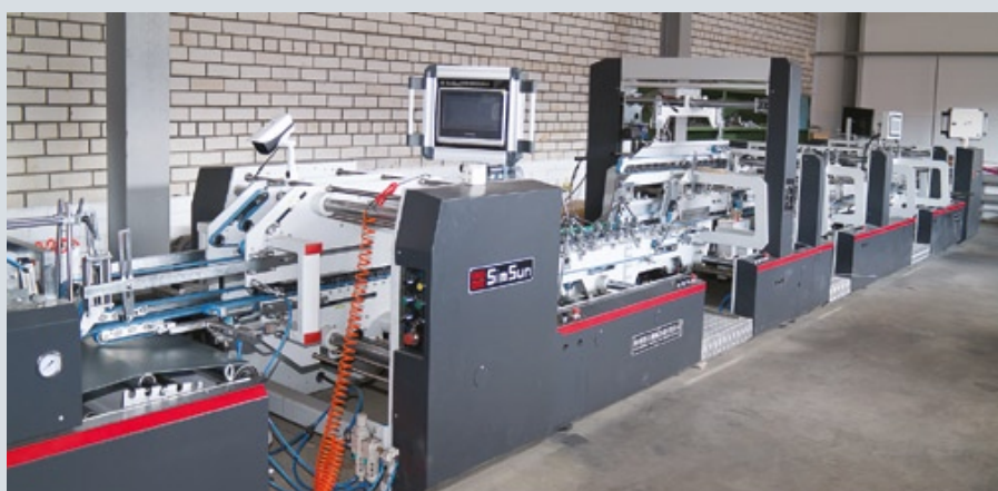
Фальцевально-склеивающая машина Vesta-90FC компании SimSun Machinery установлена в типографии «Магнус». Машина предназначена для производства коробок с 4 и 6 точками склейки из картона плотностью от 200 г/м 2 , а также из микрогофрокартона профилей E, F и N
