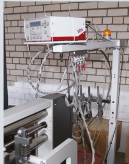
В дополнение к стандартной дисковой системе нанесения клея, машина оснащена электронной клеевой системой HHS с нанесением клея с помощью сопел
