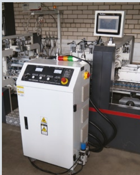
Передвижная установка для плазменной обработки. Позволяет работать с ламинированными и лакированными заготовками, а также листами пластика
