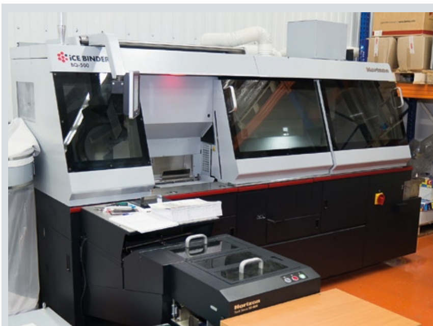
В типографии OneBook недавно была установлена четырехкареточная термоклеевая машина Horizon BQ-500 EVA для бесшвейного скрепления книжных блоков
