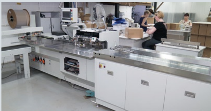
Автоматизированная линия для производства календарной продукции (навивка пружины, пробивка отверстий, накидывание ригеля)
