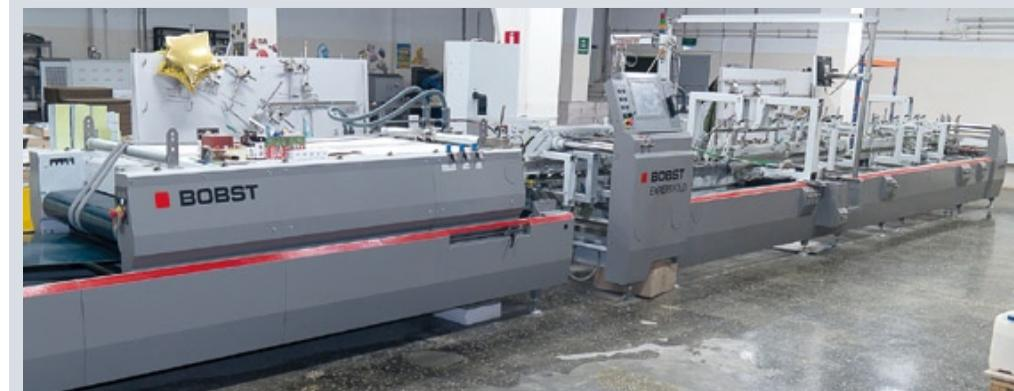
Часть производственного комплекса для изготовления картонной упаковки: автоматический пресс для высечки Sanwa TRP-1060\_SVB Exceli с секциями удаления облоя, разделения заготовок, биговки и холодного тиснения, а также фальцевально-склеивающая линия Bobst Expertfold 110 A2
