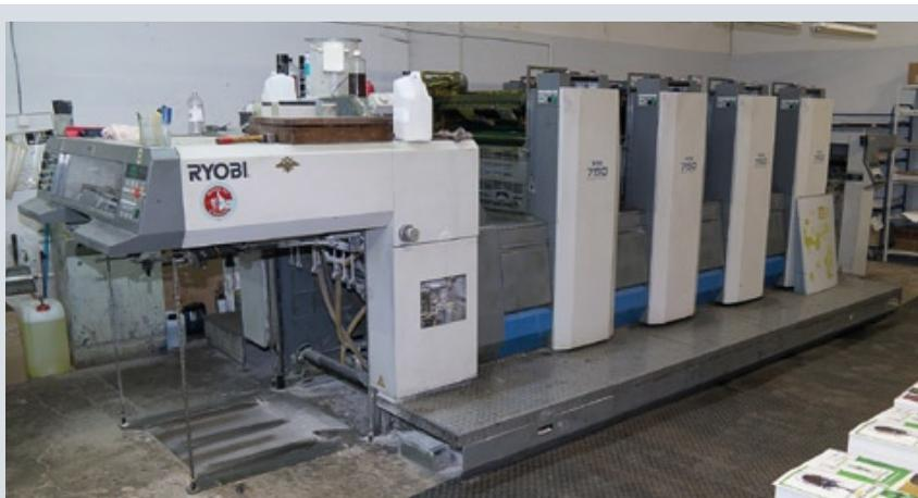
Основу офсетного парка типографии «Копир» составляют печатные машины Ryobi. На четырехкрасочную Ryobi 750 ложится основная загрузка по офсетным заказам
