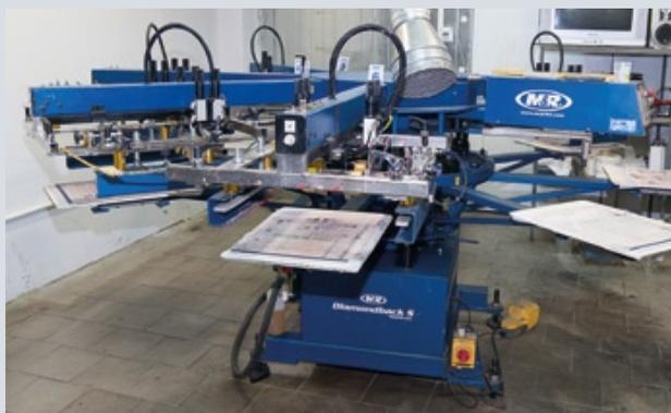
Типография «Копир» обладает разносторонними возможностями как в плане способов печати, так и послепечатной отделки. На фото: линия трафаретной печати для декорирования оттисков и карусель для печати по текстилю
