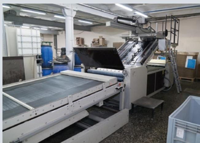
Собственная кашировальная линия Stock 1250P для изготовления микрофрокартона и переплетного картонна
