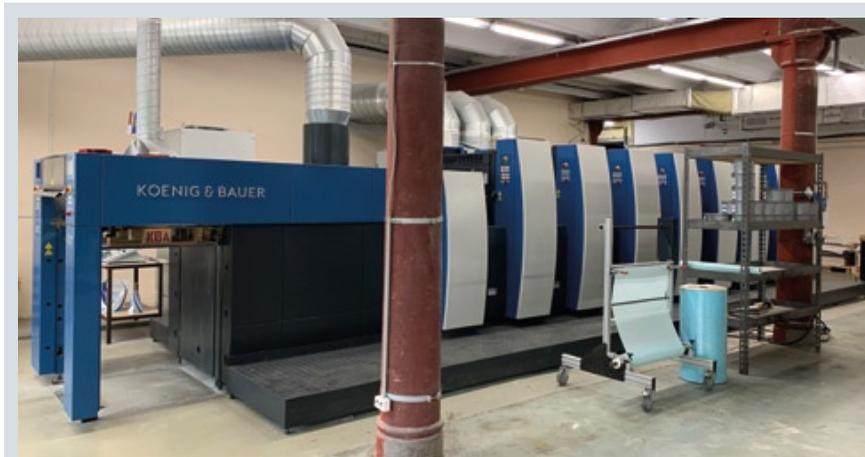
Полуформатная машина Rapida 75 PRO-6+L SAPC ALV2 в шестикрасочном исполнении с секцией лакирования. Благодаря установке двух машин Koenig & Bauer разного формата типография «Диана» получила возможность более гибко выстраивать производственный процесс, обеспечивать стабильность и соблюдение коротких сроков изготовления тиражей
