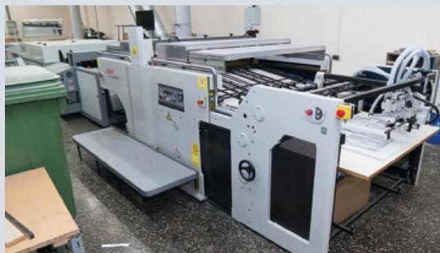
Трафаретная линия для отделки различными видами лака
