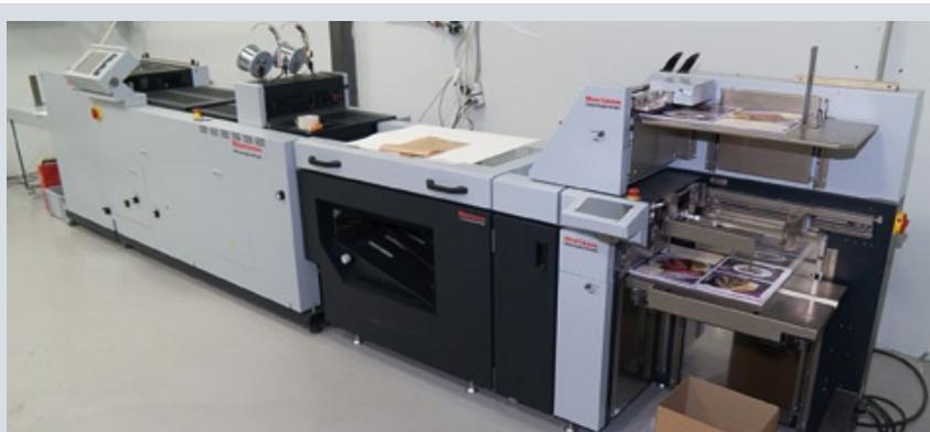
В «Типографском комплексе «Девиз» компания «Терра Принт» установила брошюровочный комплекс Horizon для изготовления продукции на скосе. Оборудование оснащено модулем подачи обложек CF-400. Кроме того, устройство подачи цифровых оттисков Horizon HOF-400 позволяет работать со стопой отпечатанных в подбор блоков и выполнять поэкземплярное разделение изданий
