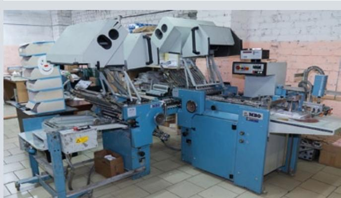
*Часть послепечатного оборудования для производства многополосной полиграфии — листоподборочный комплекс с модулем шитья на скобу, машина клеевого бесшвейного скрепления, фальцевальная линия*
