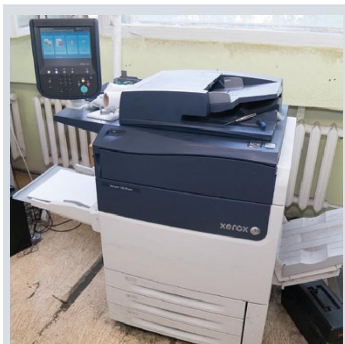
В «ИД Меркурий» дооснастили ЦППМ Xerox Versant 180 Press новым модулем Xerox Adaptive CMYK Plus с дополнительными цветами. Теперь у типографии есть возможность наносить прозрачный тонер, белила, «серебро» и «золото»
